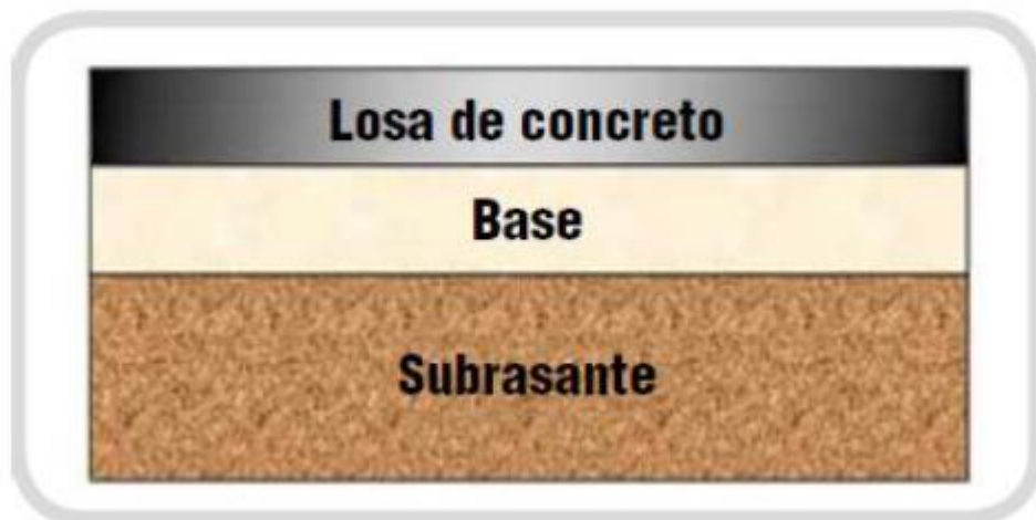
Figura 7- Estructura de un pavimento rígido.
