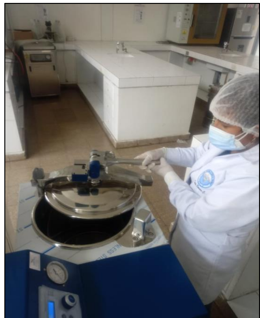
Esterilización de los tubos con Caldo Brila
