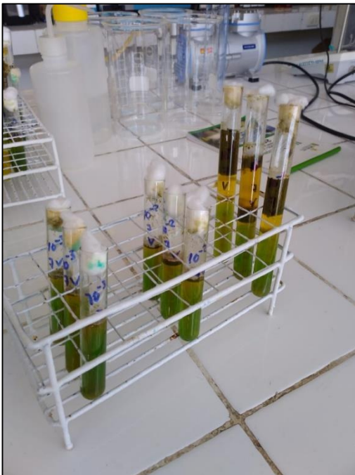
Identificación bioquímica de E. coli mediante la prueba TSI y citrato en muestras de culantro
