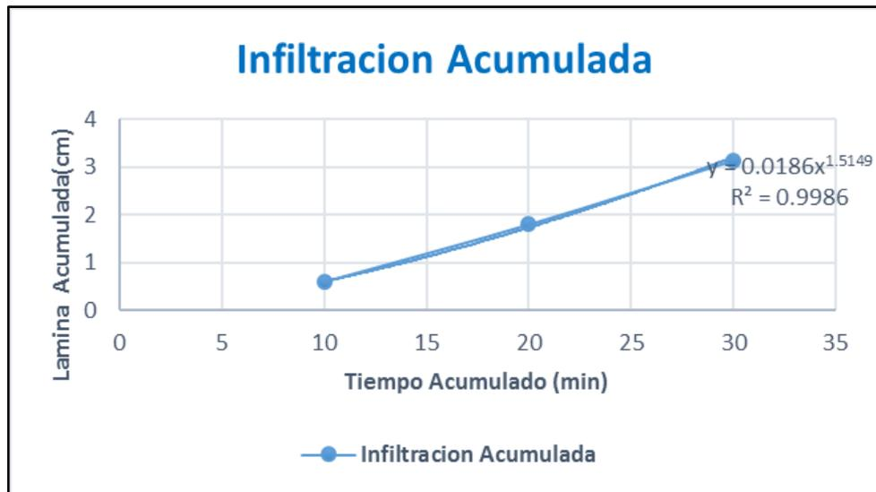
**Figura 20** Infiltración acumulada del pozo N°4
