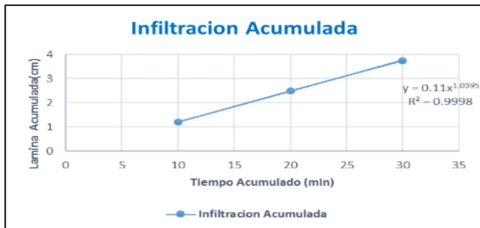
**Figura 18** Infiltración acumulada del pozo N°2
