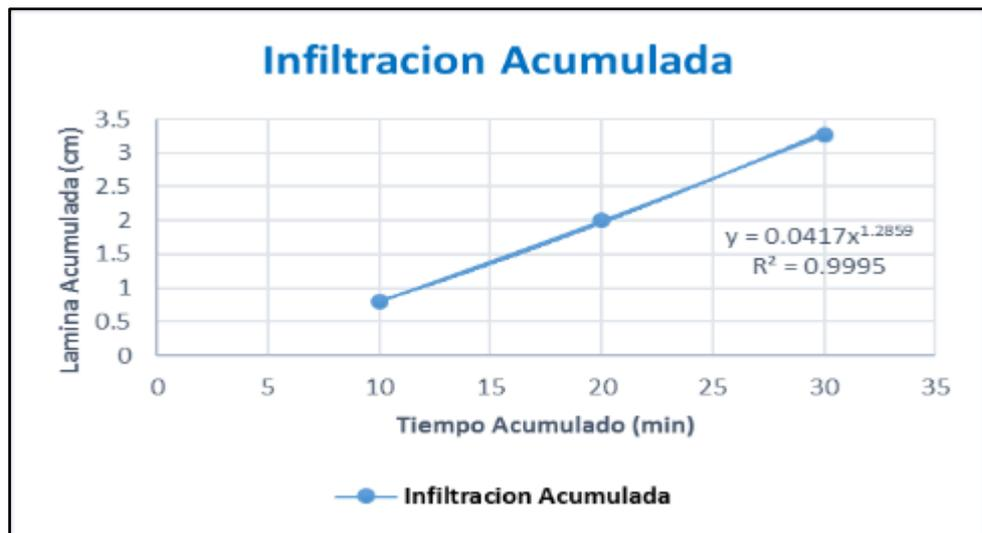
**Figura 17** Infiltración acumulada del pozo N°1
