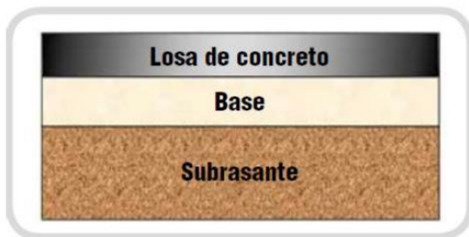
Figura 7- Estructura de un pavimento rígido.
