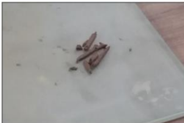
Figura 11. Tipo de desmoronamiento del suelo arcilloso - Límite líquido Fuente: Elaboración propia
