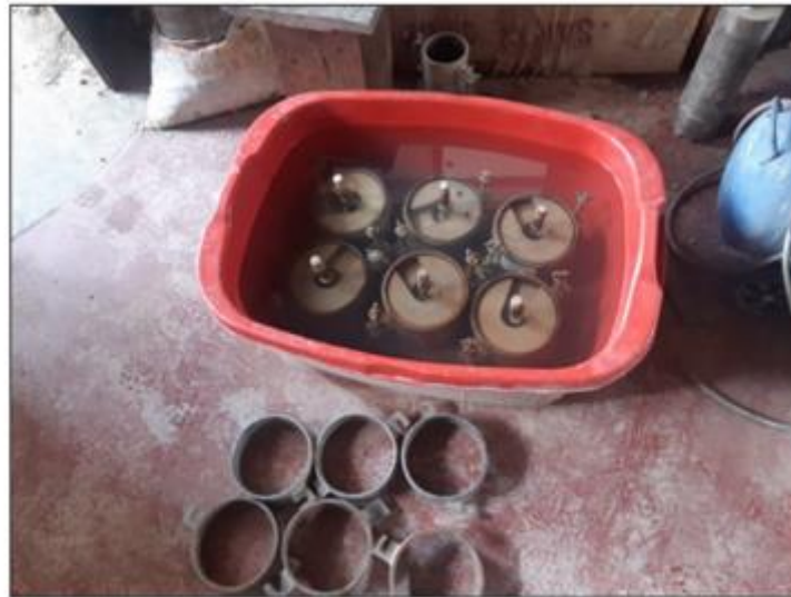
Figura 13. Muestras sumergidas en agua - Ensayo de CBR en laboratorio Fuente: Elaboración propia
