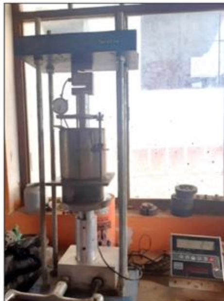
Figura 14. Equipo de prueba de carga - Ensayo de CBR en laboratorio Fuente: Elaboración propia
