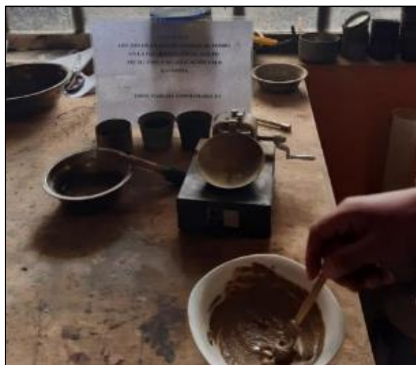
Figura 9. Preparación del material - Límite líquido Fuente: Elaboración propia
