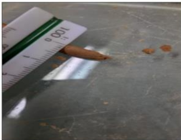
Figura 10. Hilo de suelo arcilloso - Límite líquido Fuente: Elaboración propia
