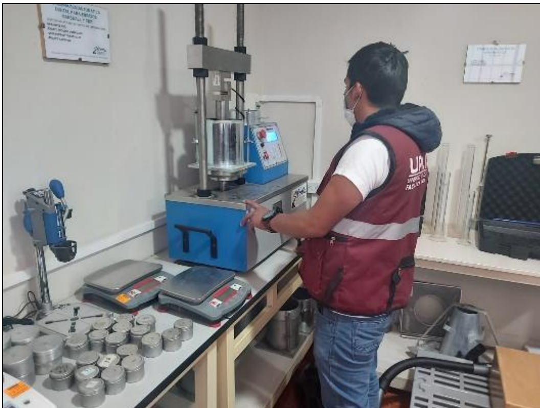
Fotografía 10. Ejecución del ensayo de CBR.
