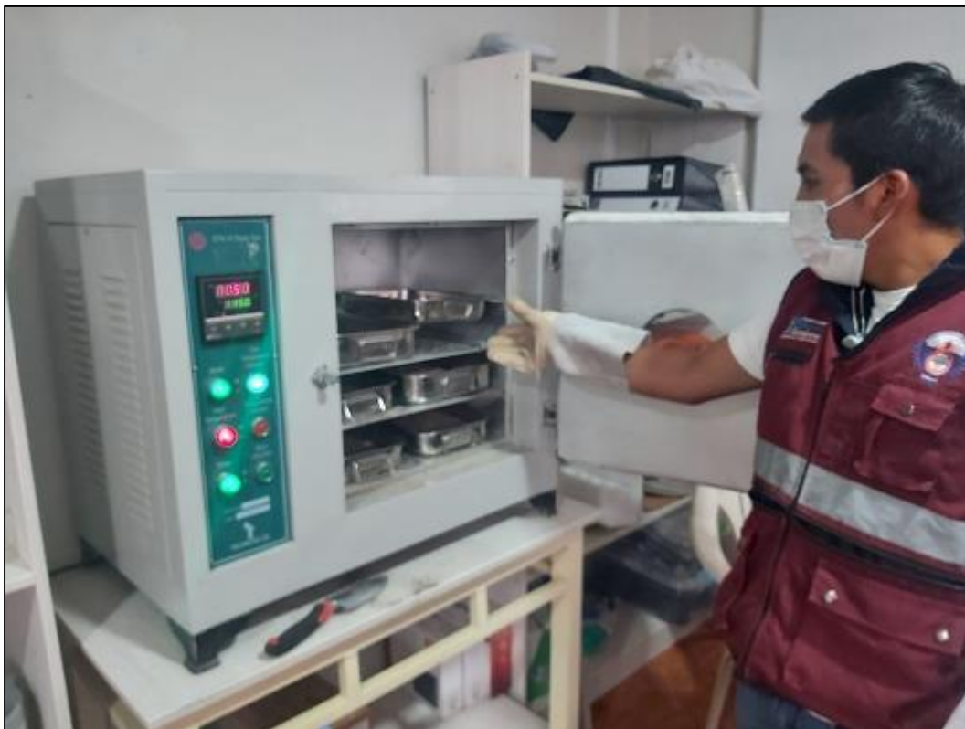
Fotografía 8. Colocación de las muestras de suelos en el horno.
