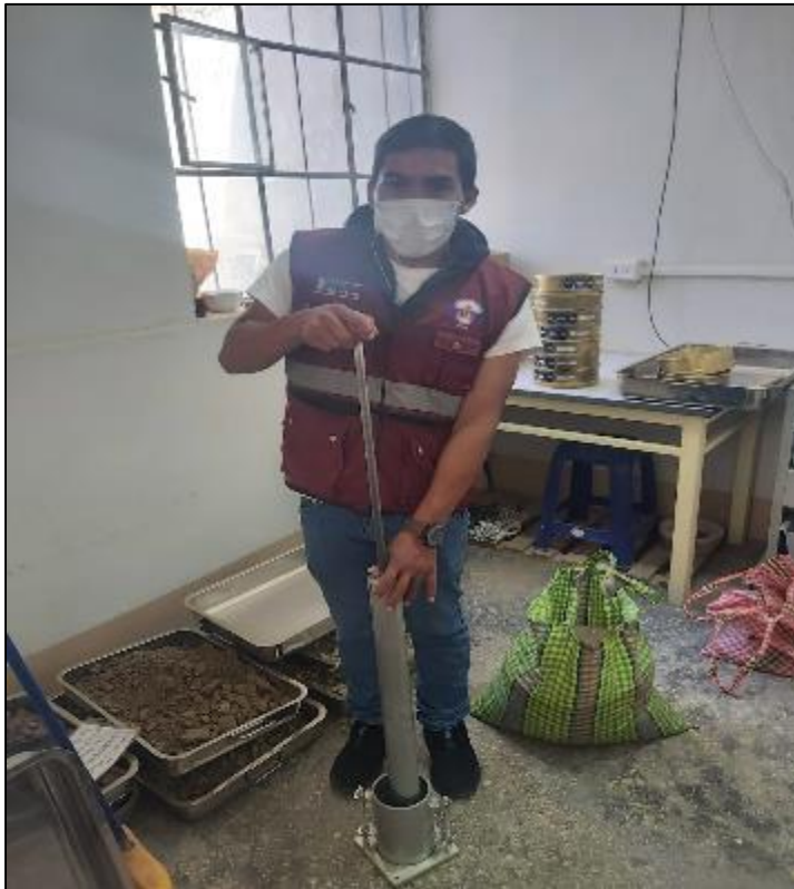
Fotografía 9. Ejecución del ensayo Proctor.
