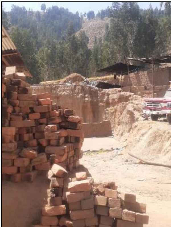
Fotografía 5. Vista de los ladrillos pasados de cocción y descartados para la venta.
