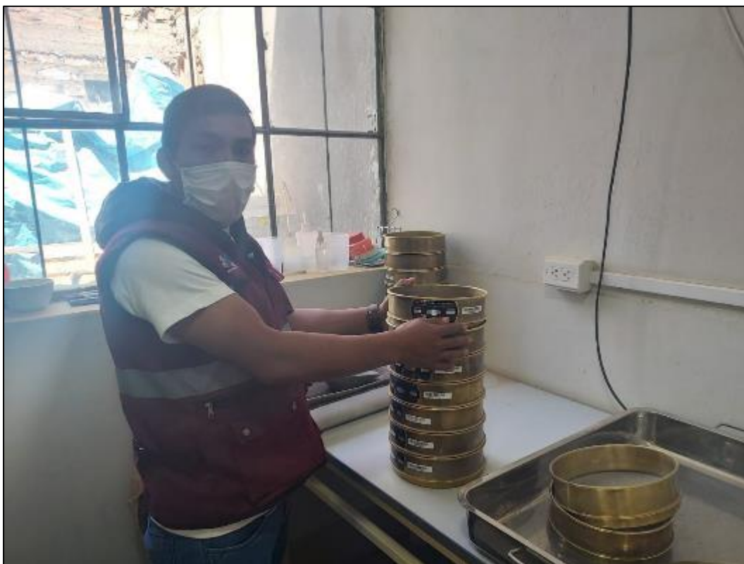
Fotografía 6. Análisis granulométrico de las muestras de suelo.
