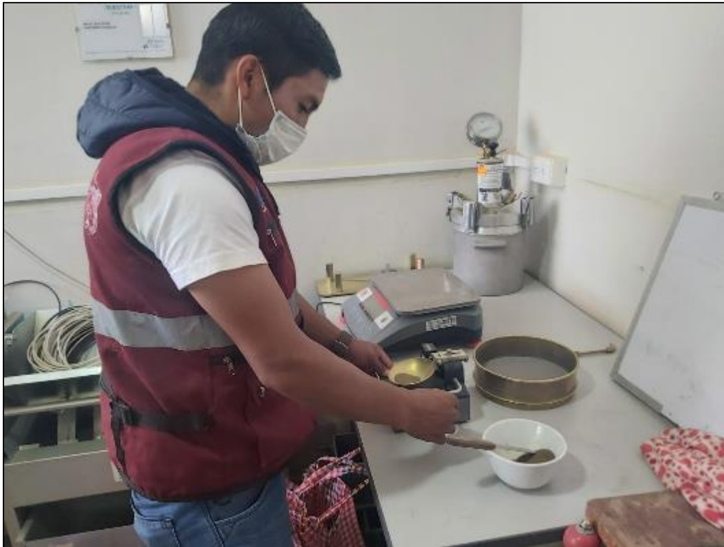
Fotografía 7. Realización del ensayo para la determinación del límite líquido del suelo.
