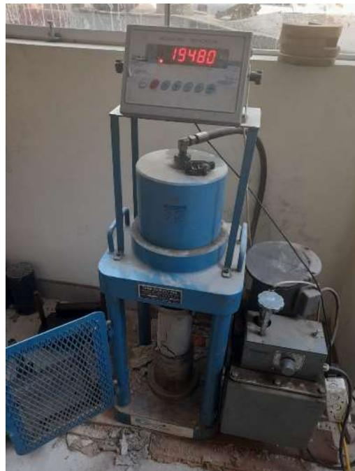
**Foto 12.** (16/04/2021). ASTM C39. Una vez concluido el curado se realiza la rotura a la compresión de la dosis II y III para conocer la resistencia del concreto a los 7 días, 14 días, 21 días y 28 días.
