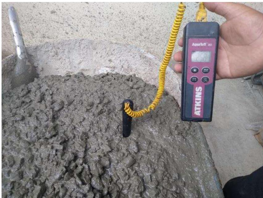
*Figura 18. Medición de la temperatura del concreto*
