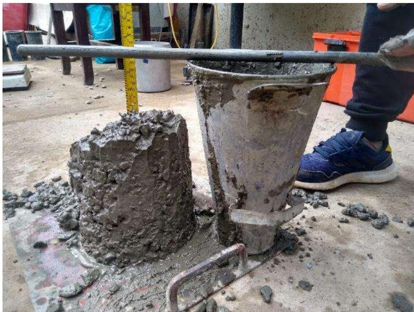
*Figura 17. Medición del asentamiento de la mezcla*
