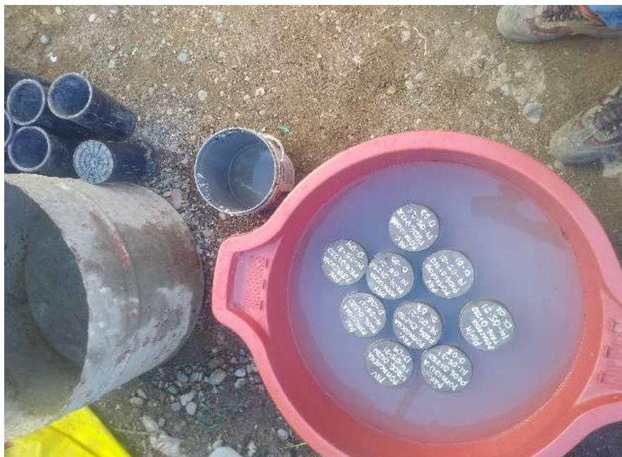
**Foto 10.** (14/05/2021). ASTM C31. Se realizo el curado de los testigos que fueron realizados y tomados en la obra de la Localidad de Pomacochacha, ubicado en el Distrito de Yauli – La Oroya,
