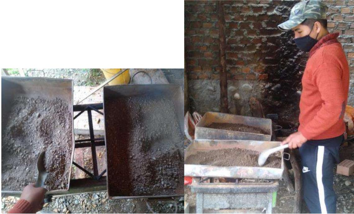
**Foto 01.** (13/04/2021) – NTP 400.012. Secado de agregado fino (arena gruesa) y agregado grueso (piedra chancada) para el ensayo de contenido de humedad y posterior ensayo de granulometría
