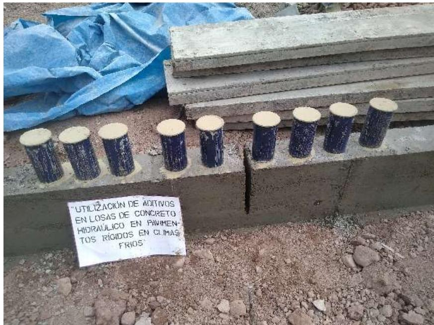
**Foto 06.** (14/05/2021) – ASTM C39. Se sacan unas muestras representativas de la dosis II para su posterior curado y ser llevados a su rotura de concreto a la compresión a los 7, 14, 21, y 28 días
