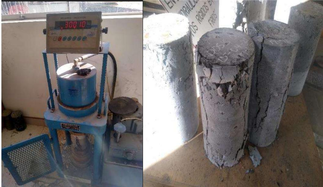
*Figura 26. Rotura de testigos - resistencia a la compresión a los 7, 14, 21, y 28 días*
