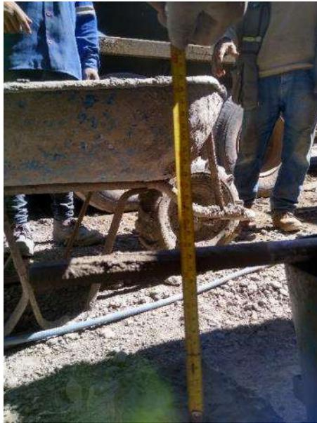
*Figura 34. Asentamiento del concreto en planta*
