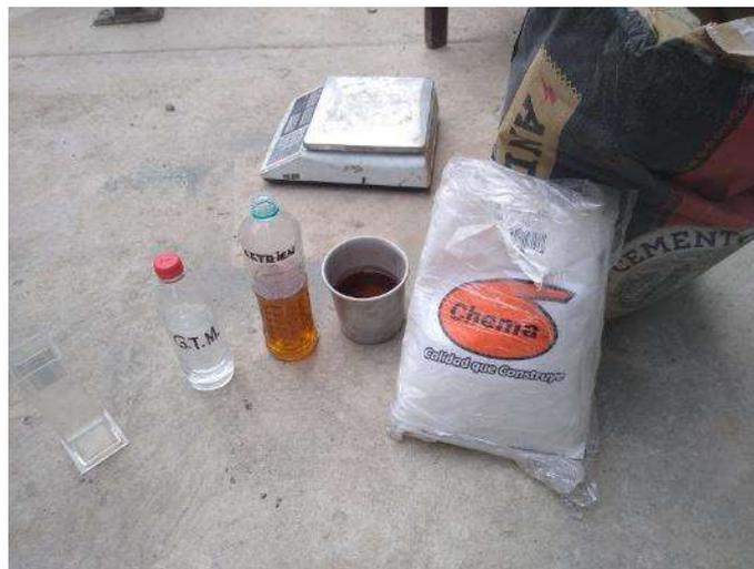
*Figura 10. Aditivos utilizados para los diseños de mezcla*
