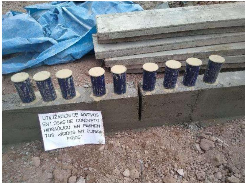
*Figura 37. testigos de concreto - dosis II sacado en obra*
