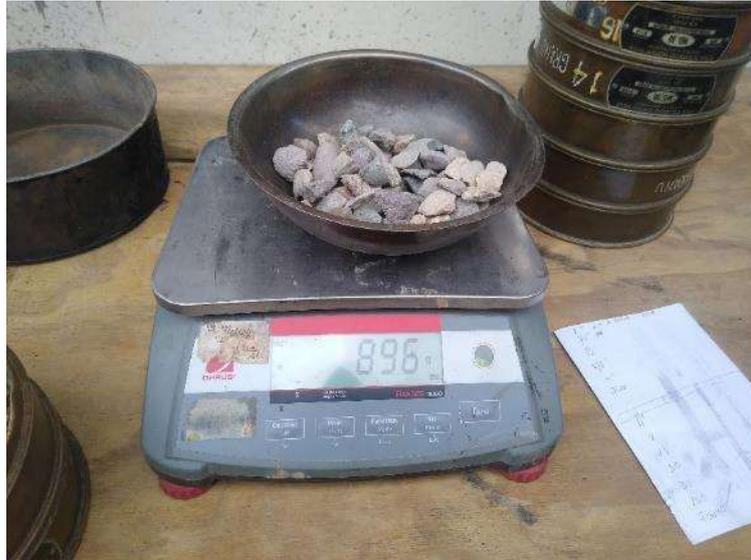
Figura 15. Tamizado y pesaje del agregado grueso
