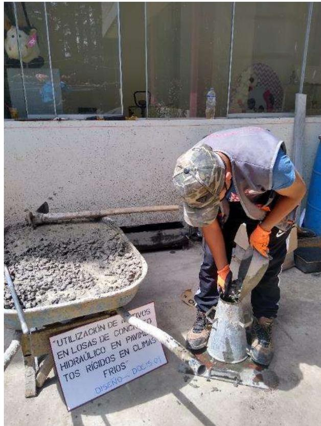
*Figura 16. Ensayo de cono de Abrams*
