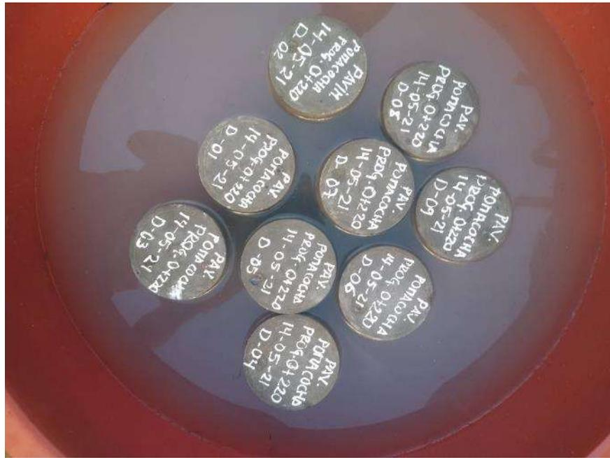
*Figura 38. Curado de los testigos de concreto*
