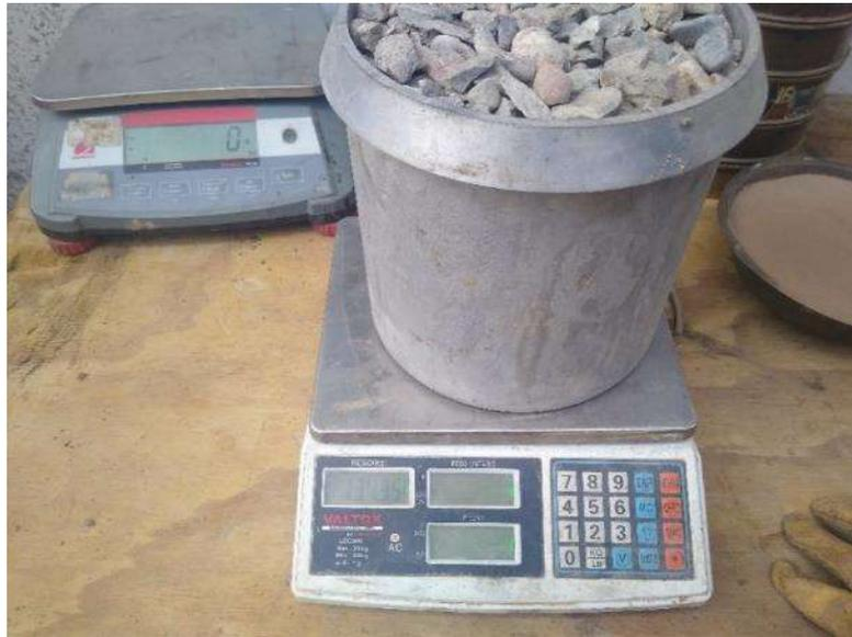
*Figura 12. peso del agregado grueso sin compactar*
