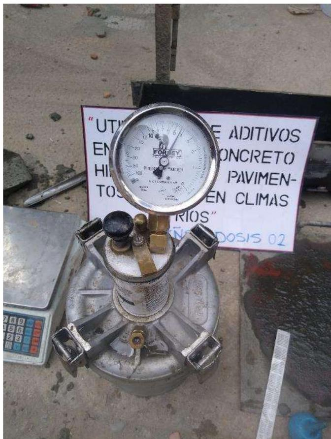
Figura 23. Lectura del manómetro de contenido de aire
