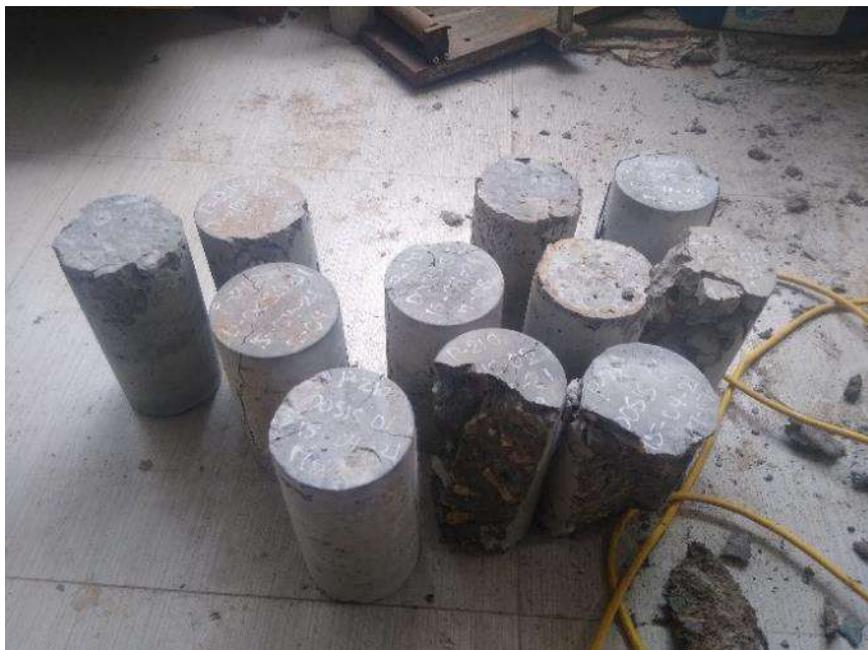
**Foto 14.** (12/05/2021). Después de realizar las roturas se puede apreciar falla tipo II (conos bien formados en un extremo, fisuras verticales a través de los cabezales) y tipo III (fisuras verticales encolumnadas en ambos extremos) que dichos testigos que fueron sometidos a la compresión.
