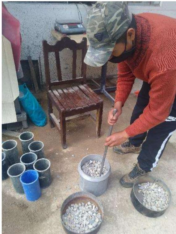
*Figura 14. Peso del agregado grueso compactado*
