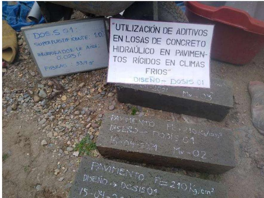
Figura 28. Plantillado de testigos tipo viga
