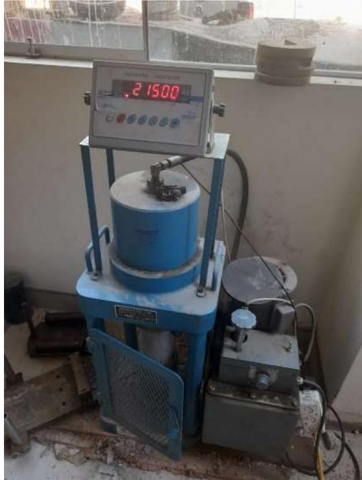
**Foto 11.** (15/04/2021). ASTM C39. Una vez concluido el curado se realiza la rotura a la compresión de la dosis I para conocer la resistencia del concreto a los 7 días, 14 días, 21 días y 28 días.
