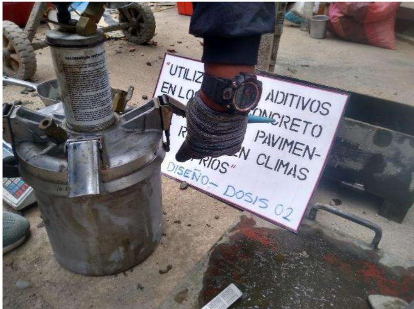
Figura 22. Sellado de la olla Washington e incorporación de agua
