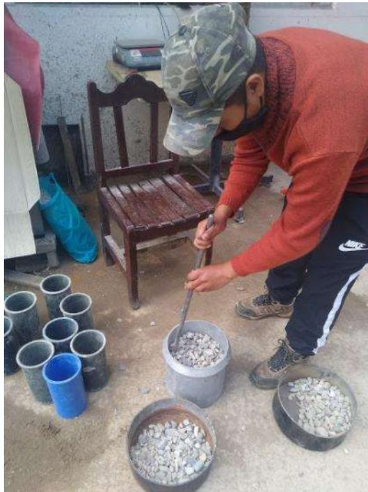
**Foto 02.** (14/04/2021) – NTP 339.046. Se realiza el ensayo de peso unitario de los agregados de la piedra chancada y arena gruesa, estos datos serán usados para el diseño de mezcla
