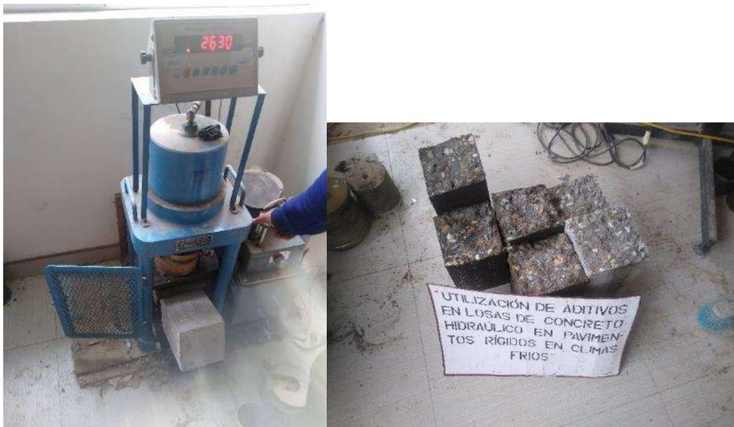
Figura 29. Rotura de testigo tipo viga - resistencia a la tracción en los 7, 14, 21, y 28 días
