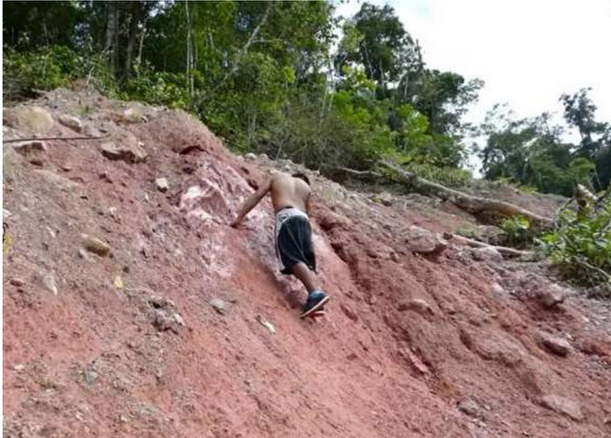
En la presente muestra la cantera de NaCl, el cual se pretende utilizar para estabilizar los tramos de suelo arenoso que existen en la carretera.
