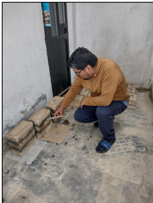
Figura 31. Curado de juntas
