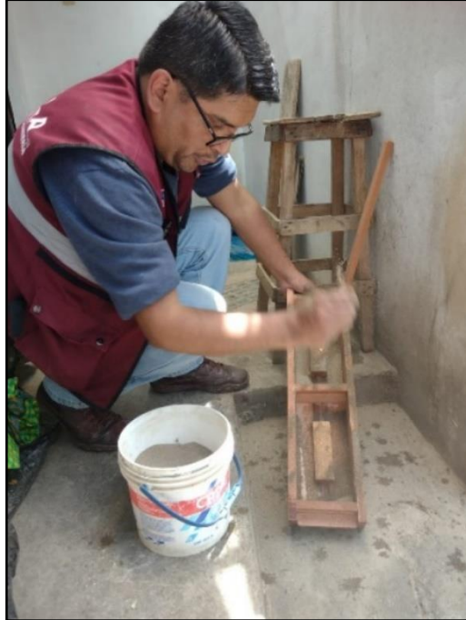
Figura 18. Adición de arena al molde
