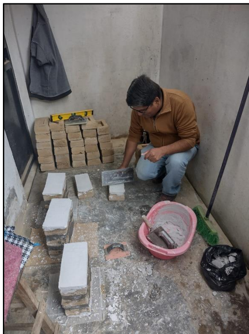
Figura 40. Refrentado de espécimen
