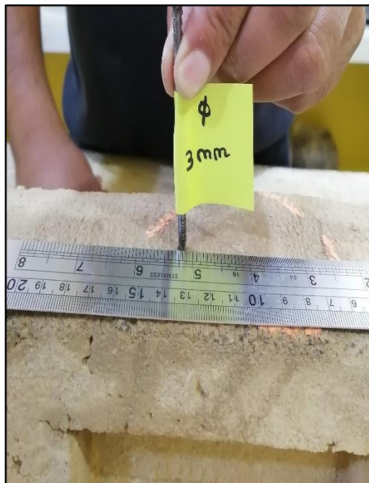
Figura 37. Verificación de la oquedad
