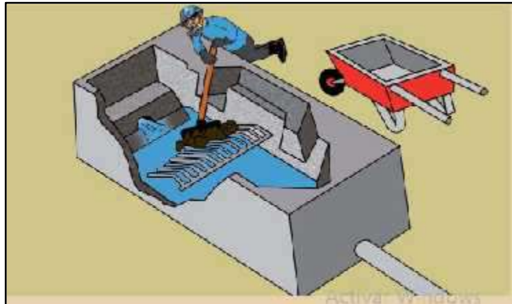
Ilustración 28.- Mantenimiento de los desarenadores
