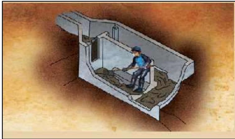
Ilustración 30.- Mantenimiento de los desarenadores
