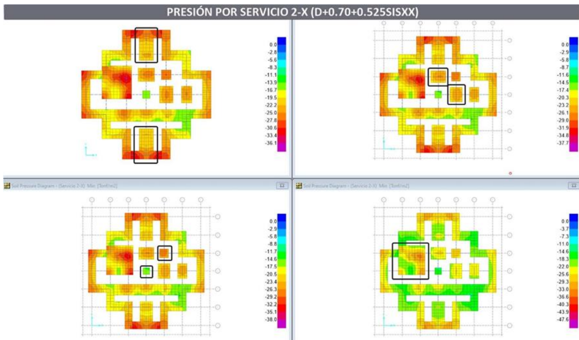
Figura 77 – Presión – Servicio 2-X (D+0.70L+0.525SX) / Qadm = [27.10, 28.30, 28.50, 35.70]*4/3 Tonf/m2.
