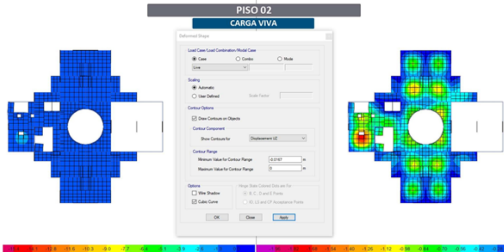
Figura 52 – Deflexión por carga viva / piso 02.
