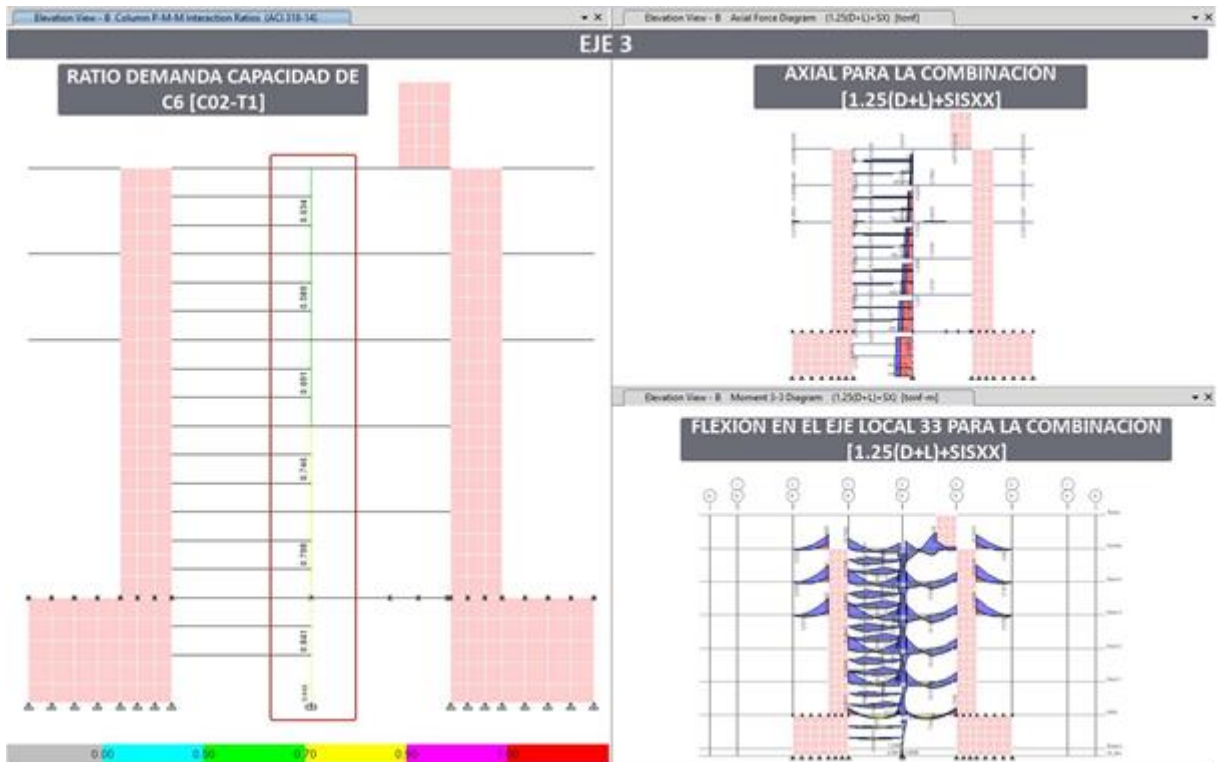
Figura 44- Ratio demanda capacidad - Axial /M33 para una combinación Columna a verificar [C6-71 / C02-T1].
