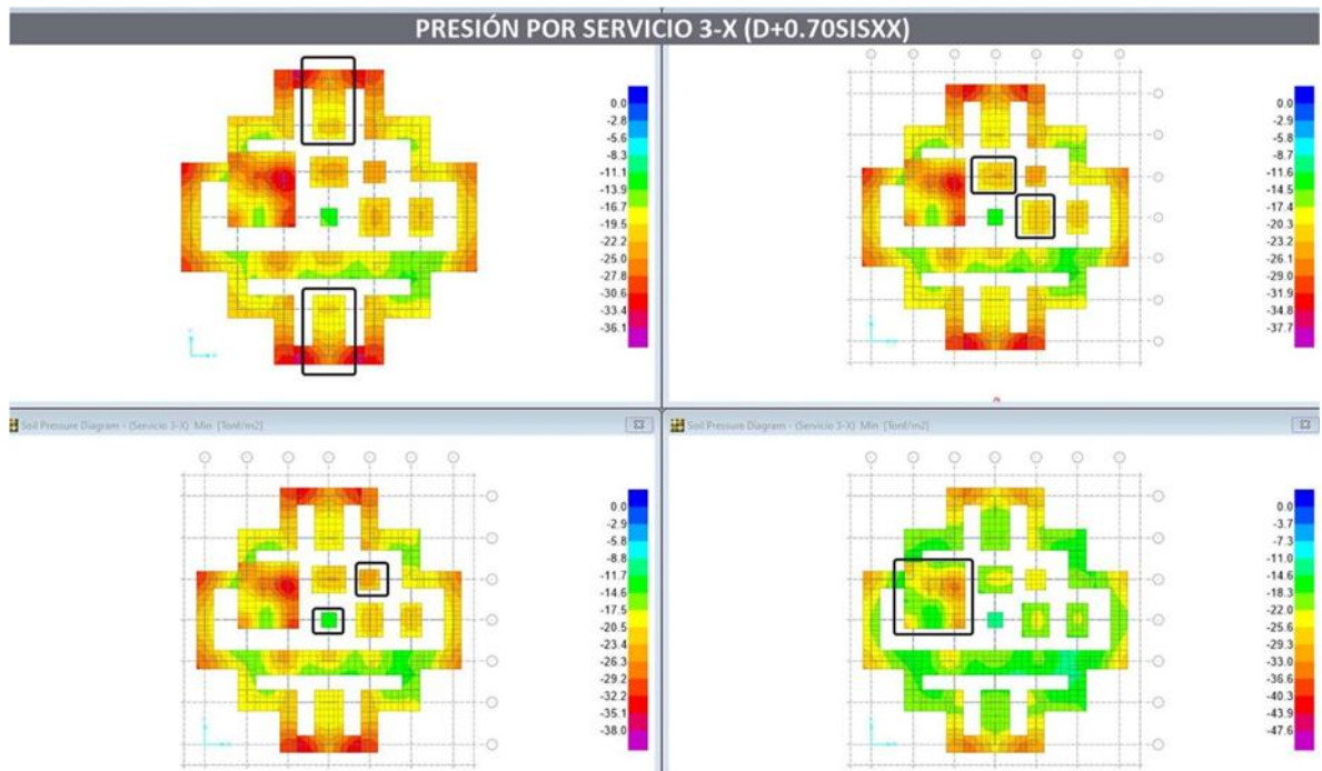
Figura 81 – Presión – Servicio 3-X (D+0.70SX) / Qadm = [27.10, 28.30, 28.50, 35.70]*4/3 Tonf/m2.
