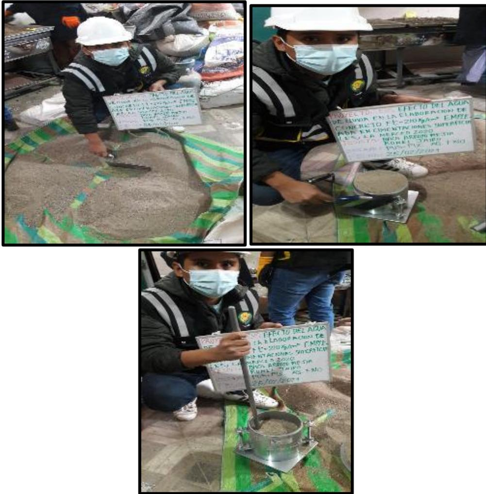
**Fotografía 5, fotografía 6 y fotografía 7:** Realización del ensayo para determinar la masa por unidad de volumen (peso unitario suelto y compactado) y vacíos en el agregado grueso y fino según la NTP 400.017.
