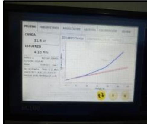
**Fotografía 44 y fotografía 45:** Resultados arrojados por el equipo de compresión de la viga después de ser roturada
