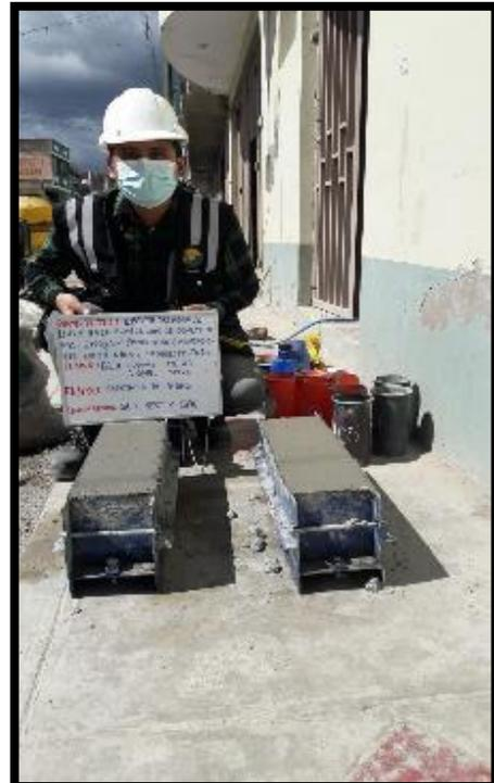
**Fotografía 26 y fotografía 27:** Elaboración de cilindros y vigas de concreto con aguas tratadas de biodigestores (NTP 339.183).
