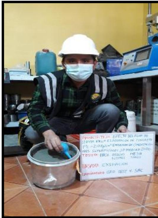
**Fotografía 25:** Determinar la cantidad relativa de agua que exuda la muestra fresca de concreto según NTP 339.077.
