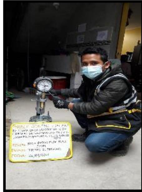
**Fotografía 17 y fotografía 18:** Vista del ensayo para la determinación del tiempo de fraguado de mezcla por medio de su resistencia a la penetración, desviación respecto al control según la NTP 339.082.
