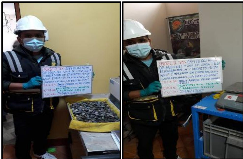
**Fotografía 3 y fotografía 4:** Realización del ensayo para determinar la gravedad específica y absorción del agregado grueso según la NTP 400.021.
