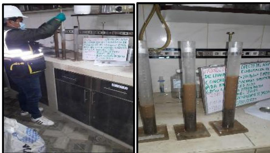
**Fotografía 8 y fotografía 9:** Realización del ensayo estándar que especifica un valor mínimo del equivalente de arena para limitar la cantidad permisible de finos arcillosos en los agregados según la NTP 339.146.
