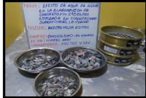
**Fotografía 12 y fotografía 13:** Ensayo de durabilidad del agregado grueso según la NTP 400.016, se observa el agregado grueso de TMN (3/4", 1/2" y 3/8") 100 gramos, esto es sumergido en el sulfato de magnesio por 16 horas en un ambiente normal para luego ser puesto en el horno por 3 – 4 horas.
