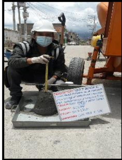
**Fotografía 21 y fotografía 22:** Permite establecer el método de ensayo para medición del asentamiento del concreto del cemento portland según NTP 339.035.
