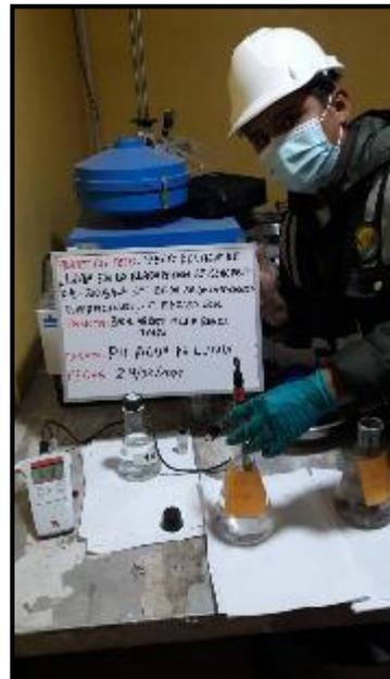
**Fotografía 15 y Fotografía 16:** Determinar del Agua de Lluvia el valor pH. de La Merced. Según ITINTEC 339.088
