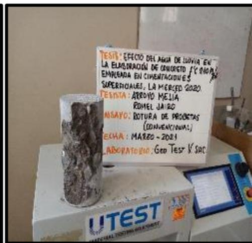
**Fotografía 32 y fotografía 33:** Testigo cilíndrico N°6 con sus fallas respectivas NTP 339.034 / ASTM C39
