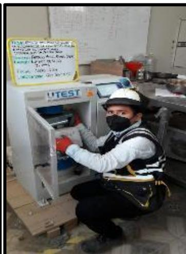
**Fotografía 50 y fotografía 51:** Resultados obtenidos por el equipo de compresión de la viga roturada con agua de lluvia según NTP 339.078.
