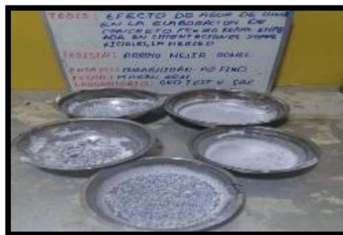
**Fotografía 14:** nos muestra el contacto entre el agua destilada y el agregado fino por unas 16 horas, para luego retirarlo y poner los recipientes en el horno de 3-4 horas, este ciclo lo repetimos por 5 ciclo, para finalmente lavarlo y llevarlo por último el horno antes de tamizarlo. NTP 400.016.
