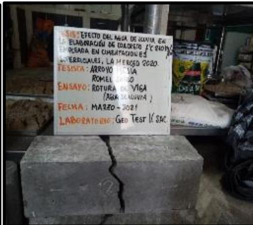
**Fotografía 46, fotografía 47, fotografía 48 y fotografía 49:** Resultados del ensayo a flexión de vigas de concreto a los 28 días según NTP 339.078 (AGUA DE LLUVIA)
