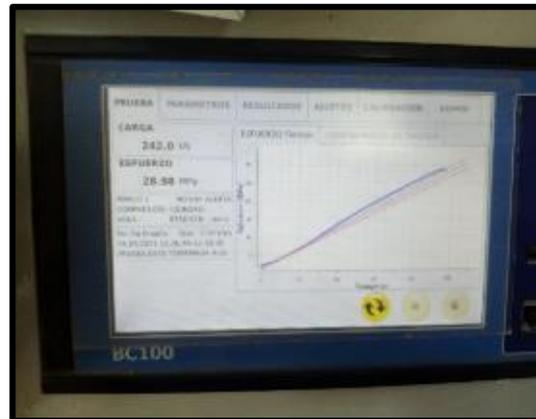
**Fotografía 28, fotografía 29, fotografía 30 y fotografía 31:** Ensayo de resistencia a compresión de probetas de concreto patrón a los 7 días de edad según la NTP 339.034
