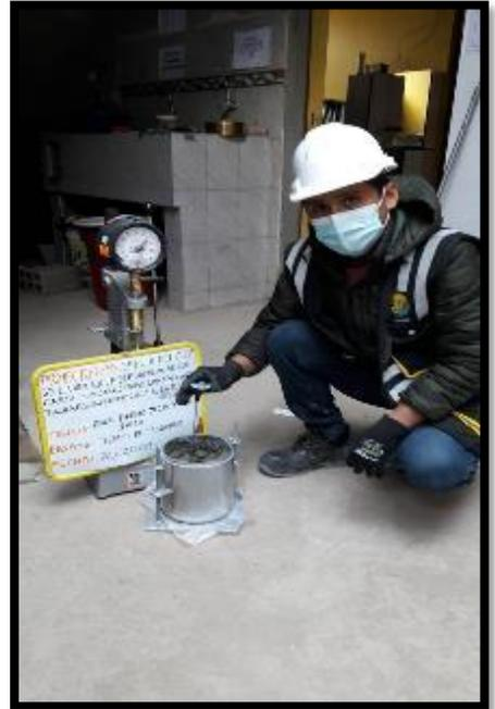
**Fotografía 19 y fotografía 20:** Permite determinar y verificar la conformidad con un requerimiento especificado para la temperatura de mezclado de concreto según NTP 339.184.
