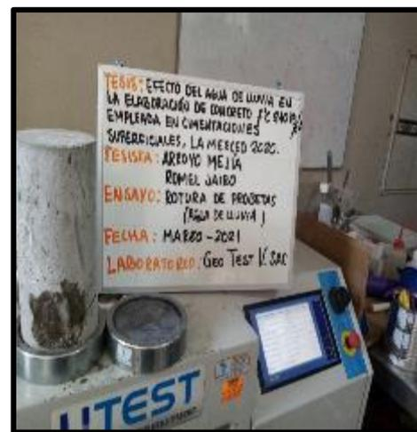
**Fotografía 38 y fotografía 39: Testigo cilíndrico con agua de lluvia con sus fallas respectivas NTP 339.034 / ASTM C39**
