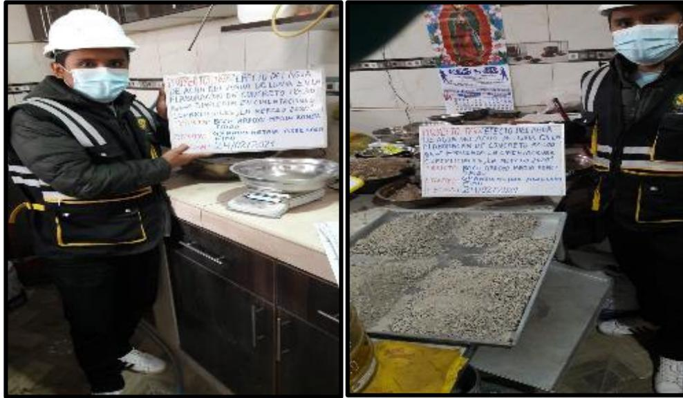
**Fotografía 1 y Fotografía 2:** Ensayo de granulometría del agregado fino y grueso de acuerdo a la NTP 400.012.
