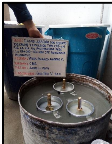
Fotografía N°17, Fotografía N° 18: Sumergido de los moldes por 96 horas siendo medido la expansión cada 24 horas. Según la NTP 339.175:2002.
