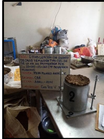
Fotografía N°16: Desmoldado y enrasado según la NTP 339.175:2002.
