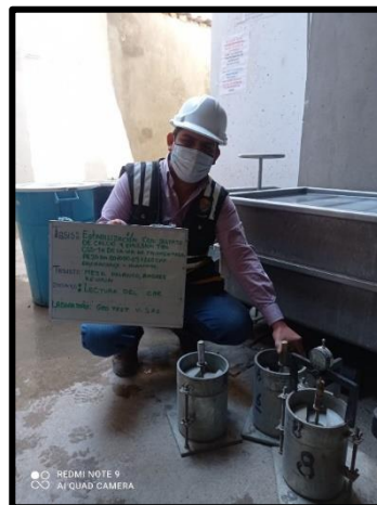
Fotografía N°17, Fotografía N° 18: Sumergido de los moldes por 96 horas siendo medido la expansión cada 24 horas. Según la NTP 339.175:2002.
