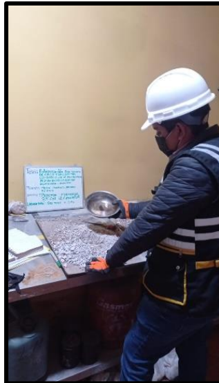
Fotografía N° 45: Pesado de la muestra y molde según NTP 339.175:2002.
