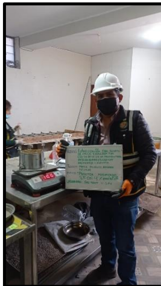
Fotografía N° 45: Pesado de la muestra y molde según NTP 339.175:2002.
