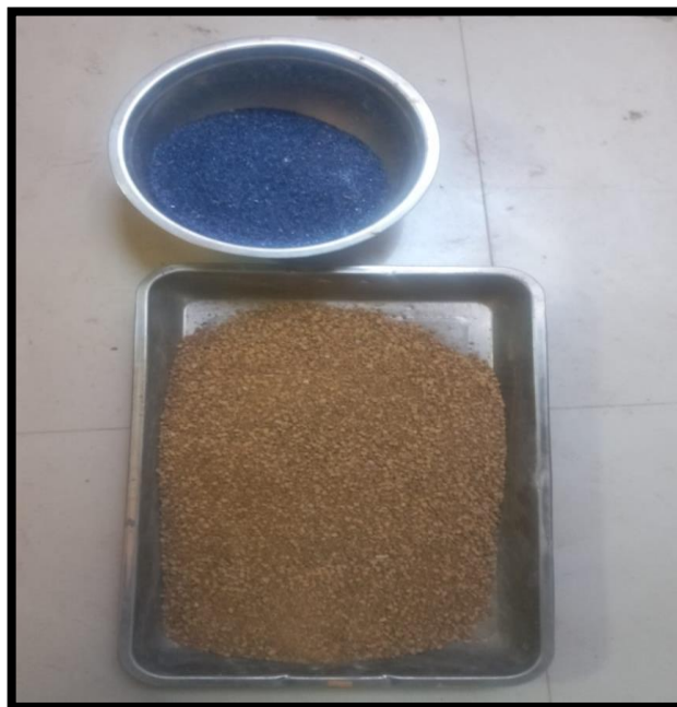
Fotografía 28. Fibras PET más la muestra.
