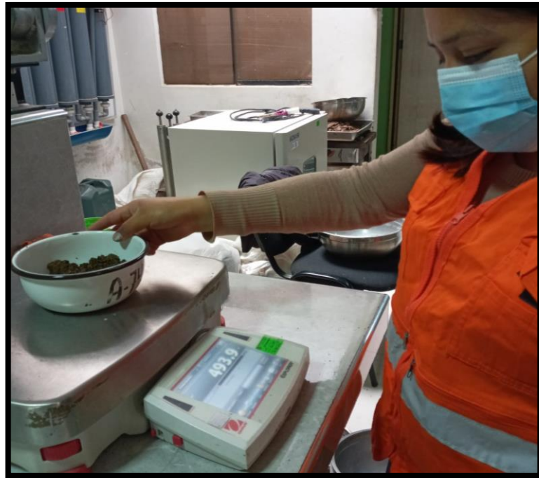
Fotografía 9. Recolección de muestra para determinar el porcentaje de humedad.
