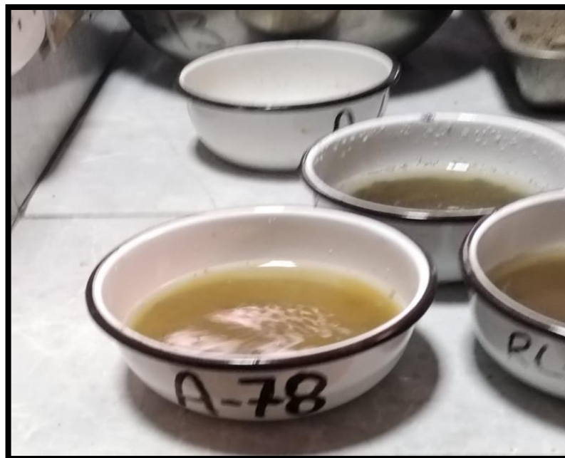
Fotografía 10. Lavado de la muestra
