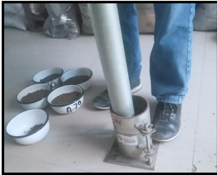
Fotografía 31. Compactación de la mezcla de fibras PET y la arcilla.
