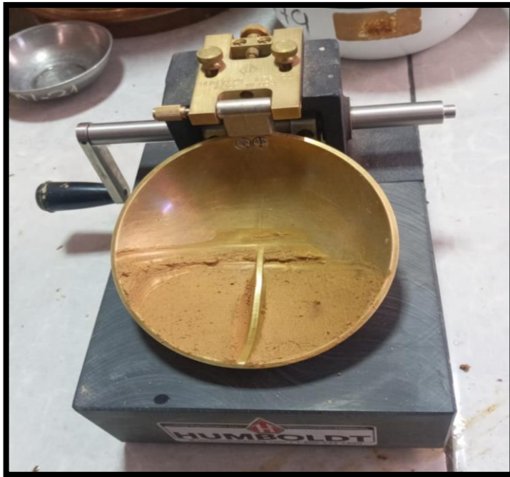
Fotografía 17. Muestra antes de accionar la cazuela.
