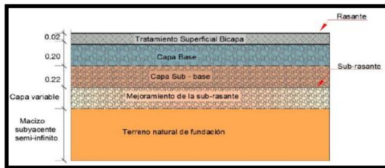
Figura N°3: Sector Transversal del Pavimento Flexible
