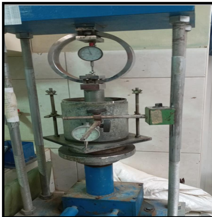
Fotografía 26. Ensayo de CBR.
