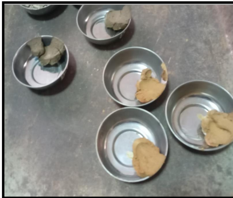
Fotografía 18. Recolección de muestra para determinar el porcentaje de humedad.
