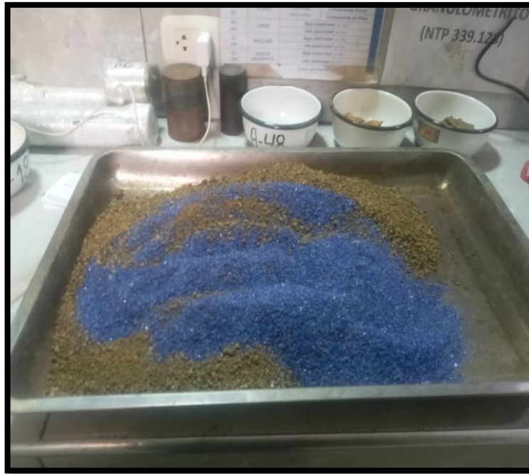
Fotografía 29. Mezcla de la arcilla con la fibra PET.
