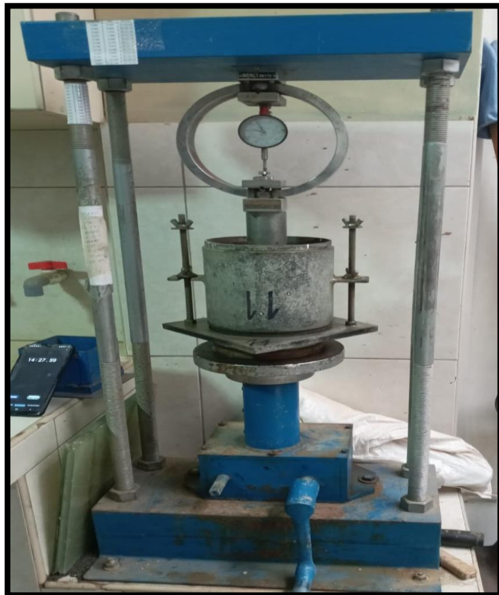
Fotografía 32. Ensayo de CBR de la mezcla de arcilla y fibras PET.
