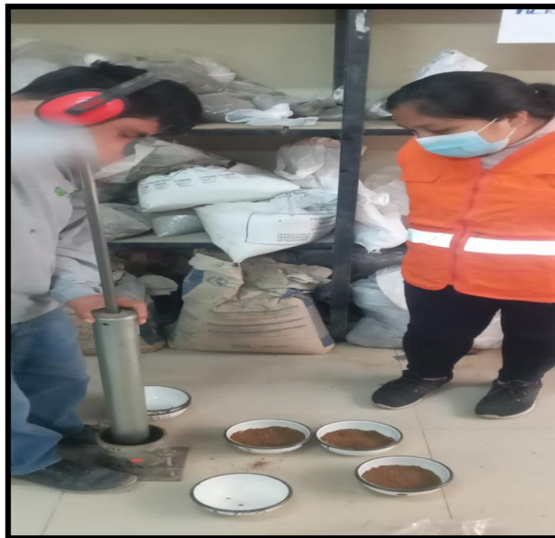
Fotografía 22. Compactación de la muestra.
