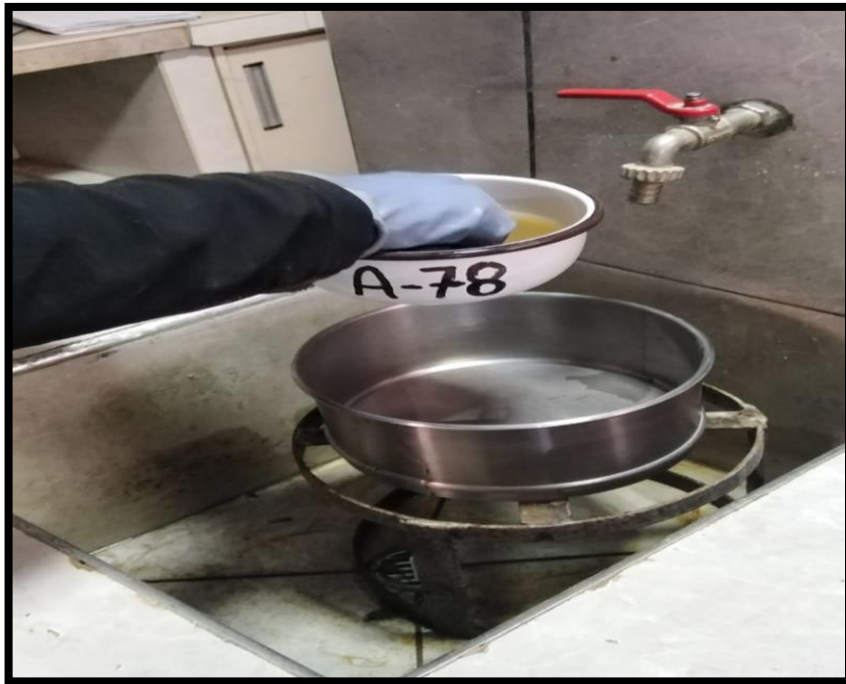
Fotografía 11. Lavado de muestra por la malla N° 200
