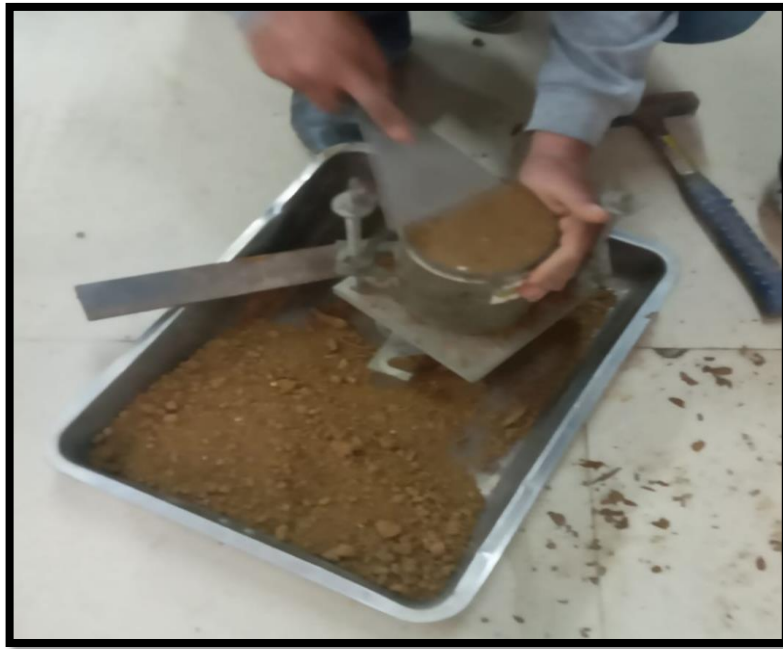
Fotografía 23. Enrasado de muestra compactada.
