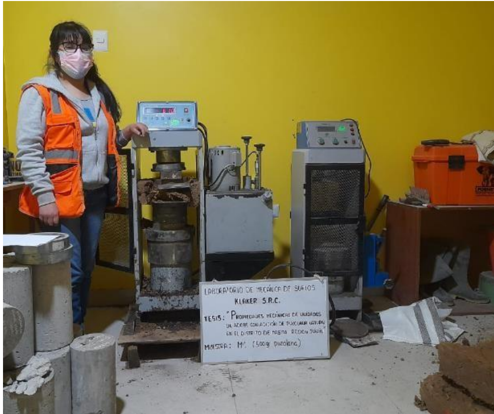
Figura 23. Resistencia a compresión de las muestras de adobe con adición de 500 gr. de puzolana
