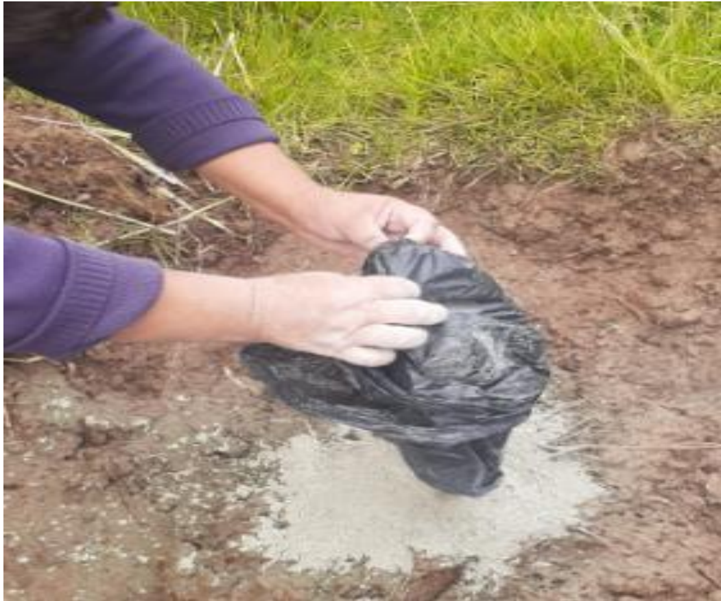
Figura 17. Mezcla del barro + paja + puzolana natural Fuente: Elaboración propia
