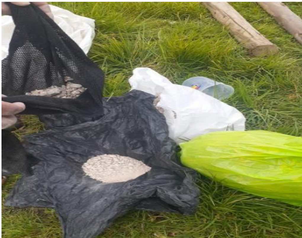
Figura 16. Pozzolana natural, siendo cernida para la eliminación de gravas Fuente: Elaboración propia
