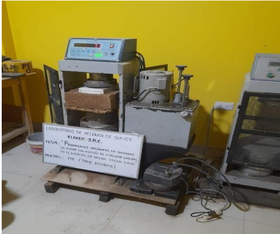
Figura 19. Resistencia a compresión del adobe M1, con adición de puzolana natural
