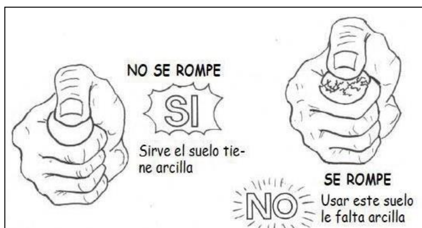
Figura 5. Prueba en campo - Presencia de arcilla Fuente: Norma E.080 – Diseño y Construcción con Tierra Reforzada
