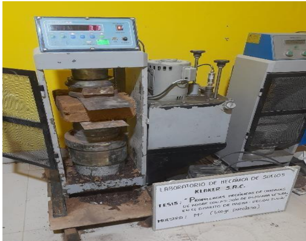
Figura 21. Ensayo de resistencia a la compresión con adición de puzolana 500 gr
