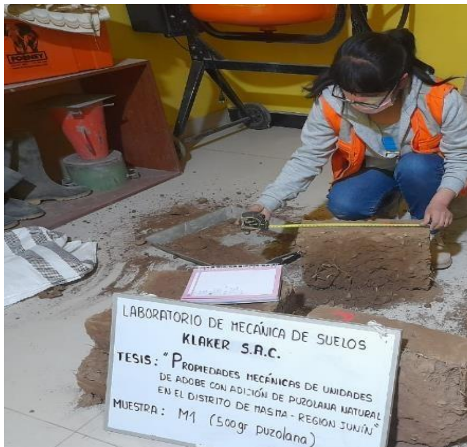
Figura 22. Midiendo la unidad de adobe para proceder a realizar la verificación
