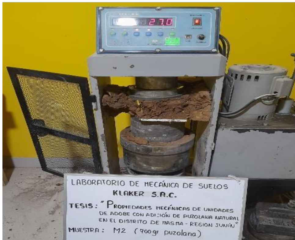
Figura 20. Resistencia a compresión de adobe M2, con adición de puzolana
