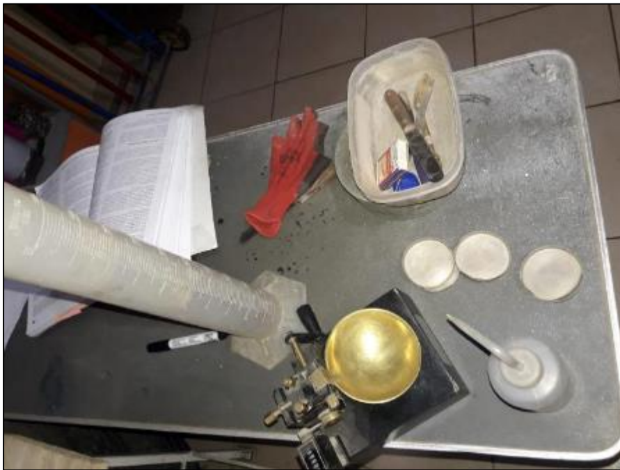
Figura 14. Equipos utilizados para el ensayo de límites de consistencia.
