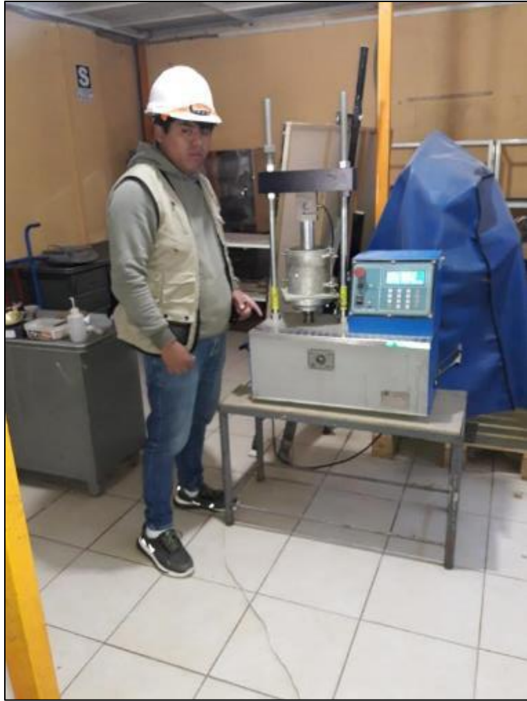
Figura 16 Ensayo de penetración CBR. Fuente: Captura Fotográfica Laboratorio.
