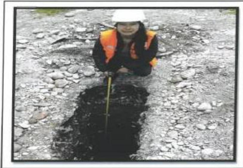
FOTO N° 03: PROFUNDIDAD DE LA CALICATA C-1 A 3.00 m, CORRESPONDIENTE AL PROYECTO: "REFORZAMIENTO CON ENCAMISADO DE CONCRETO ARMADO EN EL COMPORTAMIENTO ESTRUCTURAL DE UNA VIVIENDA MULTIFAMILIAR, DISTRITO DEL TAMBO - HUANCAYO".
