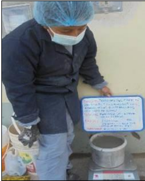
Fotografía 68: Medición de la exudación del concreto con agua subterránea y savia de nopal al 0.70% según la NTP 339.077.
