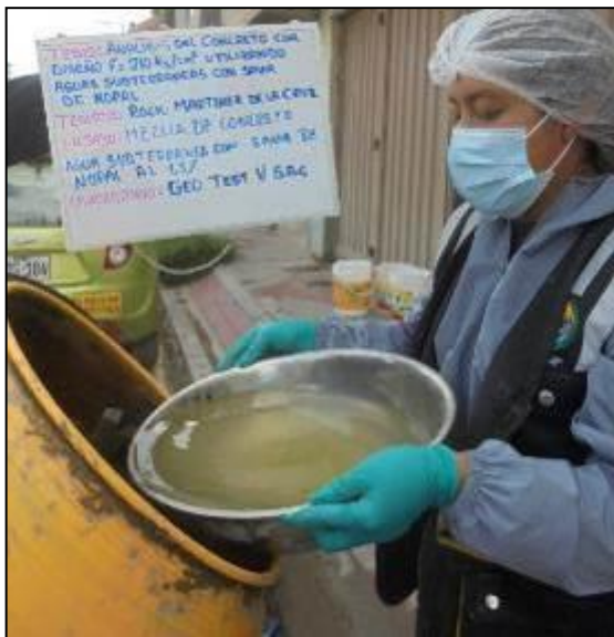
Fotografía 46, Fotografía 47, Fotografía 48 y Fotografía 49: Vista de materiales tales como agregado, savia de nopal al 1.30% (aditivo), agua subterránea y cemento para la elaboración del concreto, según la NTP 339.183.
