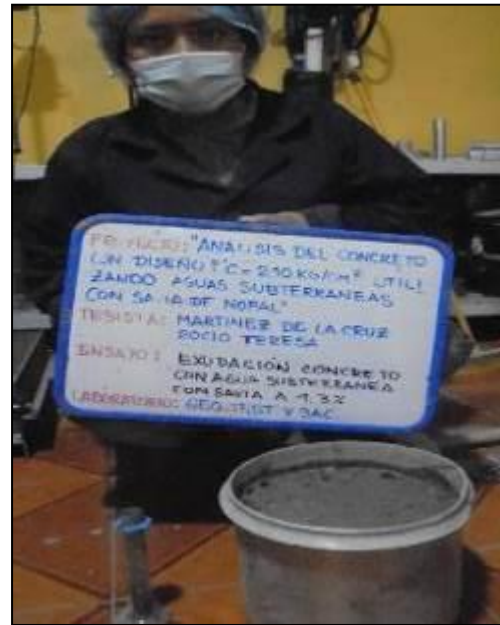
Fotografía 69: Medición de la exudación del concreto con agua subterránea y savia de nopal al 1.30% según la NTP 339.077.
