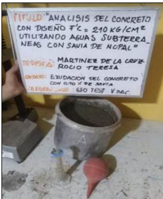
Fotografía 66: Medición de la exudación del concreto con agua subterránea y savia de nopal al 0.10% según la NTP 339.077.
