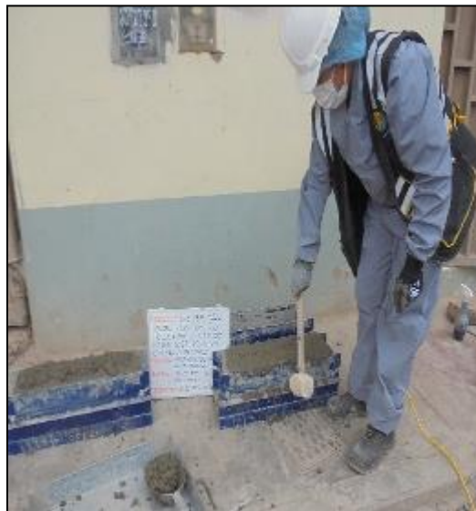
Fotografía 22. Elaboracion de vigas del concreto patron con agua subterranea según NTP. 339.183.
