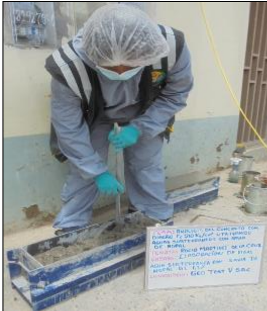
Fotografía 63: Elaboración de vigas del concreto fresco con agua subterránea y savia de nopal al 1.90% según la NTP 339.183.
