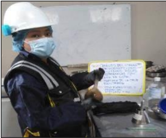
Fotografía 1: Realización del ensayo para determinar la gravedad específica y absorción del agregado fino según la NTP 400.022
