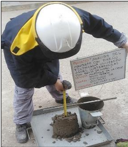
Fotografía 10: Medición del asentamiento del concreto patrón fresco en un rango de 3" a 4" según la norma NTP 339.035.
