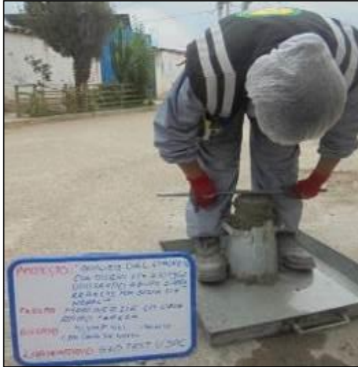
Fotografía 28: Medición del asentamiento del concreto fresco con agua subterránea y savia de nopal al 0.10% en un rango de 3" a 4" según la norma NTP 339.035.
