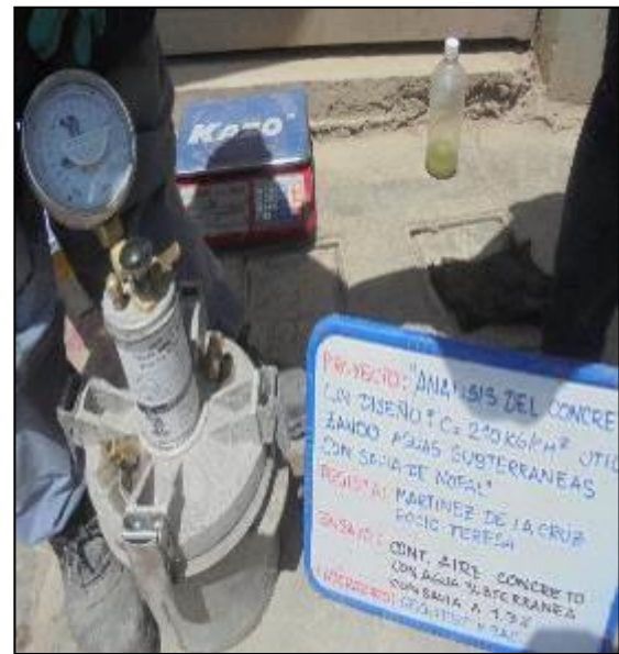
Fotografía 51: Medición del contenido de aire por el método a presión del concreto con agua subterránea y savia de nopal al 1.30% según la NTP 339.083.
