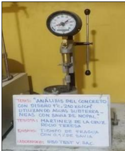
Fotografía 73: Medición del tiempo de fragua del concreto con agua subterránea y savia de nopal al 0.10% según la NTP 339.082.
