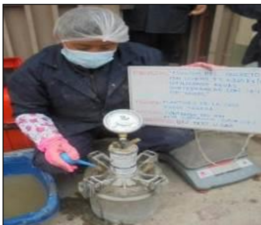
Fotografía 33: Medición del contenido de aire por el método a presión del concreto con agua subterránea y savia de nopal al 0.30%según la NTP 339.083.
