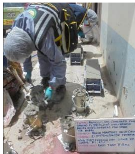
Fotografía 62: Elaboración de cilindros de concreto del concreto fresco con agua subterránea y savia de nopal al 1.90% según la NTP 339.183.
