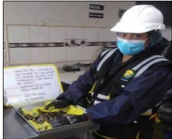
Fotografía 2: Realización del ensayo para determinar la gravedad específica y absorción del agregado grueso según la NTP 400.021
