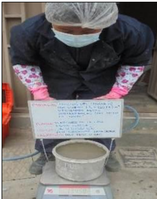
Fotografía 70: Medición de la exudación del concreto con agua subterránea y savia de nopal al 1.90% según la NTP 339.077.
