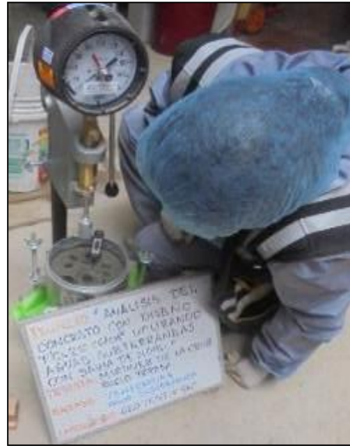
Fotografía 72: Medición del tiempo de fragua del concreto con agua subterránea según la NTP 339.082.
