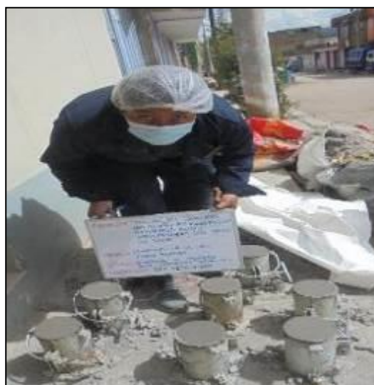
Fotografía 36: Elaboración de cilindros de concreto del concreto fresco con agua subterránea y savia de nopal al 0.30% según la NTP 339.183.
