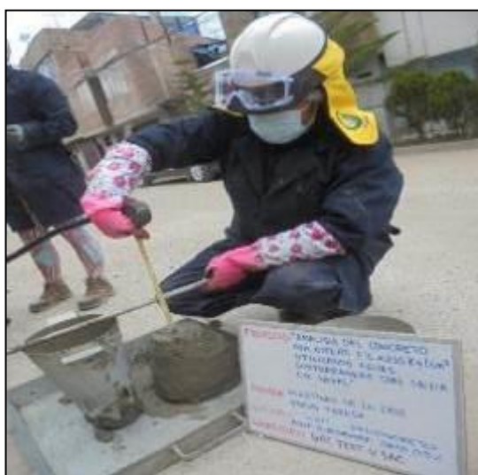
Fotografía 35: Medición del asentamiento del concreto fresco con agua subterránea y savia de nopal al 0.30% en un rango de 3" a 4" según la norma NTP 339.035.
