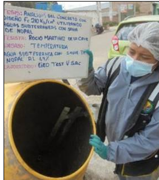
Fotografía 60: Medición de la temperatura del concreto con agua subterránea y savia de nopal al 1.90% (aditivo) según la NTP 339.184.
