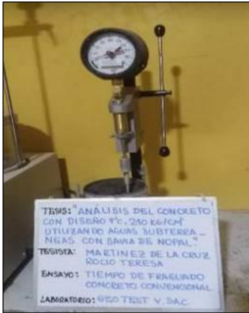
Fotografía 71: Medición del tiempo de fragua del concreto patrón según la NTP 339.082.
