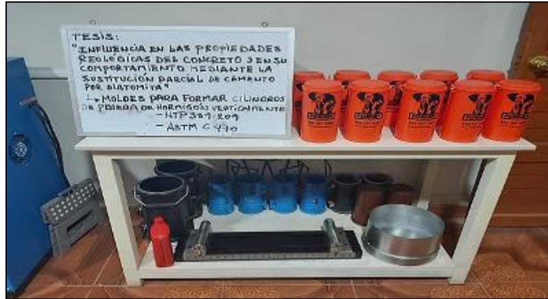
Fotografía 13: Vista de moldes para la elaboración de los cilindros de concreto de acuerdo a la NTP 339.183.
