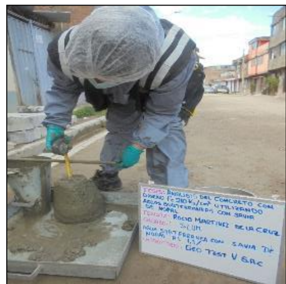
Fotografía 53: Medición del asentamiento del concreto fresco con agua subterránea y savia de nopal al 1.30% en un rango de 3" a 4" según la norma NTP 339.035.
