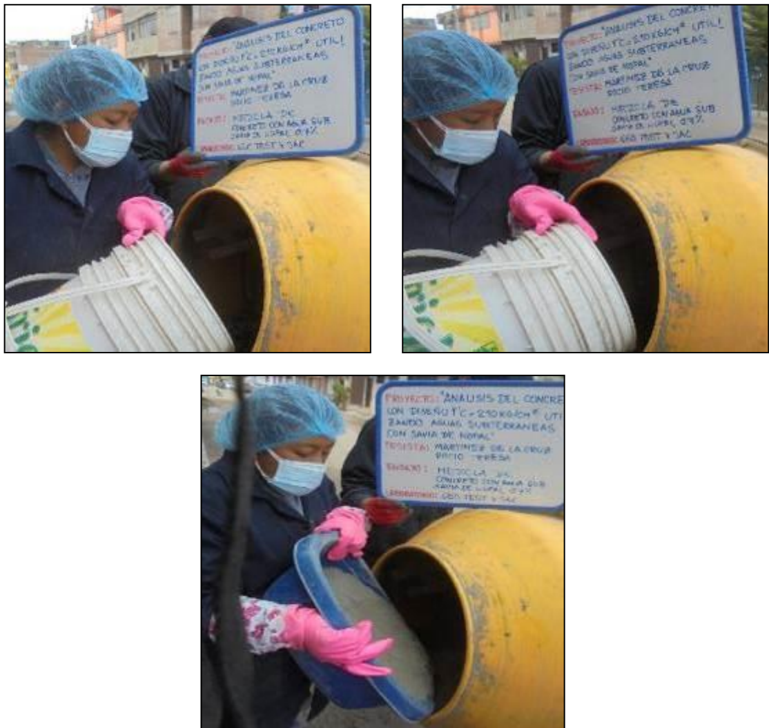
Fotografía 38, Fotografía 39 y Fotografía 40: Vista de materiales tales como agregado, savia de nopal al 0.70% (aditivo), agua subterránea y cemento para la elaboración del concreto, según la NTP 339.183.
