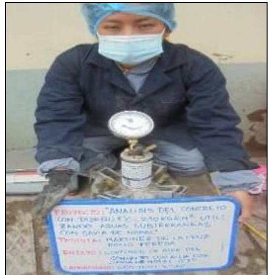
Fotografía 43: Medición del contenido de aire por el método a presión del concreto con agua subterránea y savia de nopal al 0.70% según la NTP 339.083.
