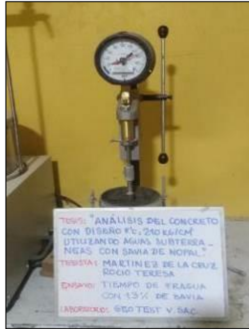
Fotografía 76: Medición del tiempo de fragua del concreto con agua subterránea y savia de nopal al 1.30% según la NTP 339.082.
