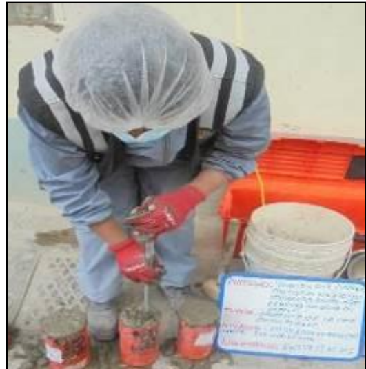
Fotografía 29: Elaboración de cilindros de concreto fresco con agua subterránea y savia de nopal al 0.10% según la NTP 339.183.
