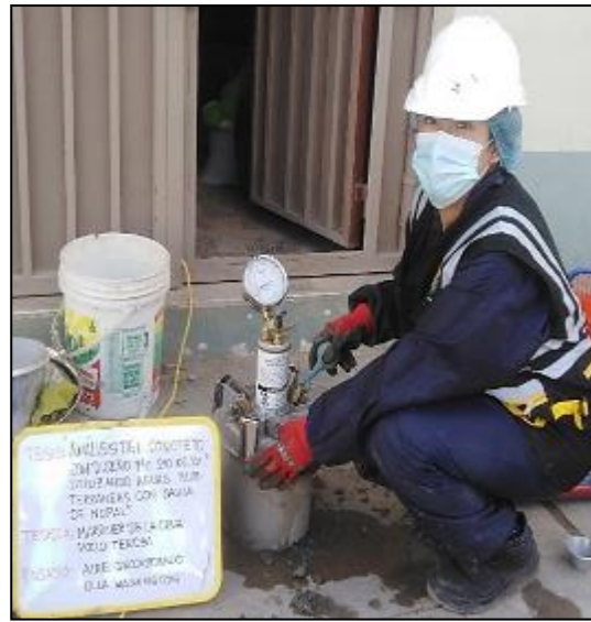
Fotografía 9: Medición del contenido de aire en el concreto patrón mediante el método de presión y la NTP 339.083
