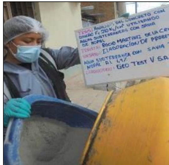
Fotografía 55, Fotografía 56, Fotografía 57 y Fotografía 58: Vista de materiales tales como agregado, savia de nopal al 1.90% (aditivo), agua subterránea y cemento para la elaboración del concreto, según la NTP 339.183.
