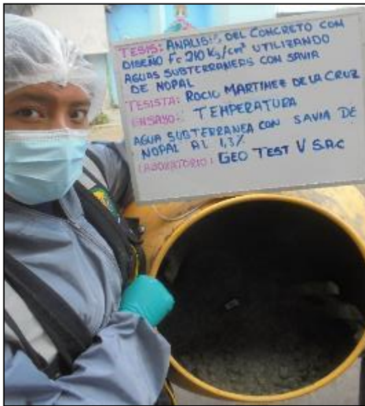
Fotografía 50: Medición de la temperatura del concreto con agua subterránea y savia de nopal al 1.30% (aditivo) según la NTP 339.184.
