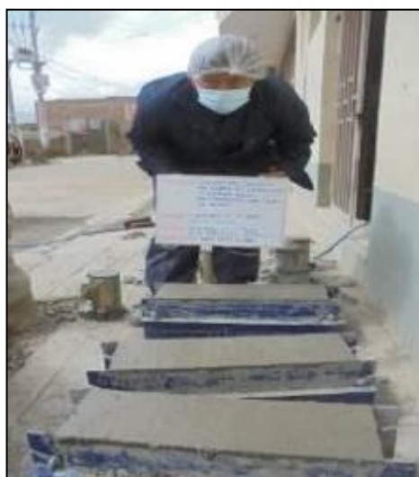
Fotografía 37: Elaboración de vigas del concreto fresco con agua subterránea y savia de nopal al 0.30% según la NTP 339.183.
