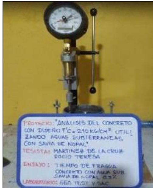
Fotografía 72: Medición del tiempo de fragua del concreto con agua subterránea según la NTP 339.082.
