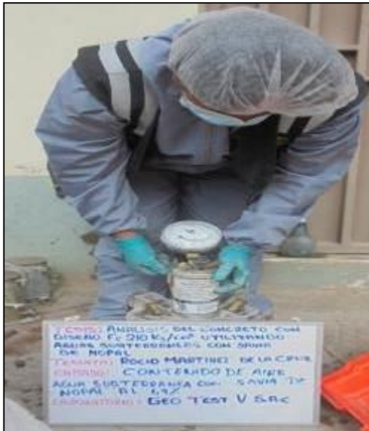
Fotografía 59: Medición del contenido de aire por el método a presión del concreto con agua subterránea y savia de nopal al 1.90% según la NTP 339.083.
