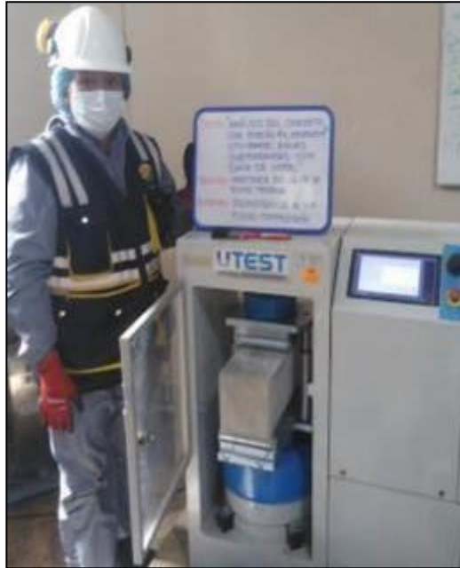
Fotografía 78: Realizando el ensayo de la resistencia a flexo compresión. Según NTP 339.034.
