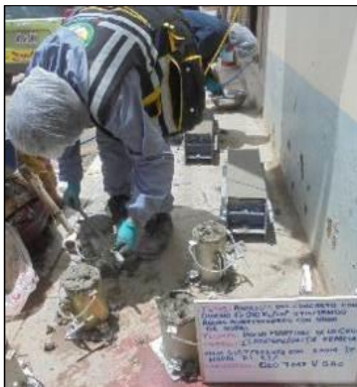
Fotografía 52: Elaboración de cilindros de concreto del concreto fresco con agua subterránea y savia de nopal al 1.30% según la NTP 339.183.
