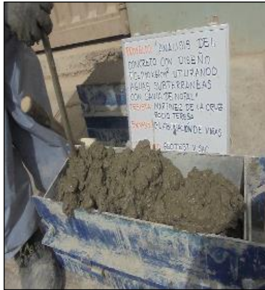
Fotografía 12: Elaboración de vigas del concreto patrón según la NTP 339.183
