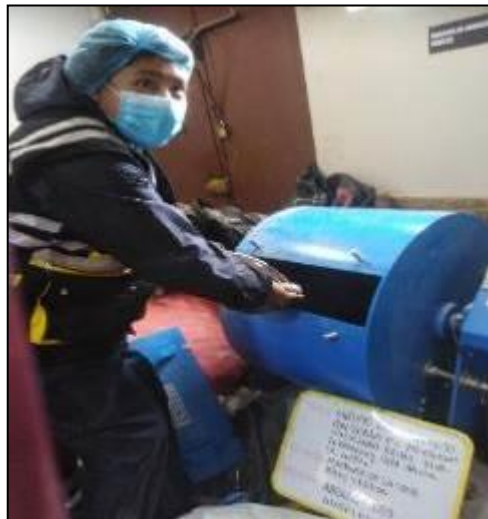
Fotografía 3: Realización del ensayo de abrasión (Maquina de los Ángeles) según la NTP 400.019.
