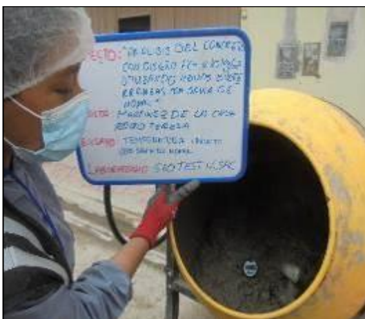
Fotografía 26: Medición de la temperatura del concreto con agua subterránea y savia de nopal al 0.10% (aditivo) según la NTP 339.184.
