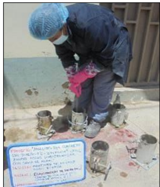
Fotografía 45: Elaboración de cilindros de concreto del concreto fresco con agua subterránea y savia de nopal al 0.70% según la NTP 339.183.
