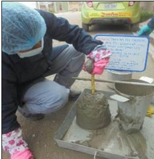
Fotografía 42: Medición del asentamiento del concreto fresco con agua subterránea y savia de nopal al 0.70% en un rango de 3" a 4" según la norma NTP 339.035.
