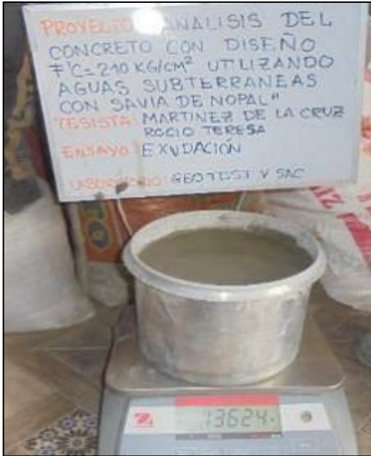
Fotografía 64: Medición de la exudación del concreto patrón según la NTP 339.077.
