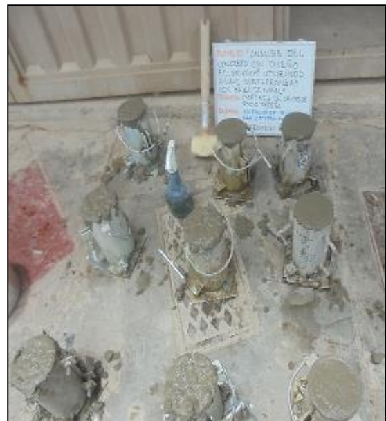
Fotografía 21: Elaboración de cilindros de concreto del concreto patrón con agua subterránea según la NTP 339.183.
