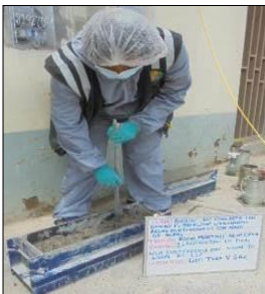
Fotografía 54: Elaboración de cilindros de concreto y vigas del concreto fresco con agua subterránea y savia de nopal al 1.30% según la NTP 339.183.
