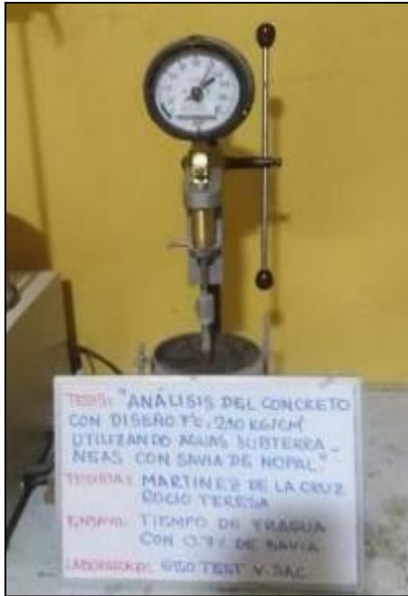
Fotografía 75: Medición del tiempo de fragua del concreto con agua subterránea y savia de nopal al 0.70% según la NTP 339.082.
