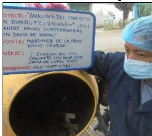
Fotografía 41: Medición de la temperatura del concreto con agua subterránea y savia de nopal al 0.70% (aditivo) según la NTP 339.184.
