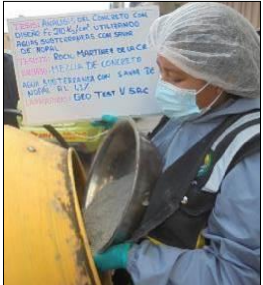
Fotografía 46, Fotografía 47, Fotografía 48 y Fotografía 49: Vista de materiales tales como agregado, savia de nopal al 1.30% (aditivo), agua subterránea y cemento para la elaboración del concreto, según la NTP 339.183.
