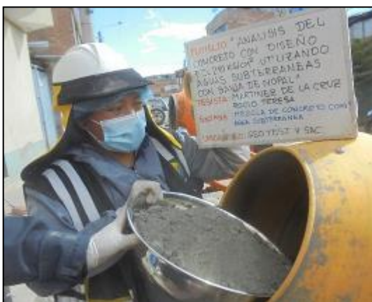
Fotografía 14, Fotografía 15 , Fotografía 16 y Fotografía 17: Vista de agregados, agua subterránea y cemento para la elaboración del concreto, de acuerdo a la NTP 339.183
