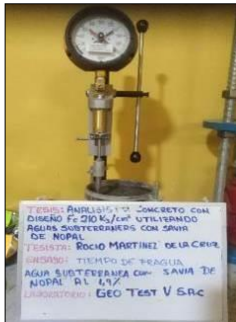
Fotografía 77: Medición del tiempo de fragua del concreto con agua subterránea y savia de nopal al 1.90% según la NTP 339.082.
