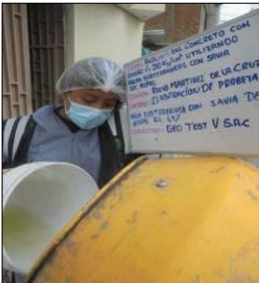
Fotografía 55, Fotografía 56, Fotografía 57 y Fotografía 58: Vista de materiales tales como agregado, savia de nopal al 1.90% (aditivo), agua subterránea y cemento para la elaboración del concreto, según la NTP 339.183.
