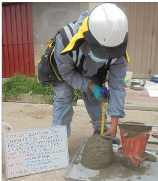
Fotografía 20: Medición del asentamiento del concreto patrón fresco con agua subterránea en un rango de 3" a 4" según la norma NTP 339.035.
