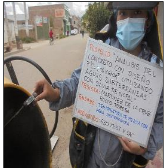
Fotografía 19: Medición de la temperatura del concreto con agua subterránea de acuerdo a la NTP 339.184.
