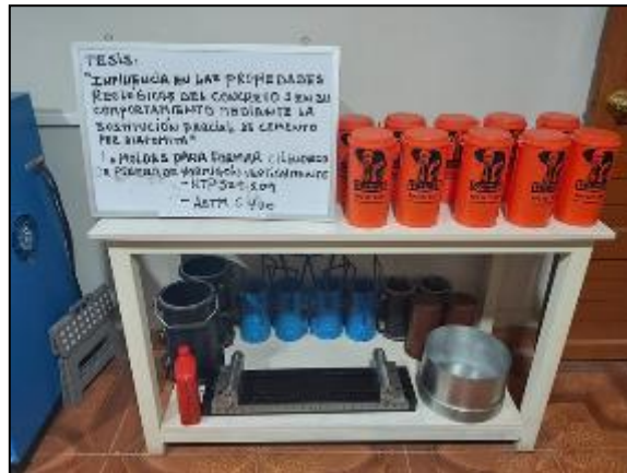
Fotografía 4. Vista de moldes para la elaboración de los cilindros de concreto de acuerdo a la NTP 339.183.
