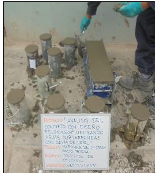
Fotografía 11: Elaboración de cilindros de concreto del concreto patrón según la NTP 339.183.
