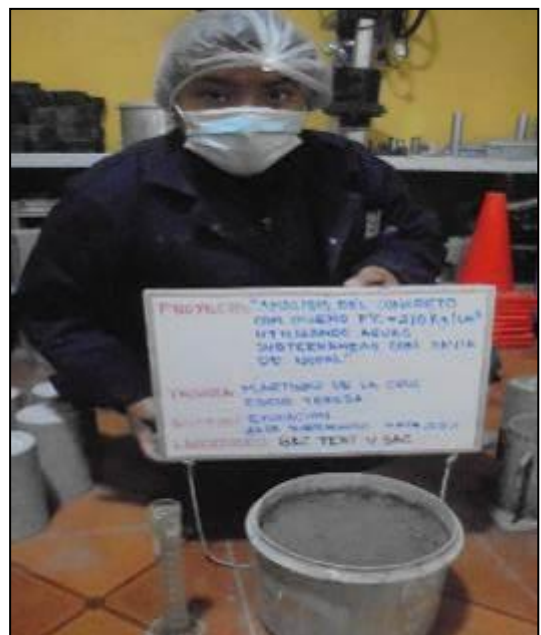
Fotografía 67: Medición de la exudación del concreto con agua subterránea y savia de nopal al 0.30% según la NTP 339.077.
