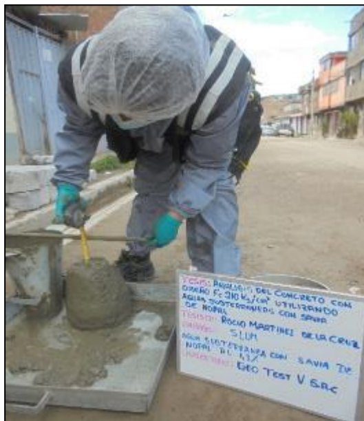
Fotografía 61: Medición del asentamiento del concreto fresco con agua subterránea y savia de nopal al 1.90% en un rango de 3" a 4" según la norma NTP 339.035.
