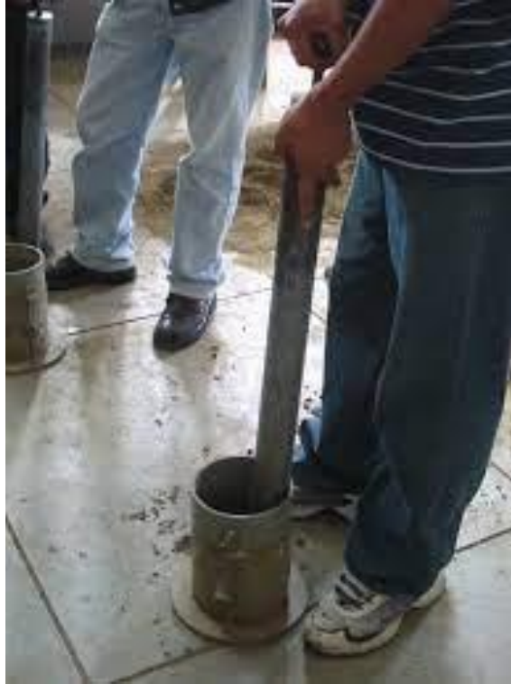
Figura 3: Imagen de compactación de Proctor Modificado
