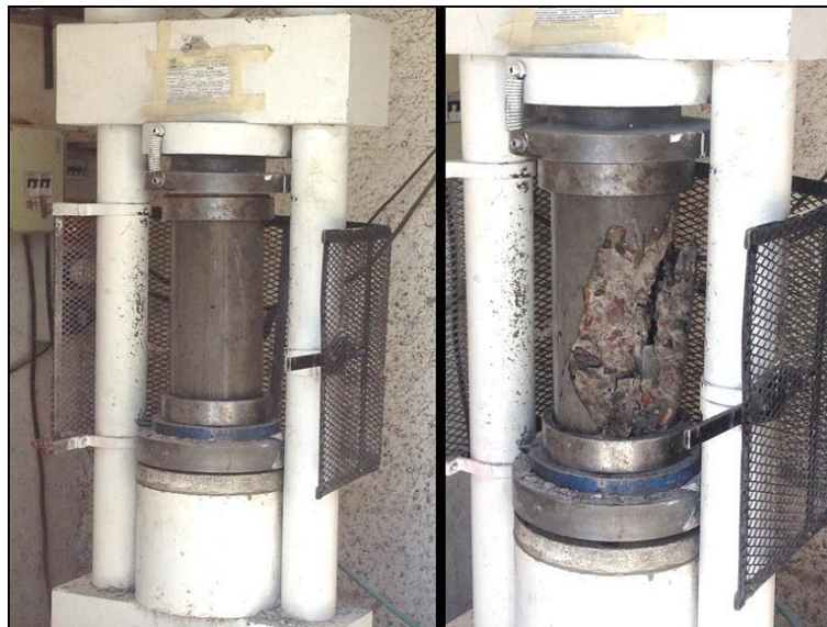
Figura 4: Imagen de Resistencia a la Compresión de probetas
