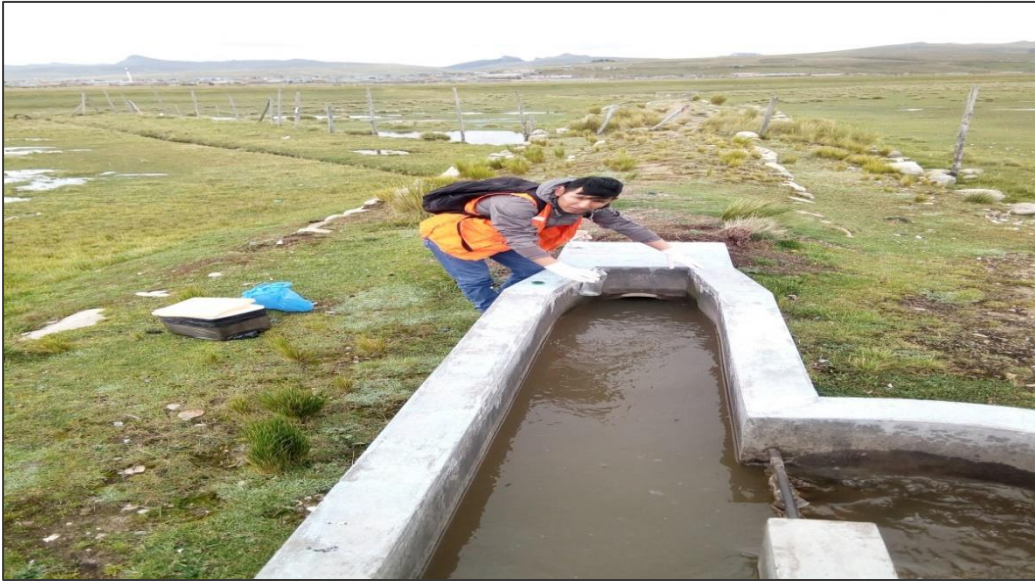
Fotografía N° 15: Toma de muestra para el analisis de agua (Afluente)
