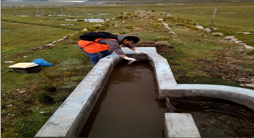
Fotografía N° 16: Toma de muestra del afluente para su análisis
