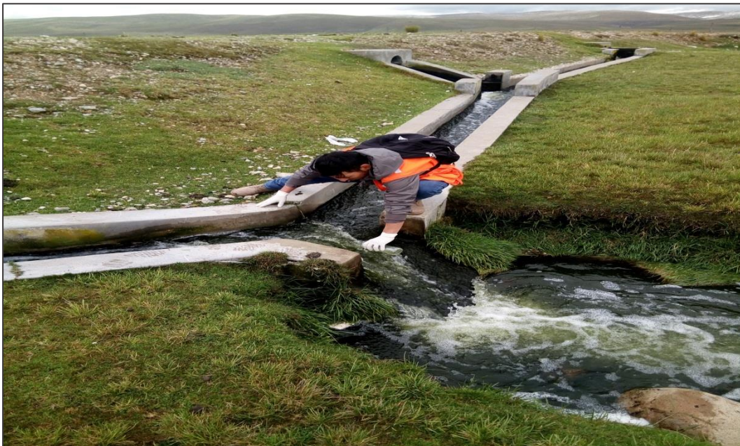
Fotografía N° 18: Toma de muestra del efluente en los recipientes.
