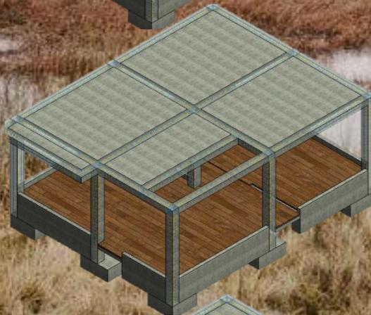
CASCO HABITABLE TERMINADO, CON REVESTIMIENTO EN SECO, PLACAS COLABORANTES Y LADRILLO CARAVISTA DE FACHADA
