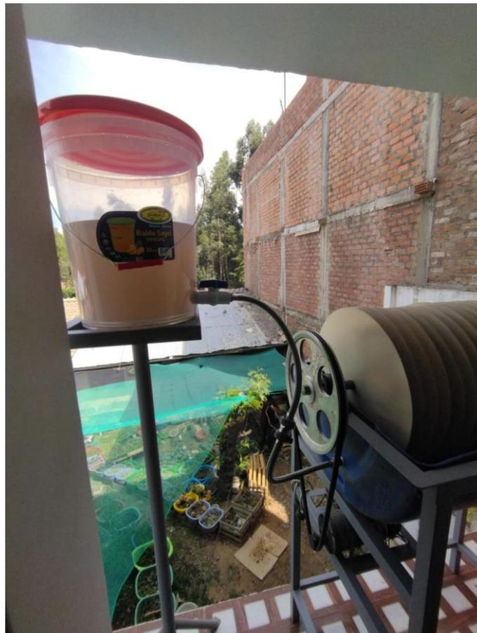
Fotografía 4. Evaluación del sistema de biodiscos con una velocidad de rotación de 3 RPM.
