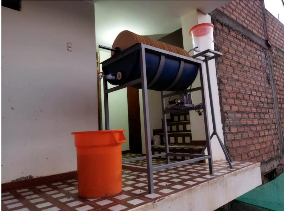
Fotografía 3. Evaluación del sistema de biodiscos con una velocidad de rotación de 3 RPM.
