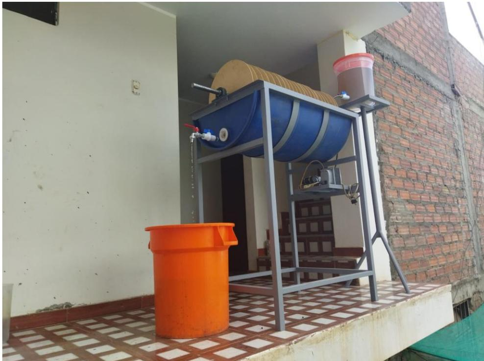
Fotografía 2. Evaluación del sistema de biodiscos con una velocidad de rotación de 1 RPM.
