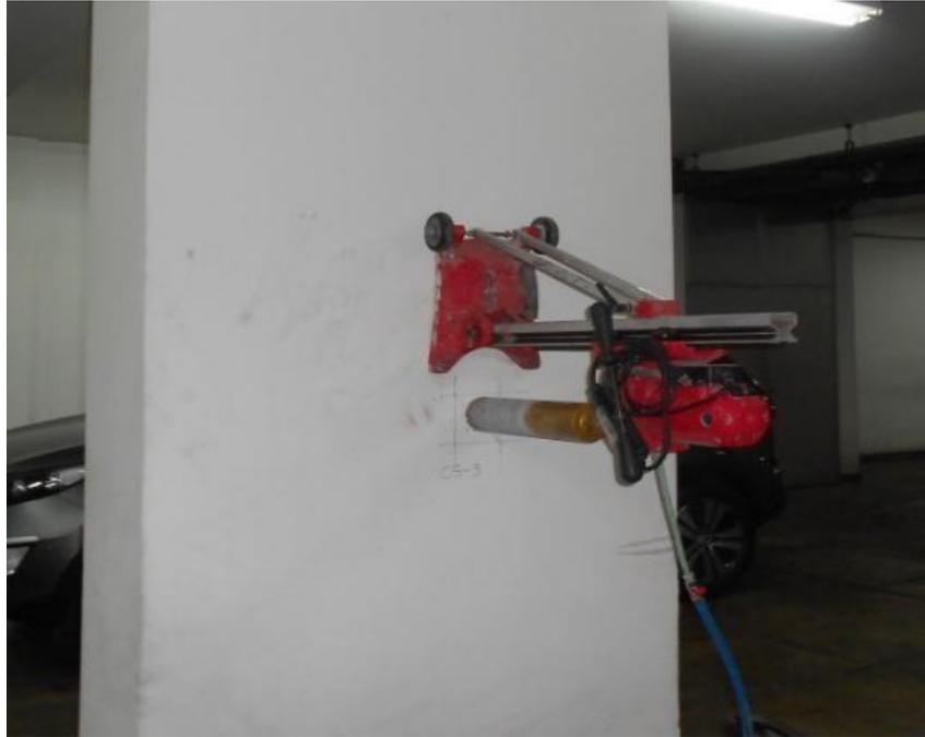
Equipo utilizado para la extracción de muestras de concreto
