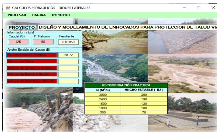
imagen 8: información inicial para diseño y modelado de enrocados laterales
