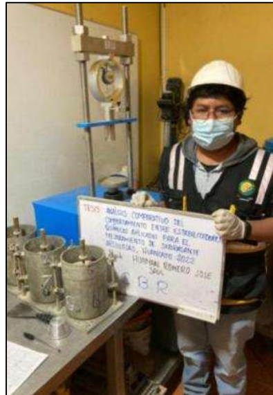
Fotografía N° 7: Especímenes elaborados para ensayo de CBR (antes de rotura), norma MTC E 132.
