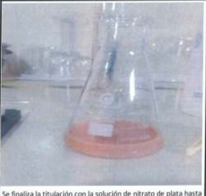
Se observa que al incrementar la solución de nitrato de plata se va opacando el amarillo blanco.
