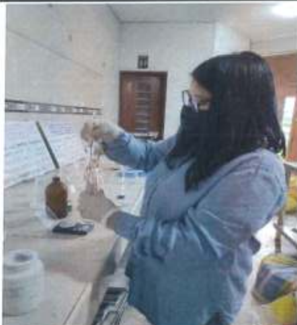
Se añade el nitrato de plata y se agita por 20 s.
