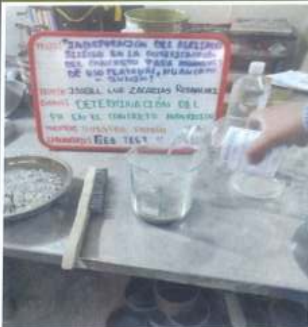
Se llena agua destilada 75 ml y se agita por 20s.
