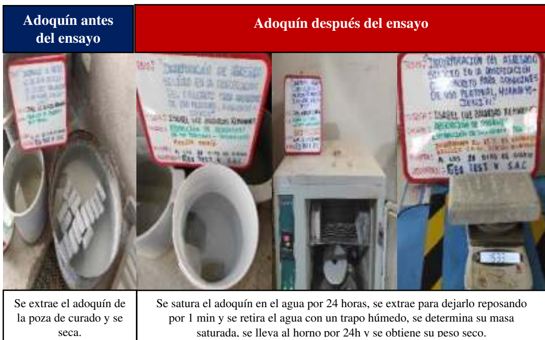
Figura N° 42: Muestras del adoquín al someterse al ensayo de absorción de un antes y un después
