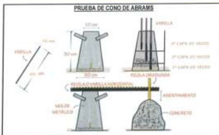
MOLDE PARA DETERMINAR EL ASENTAMIENTO
