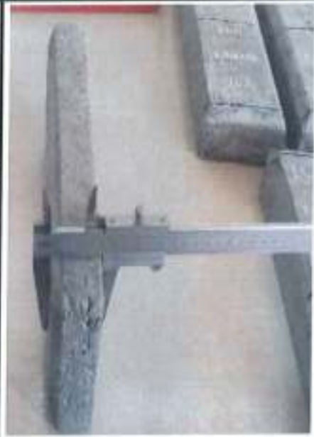
Se realiza las mediciones del espesor del adoquín en la parte superior, intermedio y inferior para sacar un promedio.
