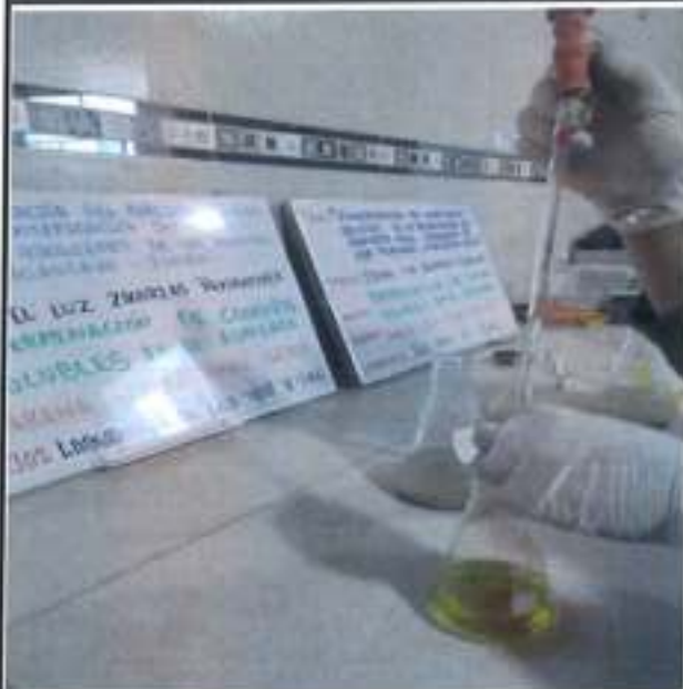
La titulación se realiza con la solución de nitrato de plata cada 0.05 ml.
