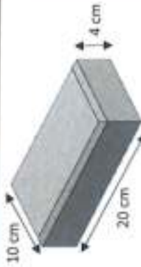
Tipo I : Adoquines para uso peatonal Absorción máxima individual: 7.5%
