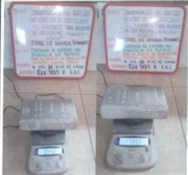
Se determina su masa seca del adoquín para determinar su contenido de humedad.
