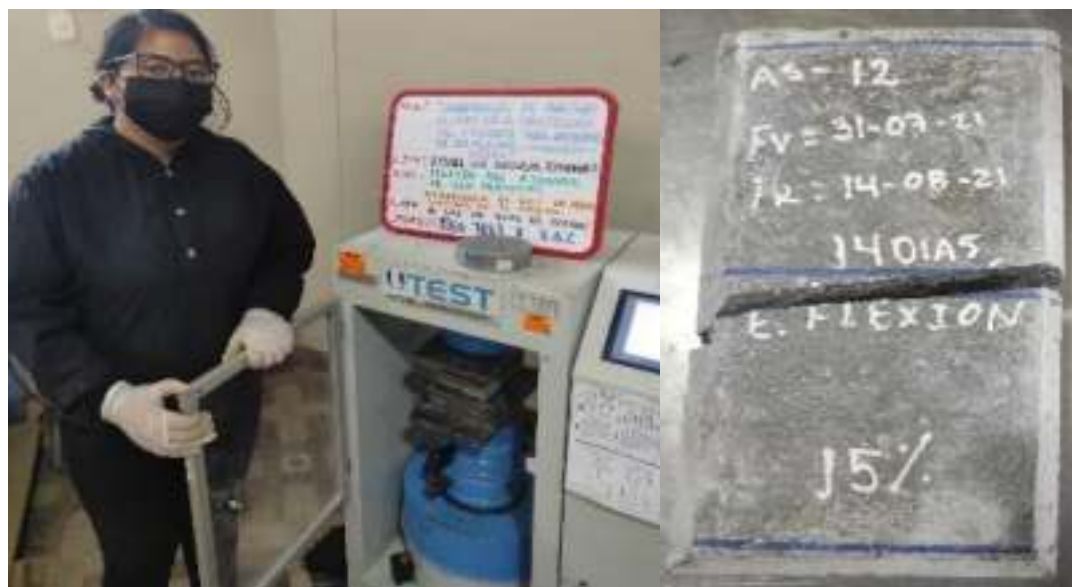
Figura N° 34: Ensayo de resistencia a flexión de los adoquines de uso peatonal (Tipo I) a los 14 días de curado
