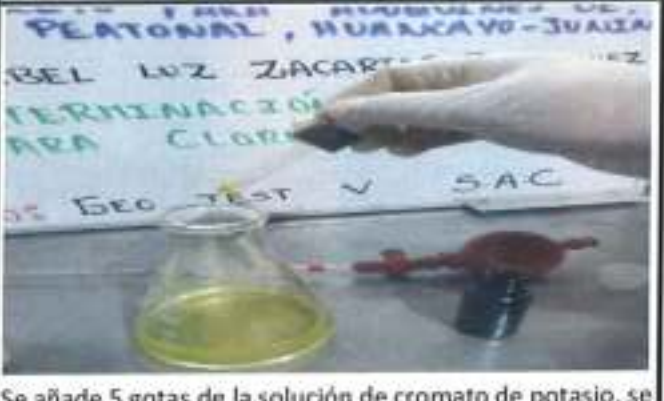
Se añade 5 gotas de la solución de cromato de potasio, se agita por 20 segundos.
