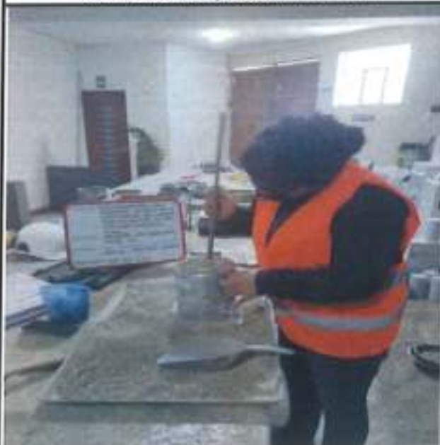
Compactado de la tercera capa
