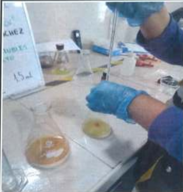
Se procede con la titulación con la solución de nitrato de plata.
