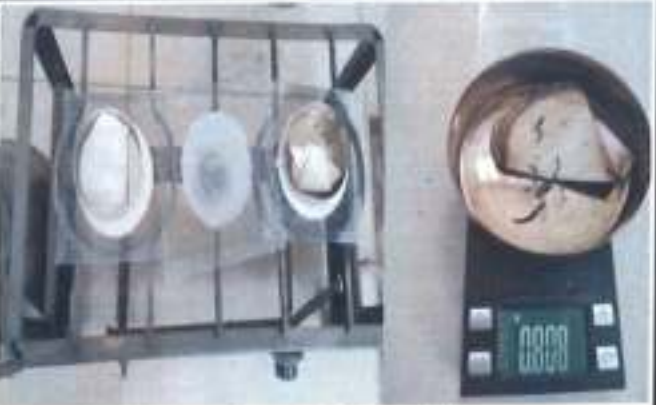
Se calcina el residuo a 800°C por 1 hora y se pesa
