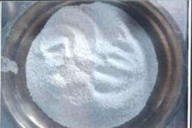
Se puede observar la pasante de la malla N°12
