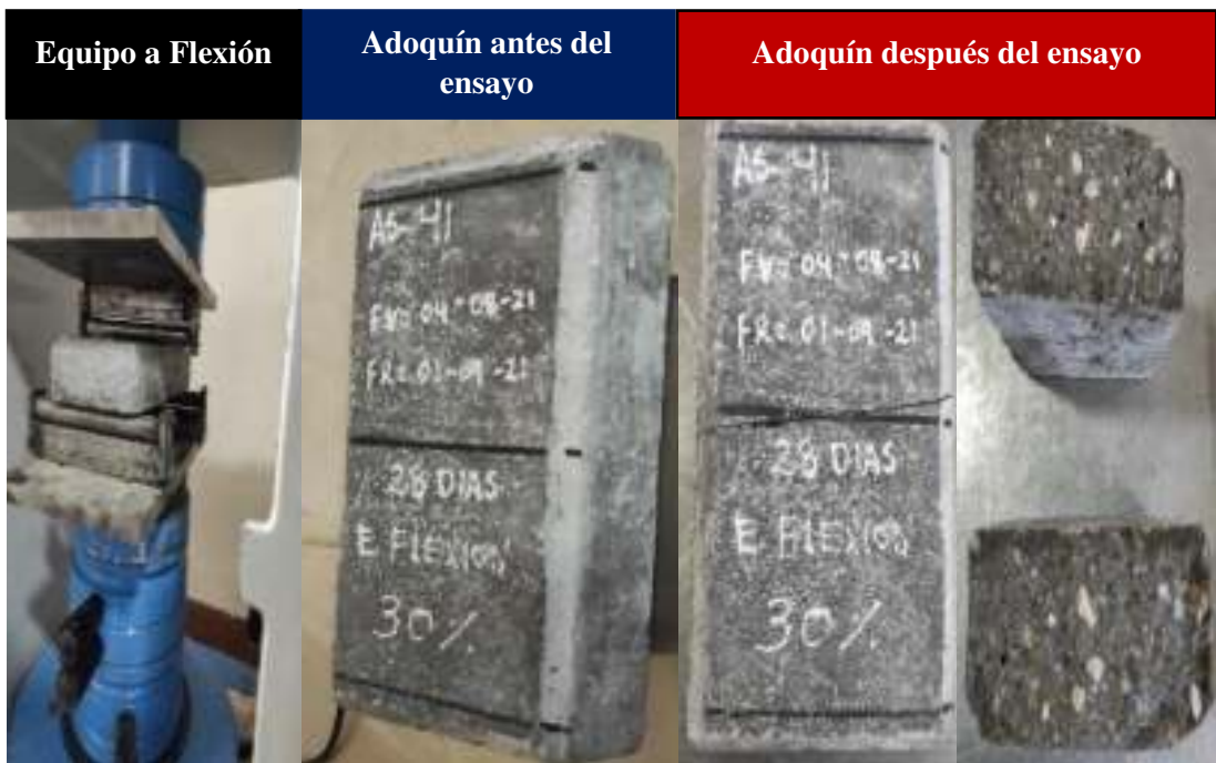
Figura N° 41: Muestras del adoquín al someterse al ensayo de resistencia a flexión de un antes y un después
