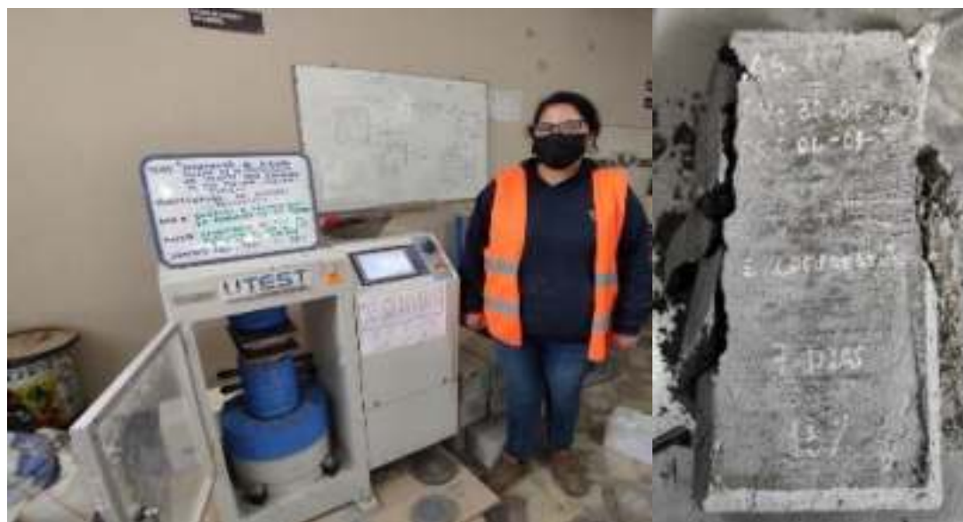
Figura N° 29: Ensayo de resistencia a compresión de los adoquines de uso peatonal (Tipo I) a los 7 días de curado
