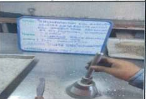
Se comprueba la humedad superficial
