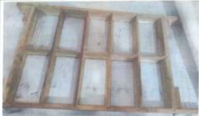
Se coloca desmoldante en el molde de madera de nogal, el molde es desarmable.
