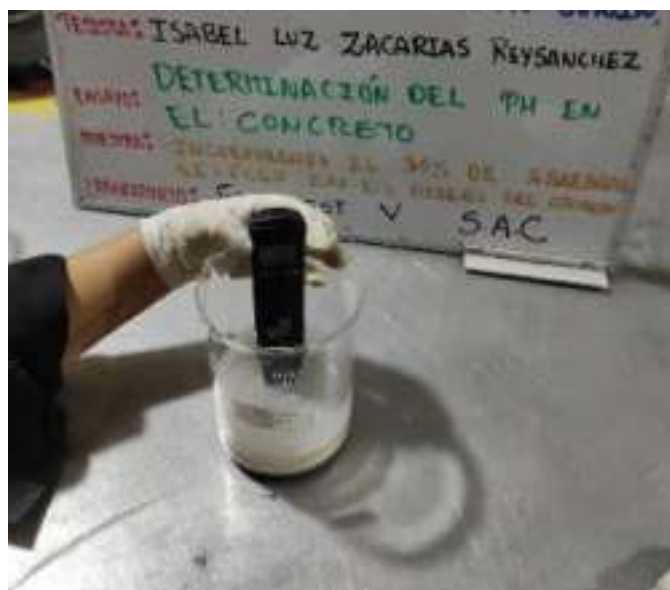
Figura N° 39: Ensayo para determinar el pH del adoquín de concreto tipo I
