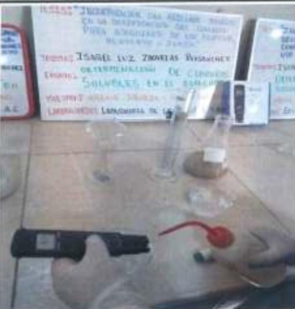
Se lava el lecturrador de PH con agua destilada para realizar la lectura posterior.
