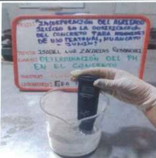
Se llena agua destilada 75 ml y se agita por 20s.
