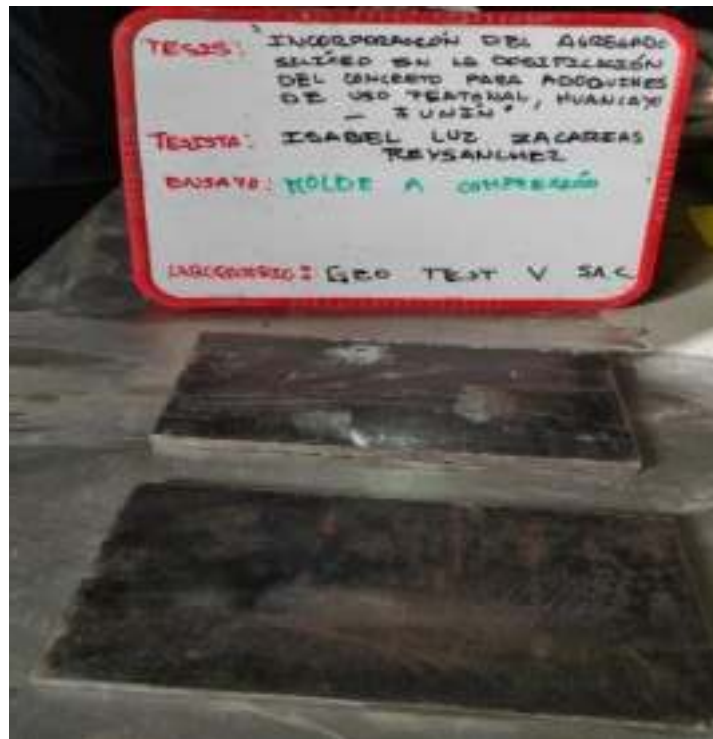
Figura N° 32: Placas de metal para el ensayo de resistencia a compresión de adoquines de uso peatonal (Tipo I)
