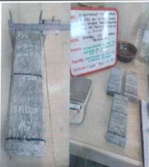
Se verifica las dimensiones de los adoquines.
