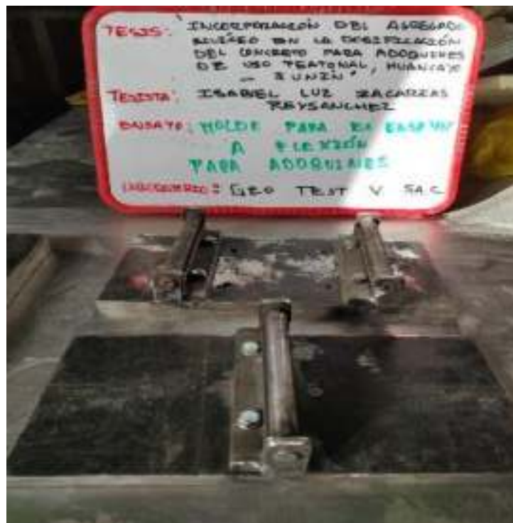
Figura N° 36: Molde para realizar el ensayo de resistencia a flexión de adoquines de uso peatonal (Tipo I)
