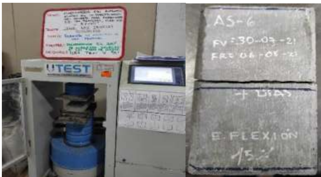
Figura N° 33: Ensayo de resistencia a flexión de los adoquines de uso peatonal (Tipo I) a los 7 días de curado
