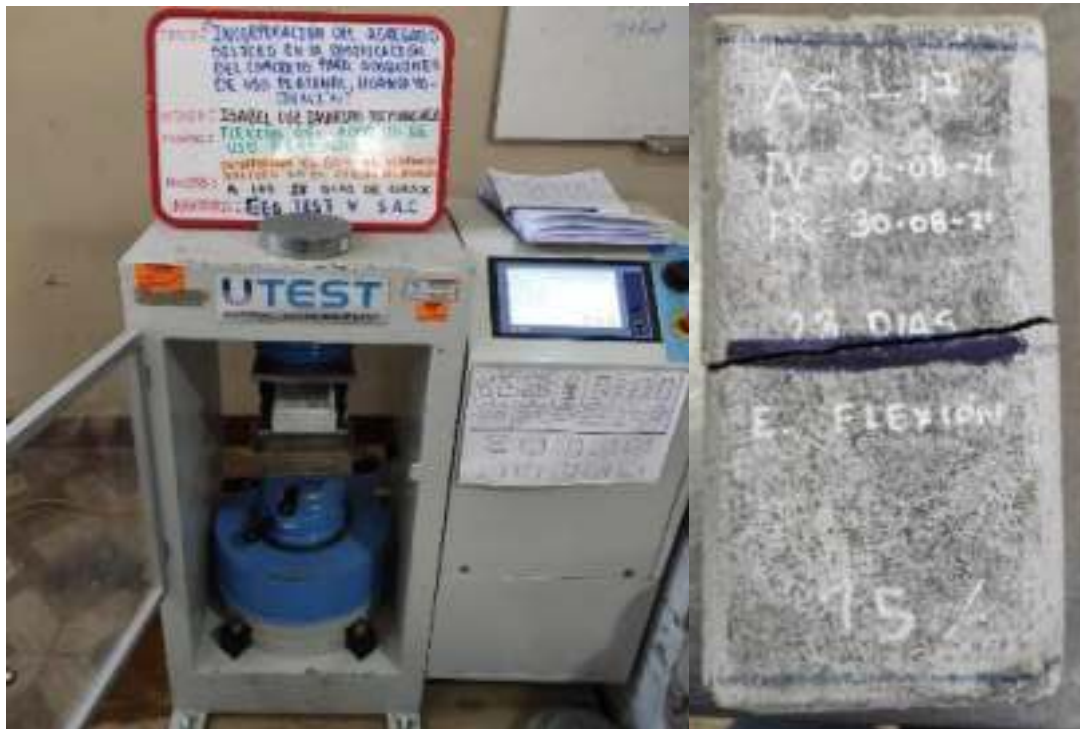
Figura N° 35: Ensayo de resistencia a flexión de los adoquines de uso peatonal (Tipo I) a los 28 días de curado
