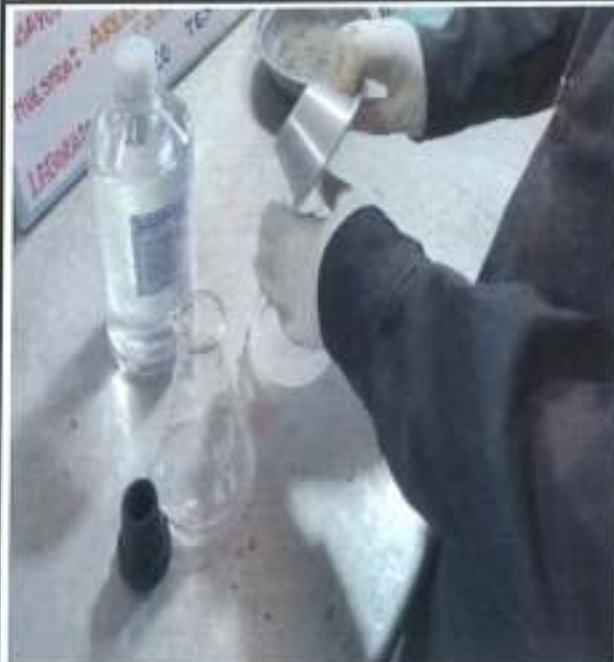
Se puede observar que se esta combinando el hidróxido de sodio con el agua destilada.
