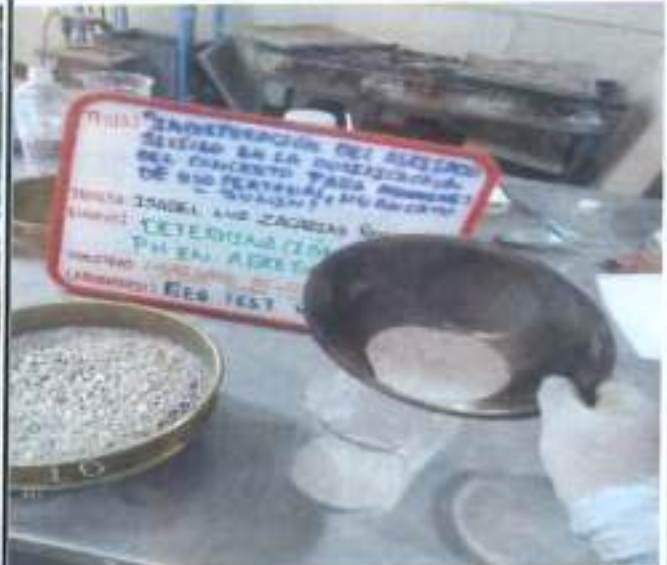
Se pesa la muestra una cantidad mínima de 30g de la pasante de la malla N°10 , se coloca en un baso de precipitación y se adiciona 75 ml de agua destilada.
