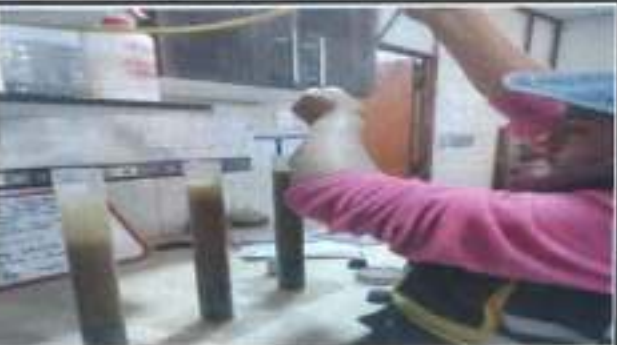
Se realiza la irrigación de limpiando las paredes y punzando suavemente hasta llegar a la medida de 15 pulg dejar reposando por 20 min.
