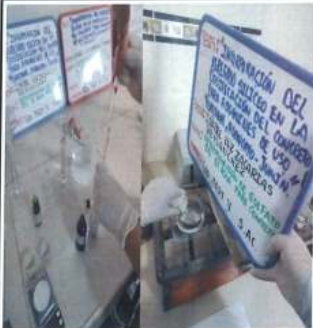
Se mide 5 ml de solución de cloruro de bario y se vierte en el recipiente con la muestra en ebullición.
