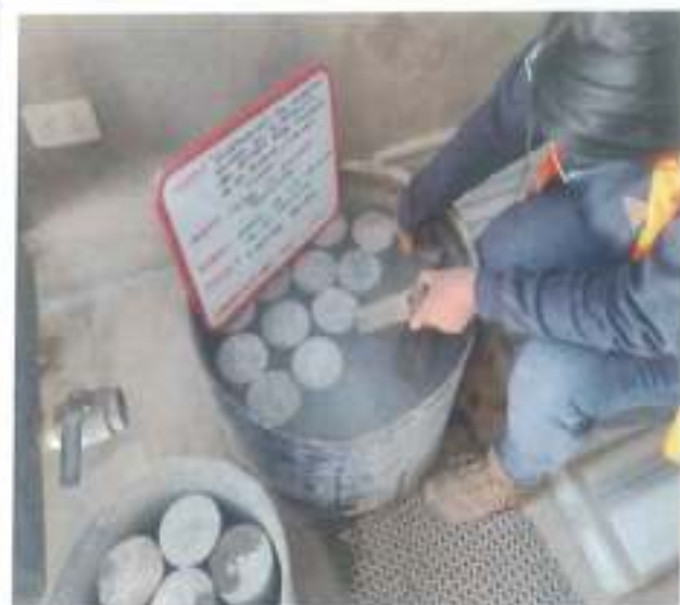
Para el curado de los especímenes será un cilindro que almacenan agua a temperatura de 23^{\circ}\text{C} \pm 2^{\circ}\text{C} , donde se coloca 3 gr de hidróxido de calcio (cal apagada) por litro de agua según el apartado 8.4.1 de la NTP 334.077.
