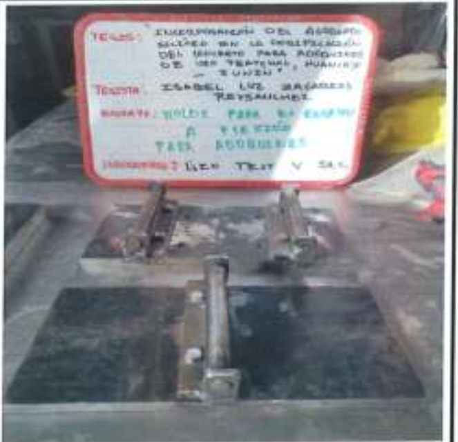
Molde para el ensayo a flexión en adoquines según la norma de Guatemala NTG 41068.
