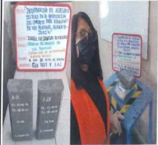
Se deja reposando por 1 min y se retira el agua del adoquín con un paño húmedo, se procede a pesar el adoquín para obtener su masa saturada.
