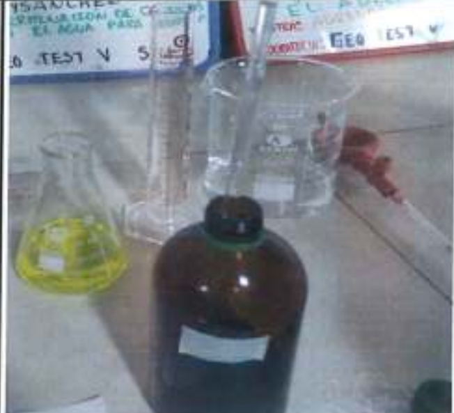
Se vierte en un recipiente se almacena en un frasco marrón ámbar para protegerla de la acción de la luz.
