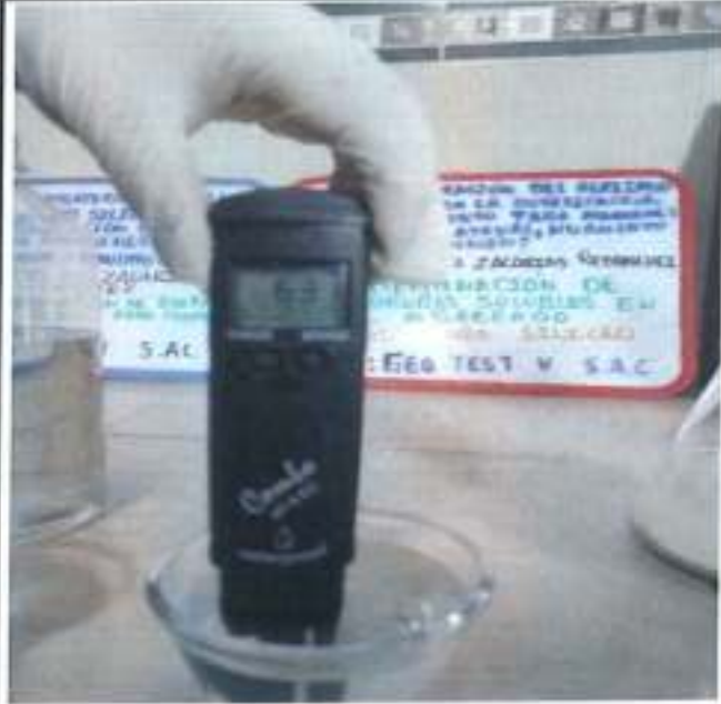
Para lecturar esto debe ser calibrado antes de realizar el ensayo de PH, el cual es adecuado para realizar el ensayo.
