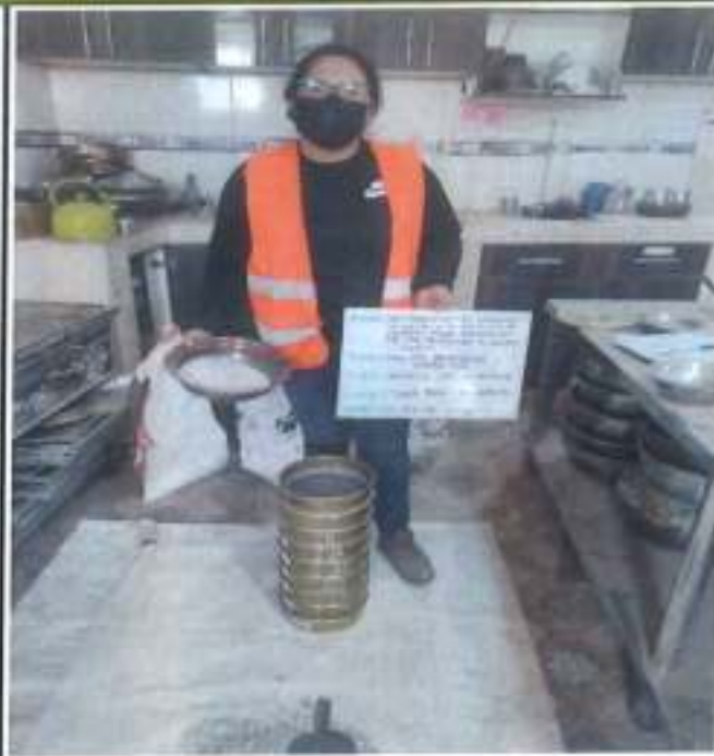
Se lava la muestra y se seca, se tamiza por 1 min
