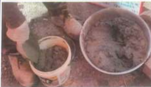
Se llena tres capas de la mezcla representativa pero no hasta el borde del recipiente, se deja 2.5 cm de diferencia.
