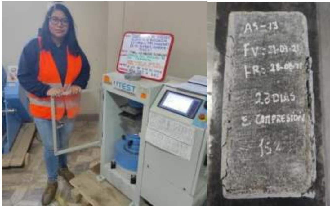
Figura N° 31: Ensayo de resistencia a compresión de los adoquines de uso peatonal (Tipo I) a los 28 días de curado
