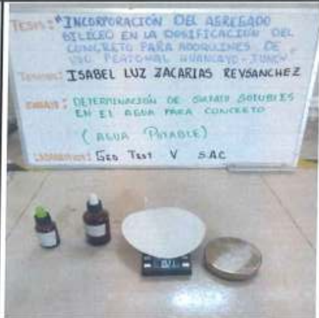
Se determina la masa del papel filtrante de seco y limpio.
