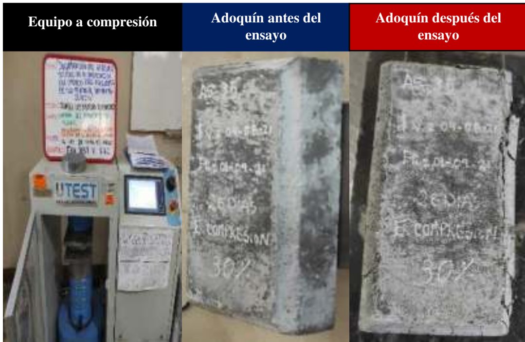
Figura N° 40: Muestras del adoquín al someterse al ensayo de resistencia a compresión de un antes y un después
