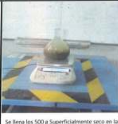
Se llena los 500 g Superficialmente seco en la fiola y se adiciona agua destilada y se elimina las burbujas de aire y se pesa.
