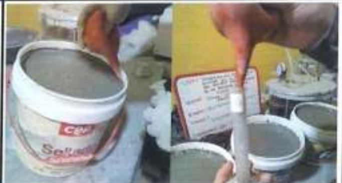
Antes de extraer el agua se coloca un taquito para inclinar el recipiente por 2 min, pasado este tiempo se retira el agua que se acumuló sobre la superficie a intervalos de 10 min durante los primeros 40 min, luego cada 30 min.
