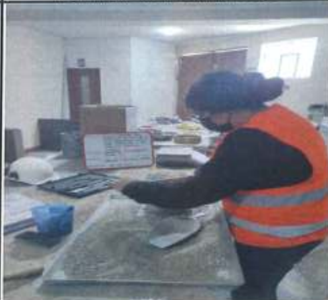
Enrasado para eliminar el material sobrante, y se limpia los contornos del molde con una brocha y se pesa.
