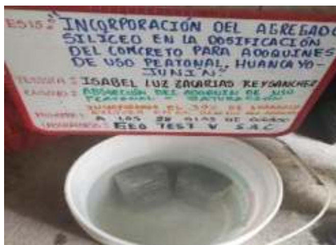
Figura N° 37: Ensayo de absorción en el adoquín de uso peatonal (Tipo I)
