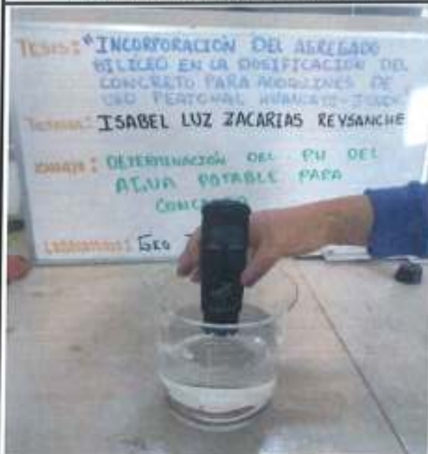
Antes de realizar el ensayo de PH se calibra el equipo para obtener lecturas con mejor precisión.
