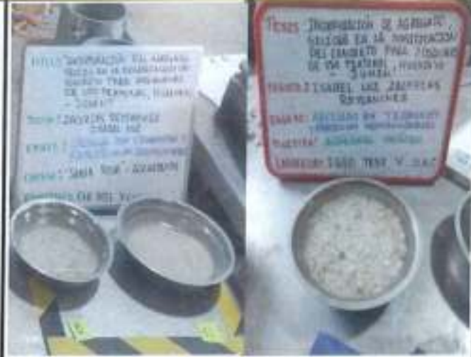
Se pesa la muestra de ensayo según la tabla de la NTP se coloca en un recipiente , se cubre con agua destilada y se deja remojando un periodo de 24 h + 4 h.
