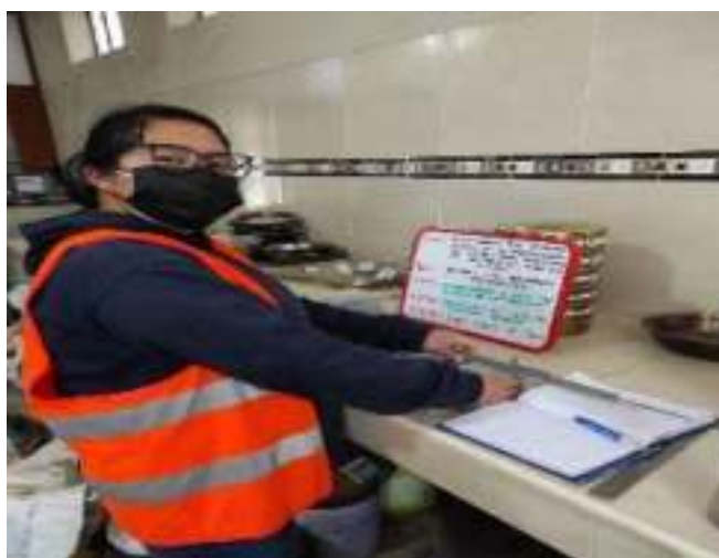
Figura N° 38: Ensayo para determinar las dimensiones del adoquín de uso peatonal
