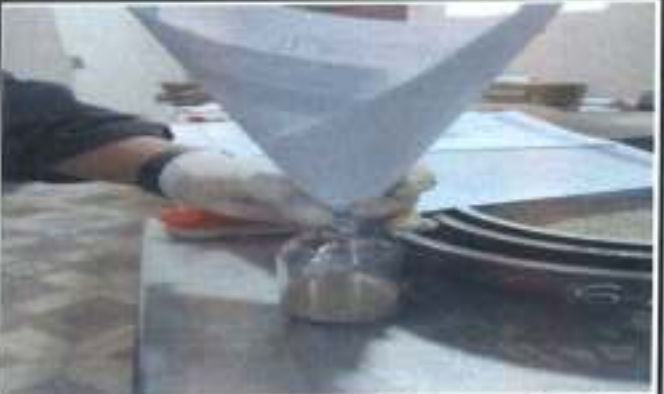
Se llena en una botella graduada la muestra hasta la medida de 130 ml.
