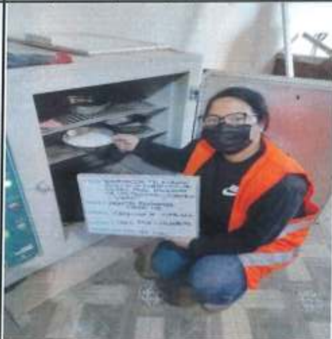
Llevar al horno por 16 horas a 110±5°C
