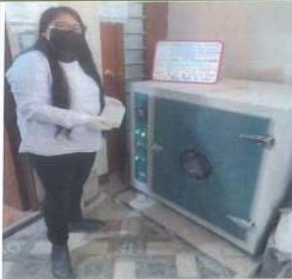
Se seca los adoquines en un horno o estufa a temperatura constante de 110°C a 115°C, cuando es en horno su tiempo de secado será de 24 horas.
