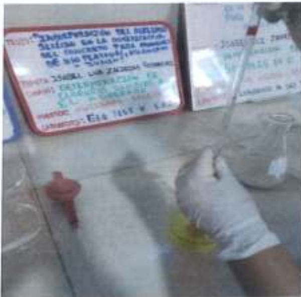
Se titula con la solución de nitrato de plata el cual se mide el volumen que se consume de esta sustancia.
