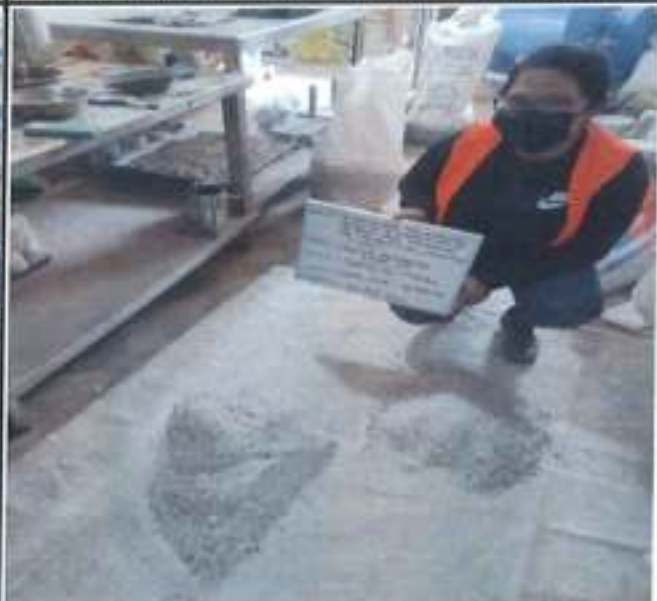
Retención de cuartos opuestos diagonalmente de la muestra reducida.
