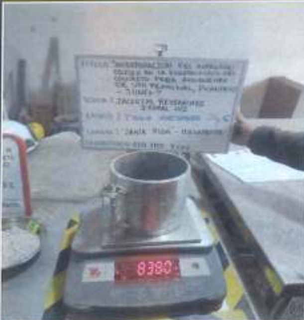
Se pesa el molde vacío y seco, hallar el volumen interno del molde
