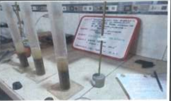
Al finalizar los 10 min se agita manualmente 90 ciclos por 30 segundos.
