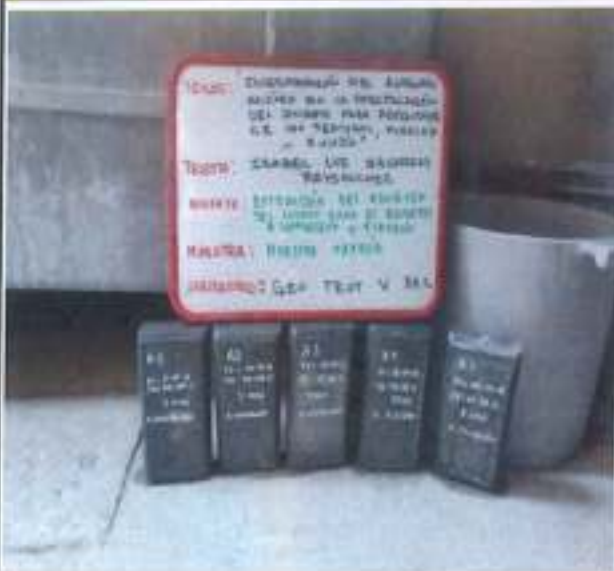
Extracción de los adoquines de la poza de curado para realizar el ensayo a compresión, la tolerancia se detalla en la table 2 de la NTP 339.034.
