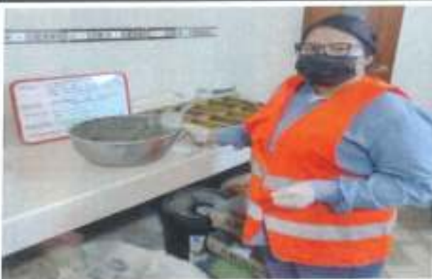
Se lleva la mezcla representativa de concreto donde se realizara el moldeado de los especímenes.
