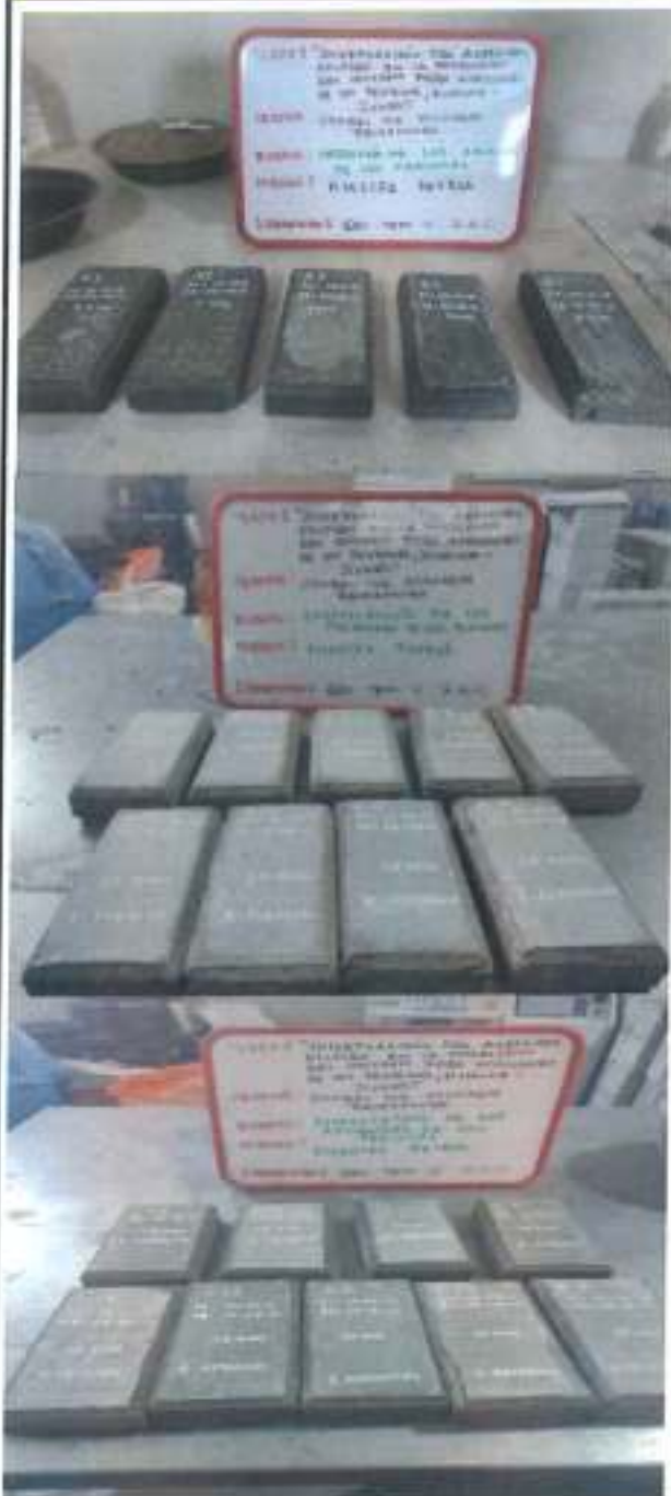
Se desencofra para codificar los adoquines
