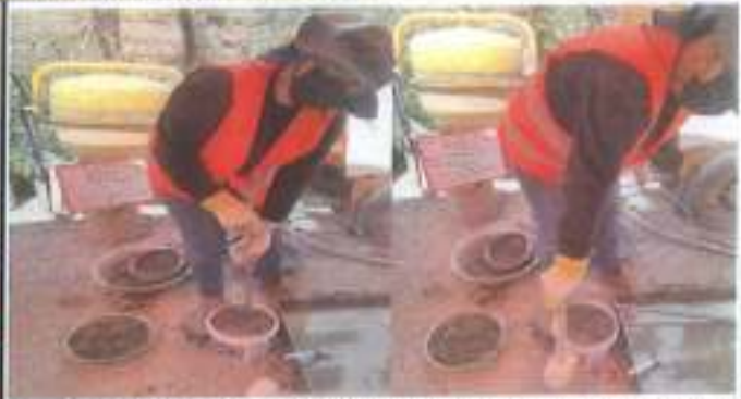
Se coloca la muestra por una capa, se compacta 25 veces con una varilla lisa de 5/8" y golpea a los costado de 10 a 15 golpes con un martillo de goma, la muestra de concreto no debe estar al borde del recipiente se deja 2.5 cm de diferencia.
