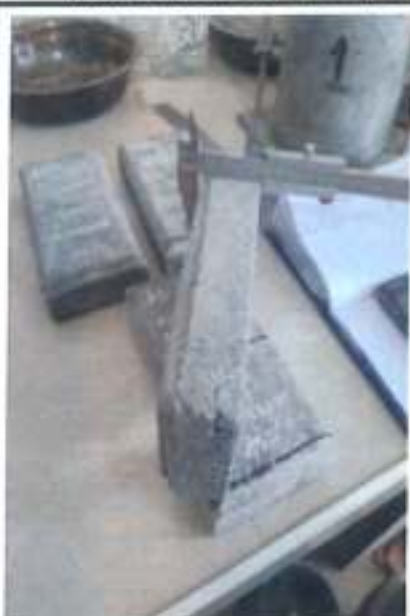
Se realiza las mediciones del espesor del adoquín en la parte superior, intermedio y inferior para sacar un promedio.
