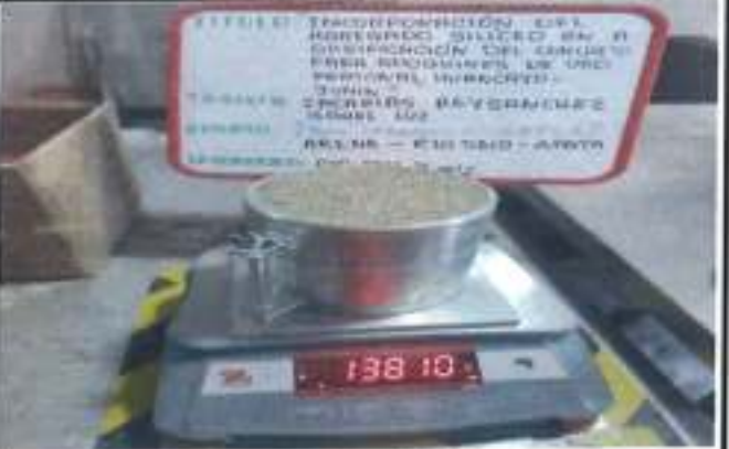
Determinar la masa del molde + la arena gruesa
