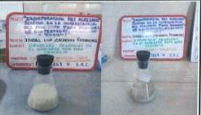
Se deja reposando por 24 h, al finalizar se realiza la lectura del color con el disco circular de Gardner.
