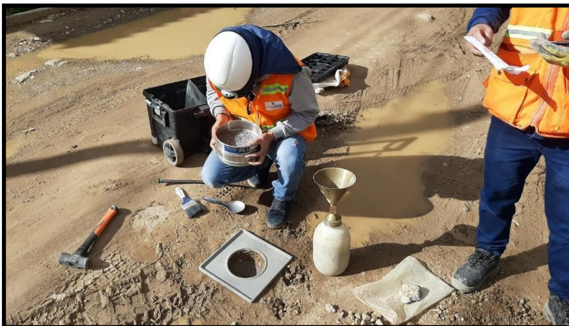
En la presente foto se observa el tamizado por las mallas de la base para obtener los resultados de la Densidad de Campo
