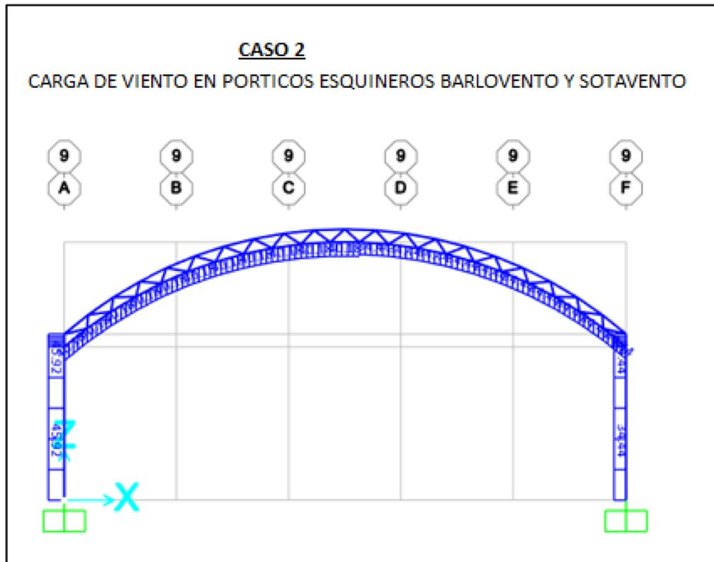
Figura 15: Carga de viento en pórticos en esquina- Caso 2.
