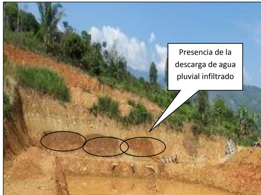
**Fotografía6:** Vista fotográfica del modelamiento de la infiltración de agua
