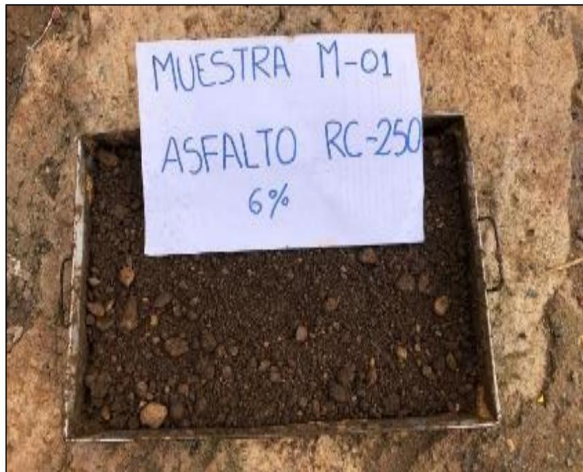
**Fotografia16:** Muestra M-01 suelo natural + 6% de asfalto liquido Rc-250
