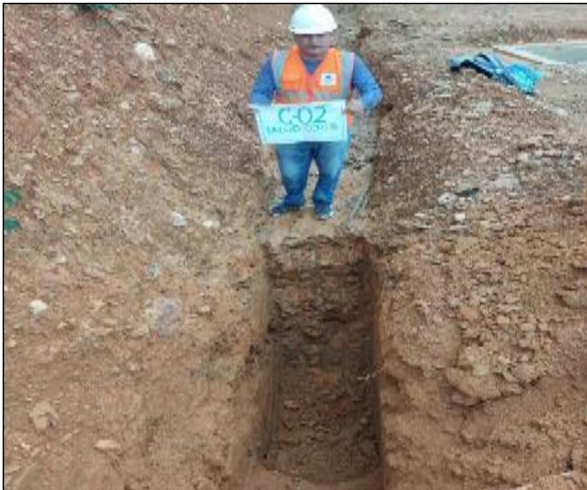
**Fotografía18:** Calicata Nª 02 talud de corte
