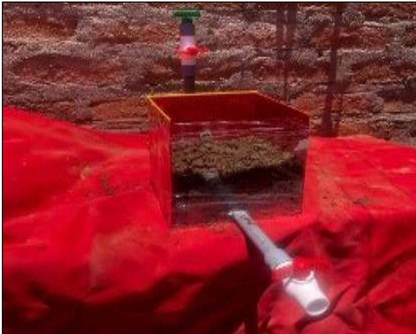
**Fotografia14:** Permeabilidad del suelo mejorado con asfalto liquido Rc-250
