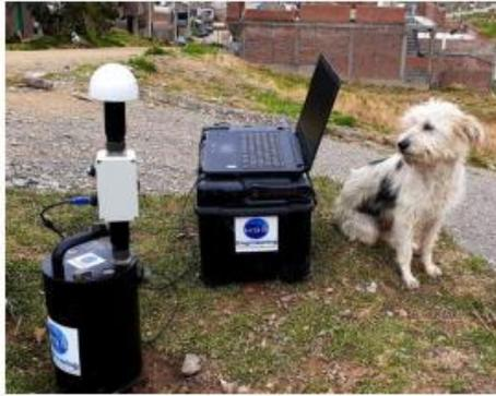
**Figura 3.2:** Acelerómetros ZET 048-C, utilizados para la adquisición de datos.
