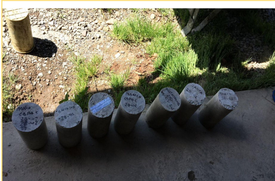
FOTOGRAFÍA N 31: PROBETAS RETIRADAS DEL POZO PARA ENSAYO
