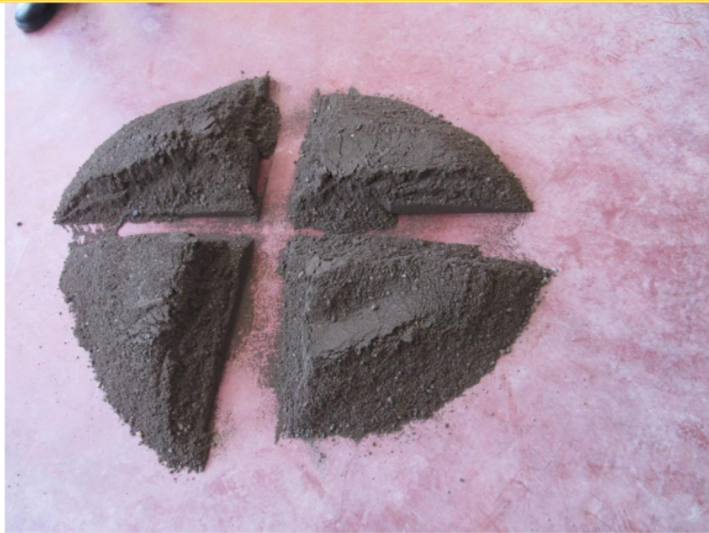
FOTOGRAFÍA N 7: CUARTEO DEL MATERIAL
