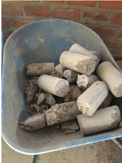
FOTOGRAFÍA N 36: COLOCACIÓN EN BUGGIE DE PROBETAS ENSAYADAS
