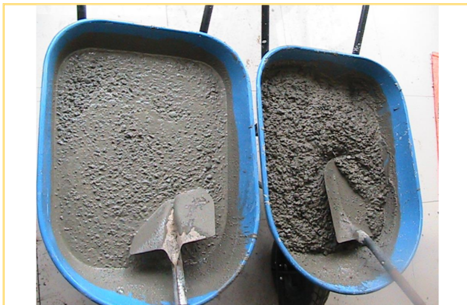
FOTOGRAFÍA N 21: PREPARADO PARA EL ENSAYO DE SLUMP
