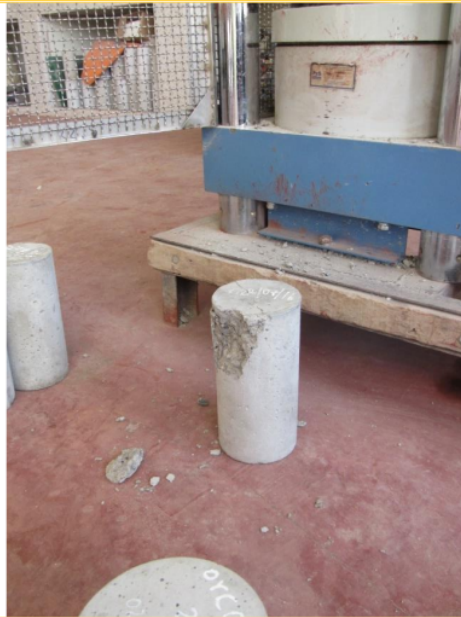
FOTOGRAFÍA N 35: RESULTADO DEL ENSAYO DE COMPRESIÓN AXIAL
