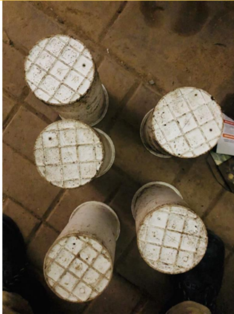
FOTOGRAFÍA N 25: PROBETAS A USAR DEBIDAMENTE EMBARRADAS CON COMPONENTE ANTIDESMOLDANTE
