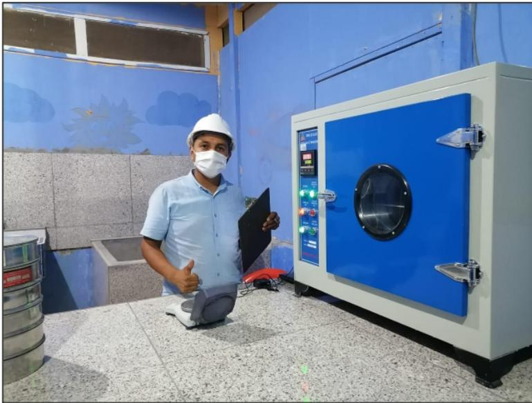
**Fotografía 5:** Contenido de humedad. (MTC E 108 – ASTM D 2216)
