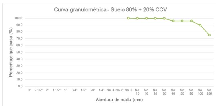
Figura 14. Curva granulométrica – suelo 80% + CCV 20% - Calicata 2
