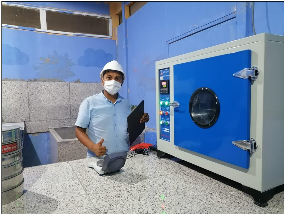
Fotografía 5: Contenido de humedad. (MTC E 108 – ASTM D 2216)
