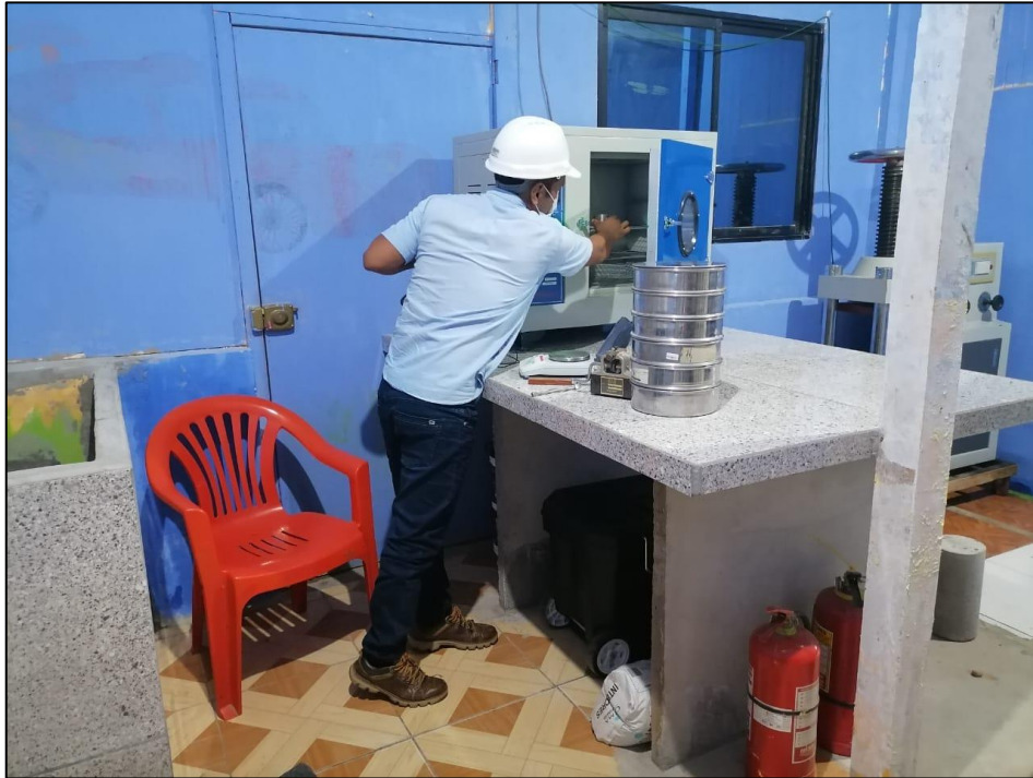
Fotografía 4: Análisis granulométrico del suelo. (MTC E 107 – ASTM C 136 – AASHTO T 88)
