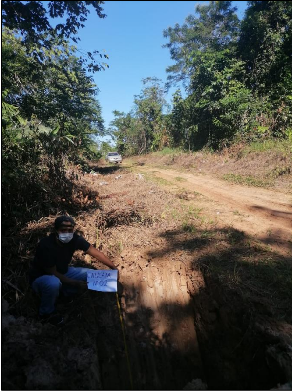
Figura 7. Recojo de material en el camino vecinal Mishiyacu – La Piedra, calicata 2 Fuente: Imagen propia
