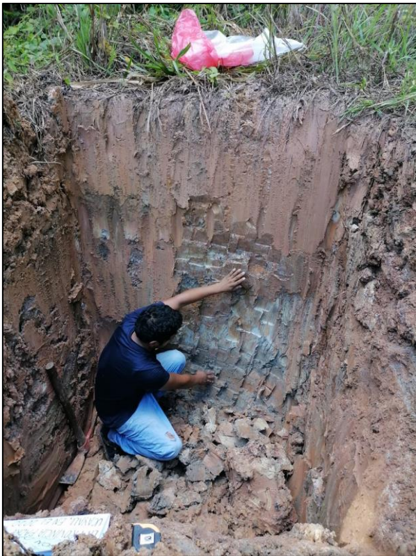
Figura 7. Recojo de material en el camino vecinal Mishiyacu – La Piedra, calicata 2 Fuente: Imagen propia
