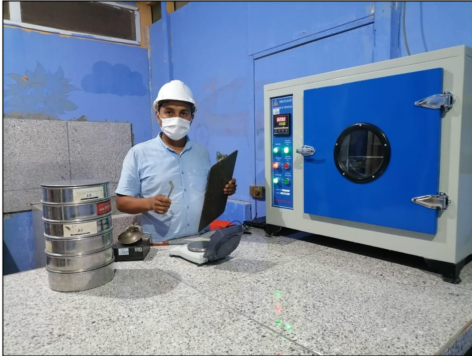
Fotografía 6: Límites de Atterberg. (MTC E 110; 111 – ASTM D 4318 – AASHTO T 90)
