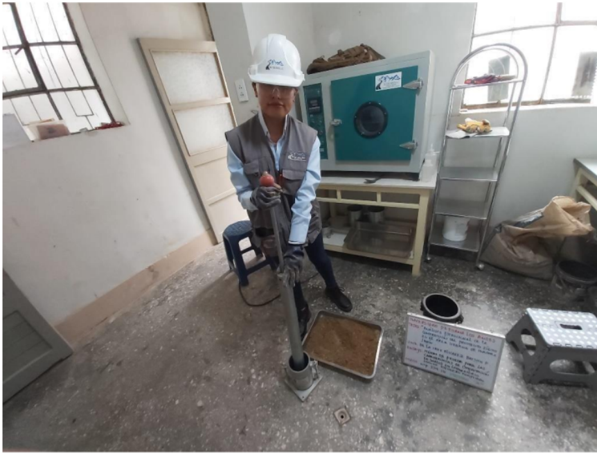
Foto N°05 Desarrollo del ensayo de proctor modificado en laboratorio
