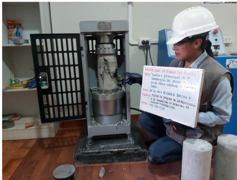
Foto N°08 Desarrollo del ensayo de compresión de muestras de concreto.
