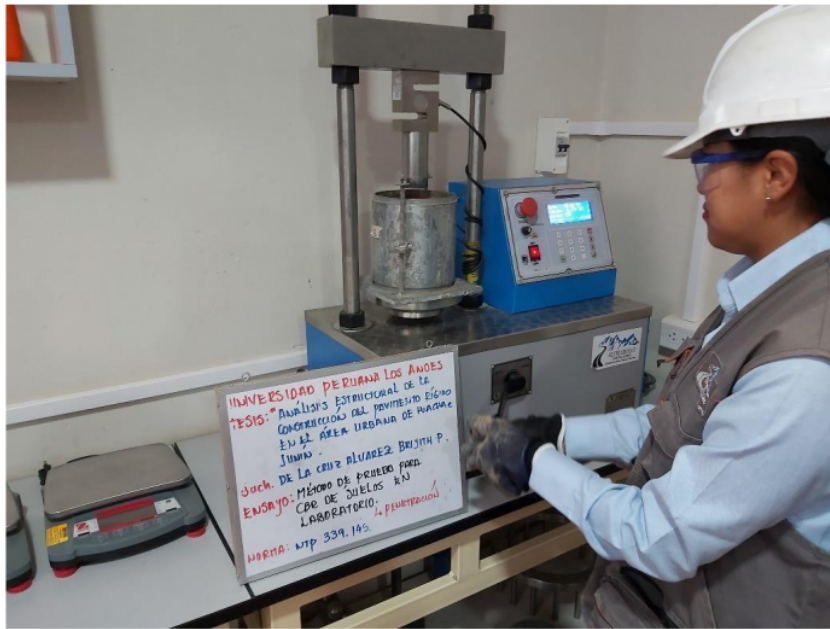
Foto N°06 Desarrollo del ensayo de CBR de material de cantera en laboratorio
