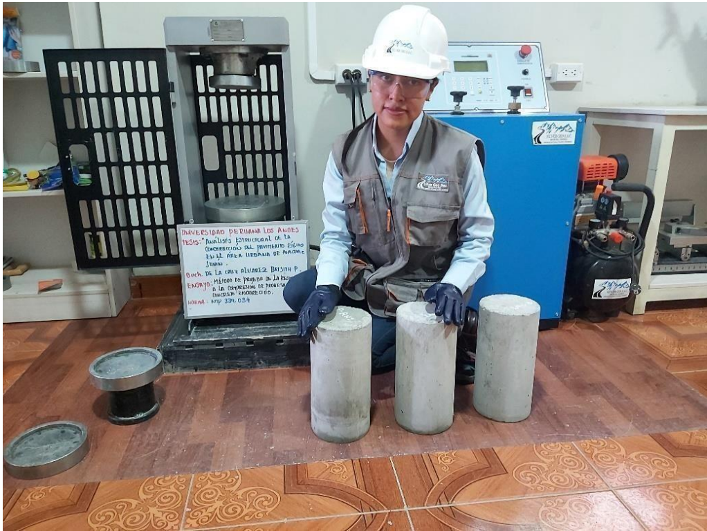
Foto N°07 Desarrollo del ensayo de compresión de muestras de concreto.
