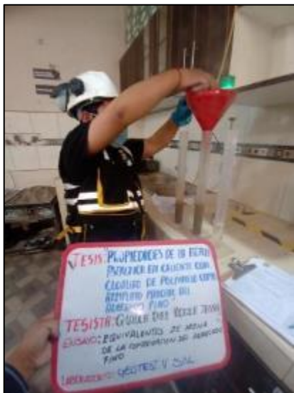
Fotografía 10. Ensayo del equivalente de arena de la combinación del agregado fino según la NTP 339.146.
