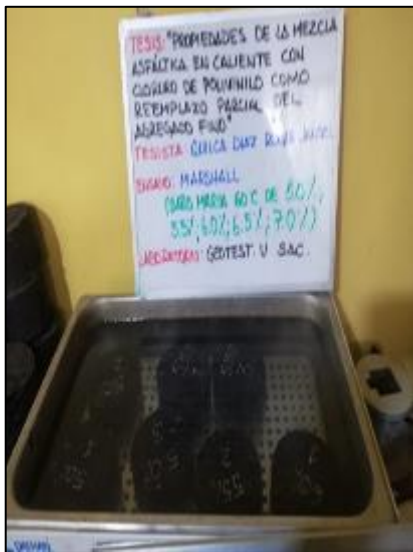
Fotografía 27. Baño María a 60 °C de especímenes según la MTC E – 504.
