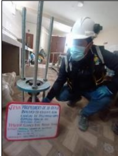
Fotografía 22. Desmoldado de especímenes con 5 %, 5.5 %, 6 %, 6.5 % y 7 % de cemento asfáltico PEN 85/100 según la MTC E – 504.
