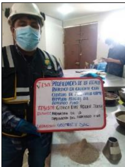
Fotografía 4. Ensayo de peso específico del agregado fino NTP 400.022.
