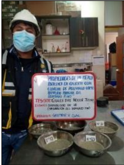
Fotografía 18. Ensayo de durabilidad de la combinación del agregado fino según la NTP 400.016.
