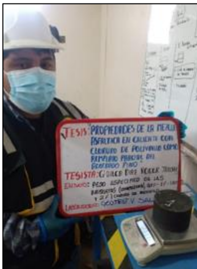
Fotografía 23. Peso específico de las mezclas asfálticas con cloruro de polivinilo según la MTC E – 514.
