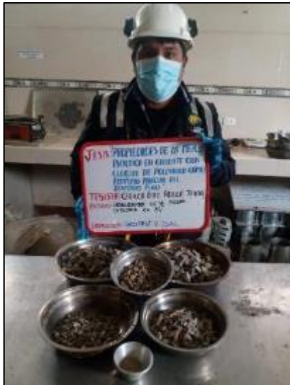
Fotografía 3. Ensayo de granulometría de la piedra chancada de 3/4" según la NTP 400.012.
