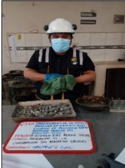
Fotografía 7. Ensayo del peso específico del agregado grueso según la NTP 400.021.
