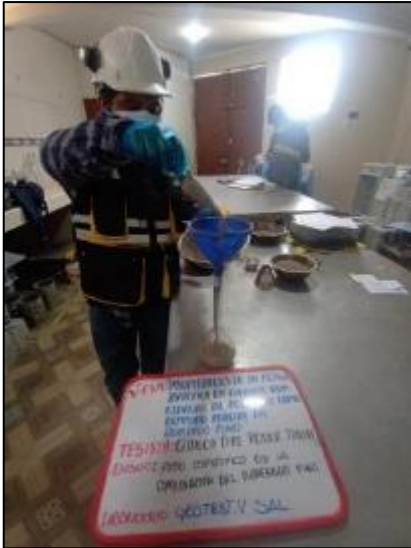
Fotografía 5. Ensayo del peso específico del agregado fino NTP 400.022.
