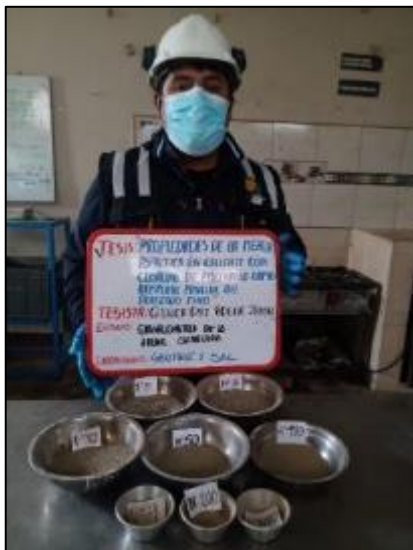
Fotografía 2. Ensayo de granulometría de la arena chancada según la NTP 400.012.
