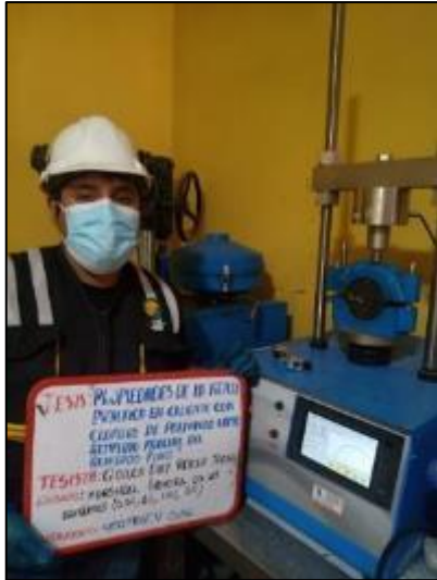
Fotografía 28. Ensayo Marshall de las mezclas asfálticas con cloruro de polivinilo según la MTC E – 504.
