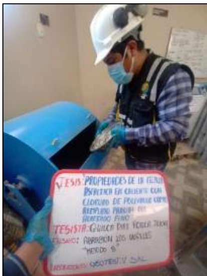
Fotografía 13. Ensayo de abrasión Los Ángeles según la NTP 400.019.
