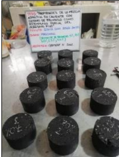
Fotografía 26. Medida de espesor de los especímenes según la MTC E – 504.
