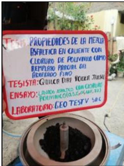
Fotografía 29. Determinación del óptimo contenido de cemento asfáltico en las mezclas según la MTC E – 502.
