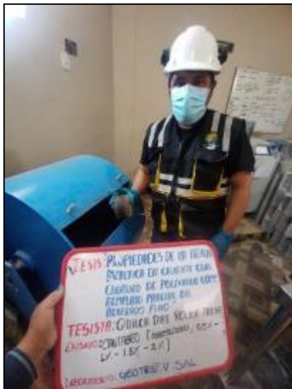
Fotografía 31. Ensayo de pérdida por desgaste de mezclas asfálticas según la MTC E – 515.
