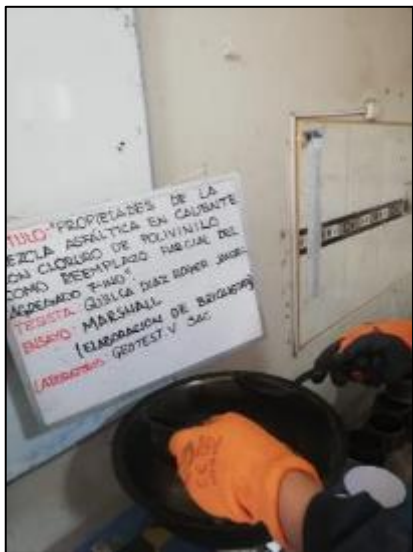
Fotografía 19. Combinación del PEN 85/100 con los agregados según la MTC E – 504.
