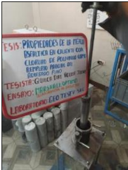
Fotografía 21. Compactación de mezclas asfálticas según la MTC E – 504.
