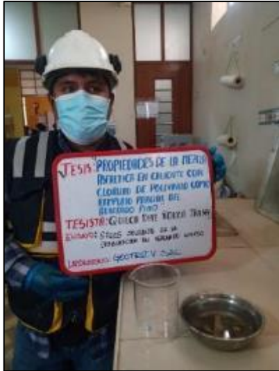
Fotografía 16. Ensayo para determinar sales solubles del agregado grueso según la MTC E – 2019.
