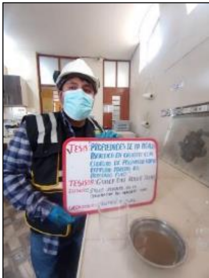
Fotografía 17. Ensayo para determinar sales solubles del agregado fino según la MTC E – 219.
