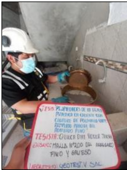
Fotografía 12. Material pasante del tamiz N° 200 del agregado fino según la NTP 400.018.
