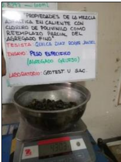
Fotografía 8. Ensayo de peso específico del agregado grueso según la NTP 400.021.
