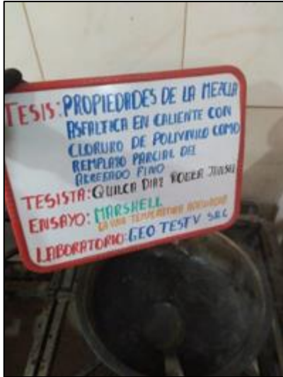
Fotografía 20. Vista de la mezcla asfáltica en caliente a 140 °C para la elaboración de especímenes según la MTC E – 504.
