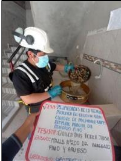
Fotografía 11. Material que pasa el tamiz N° 200 del agregado grueso según la NTP 400.018.
