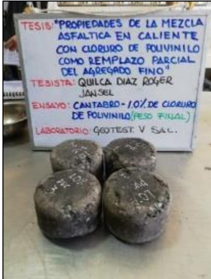
Fotografía 33. Especímenes finales después del ensayo de desgaste según la MTC E – 515.
