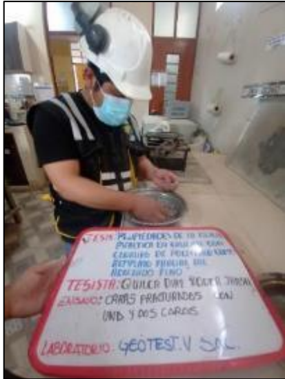
Fotografía 14. Ensayo para determinar caras fracturadas según la norma MTC E – 210.
