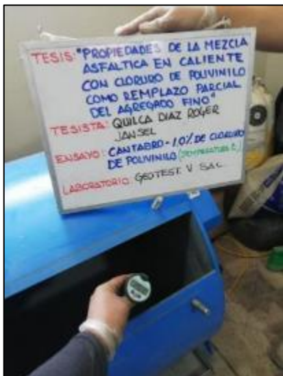
Fotografía 32. Medición de la temperatura para la pérdida por desgaste de las mezclas asfálticas.
