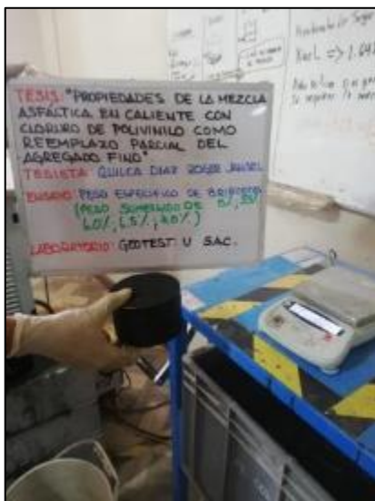
Fotografía 25. Peso específico de especímenes compactados según la MTC E – 514.
