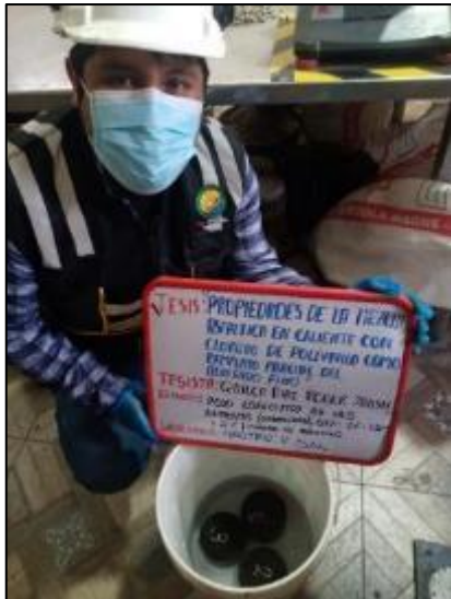
Fotografía 24. Baño por 15 min de los especímenes compactados según la MTC E – 514.
