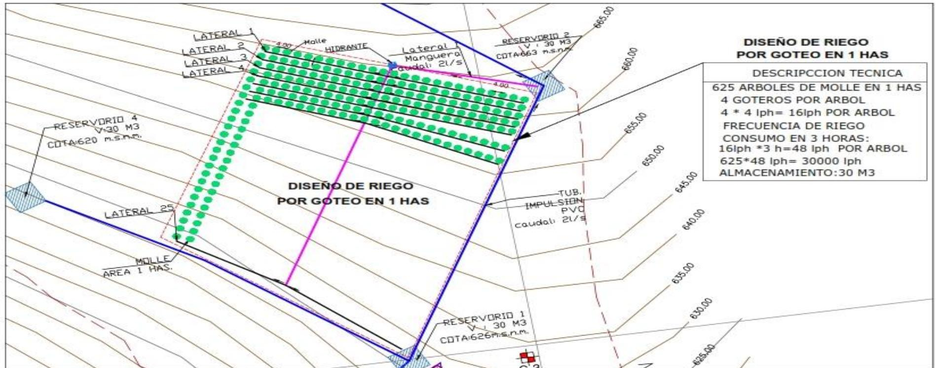
Figura 43: Esquema de riego por goteo
