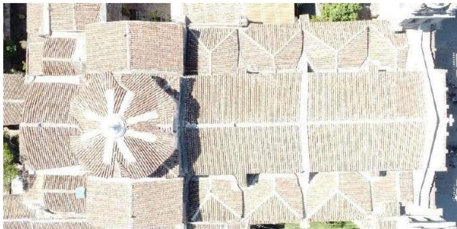
**CUBIERTA A DOS AGUAS CON CÚPULA**
