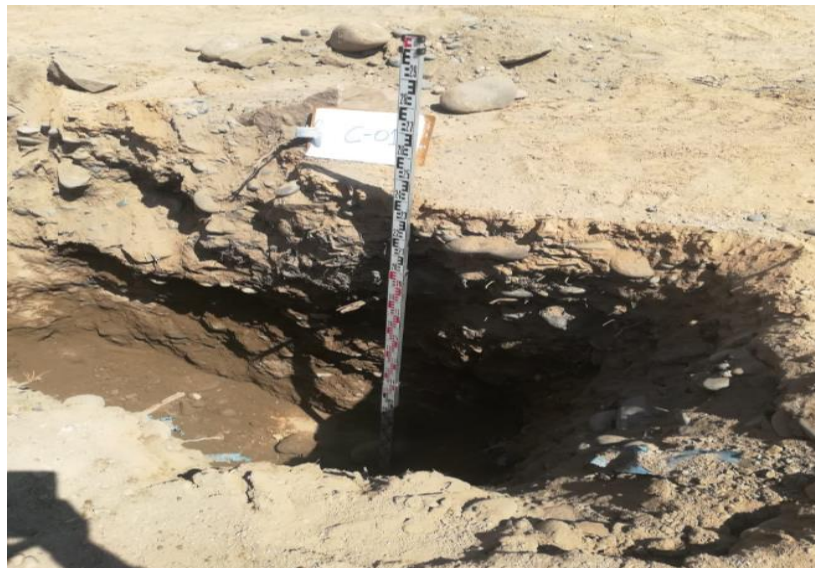
Figura 12- Excavación de calicata 01.
