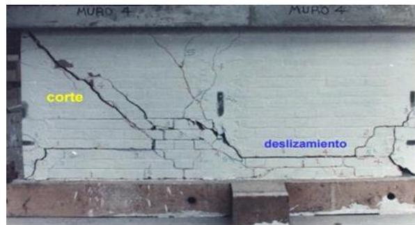
Figura 2. Muro de albañilería confinada, falla por corte que degenera en deslizamiento. Fuente: Diseño estructural de una edificación de albañilería confinada de 8 pisos en la ciudad de Trujillo, Escamilo, J. (2017).
