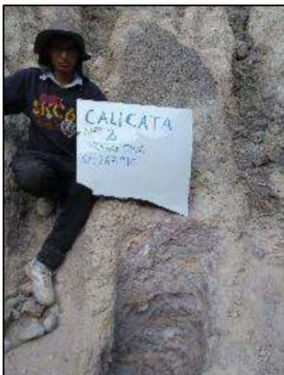
Fotografía 6. Se visualiza la calicata N°2, en el Km 167+930. Donde se realizó la extracción de muestras para estudio en el laboratorio
