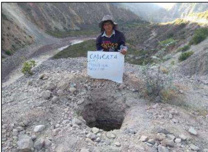
Fotografía 5. Se visualiza la calicata N°1, en el Km 167+880. Donde se realizó la extracción de muestras para estudio en el laboratorio.
