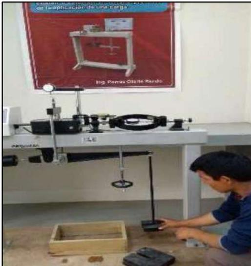
Fotografía 9. Se visualiza la realización del ensayo de corte directo.
