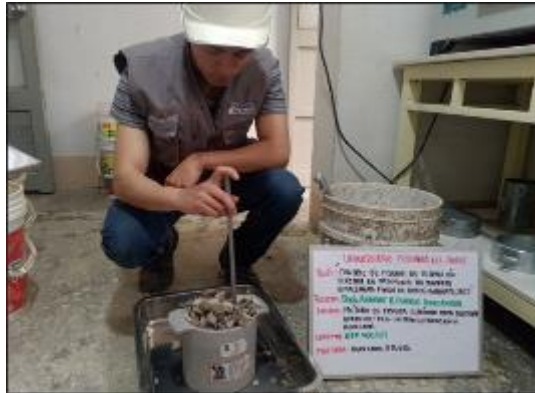
Figura 4.10: Método de prueba para determinar la masa por unidad de volumen
