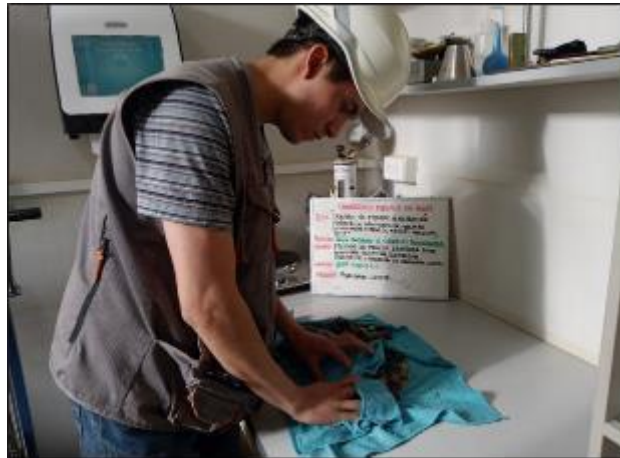
Figura4.11: Determinación de la densidad relativa (peso específico)
