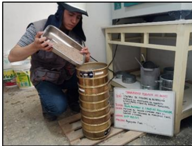
Figura4.9: Análisis granulométrico del agregado fino y grueso
