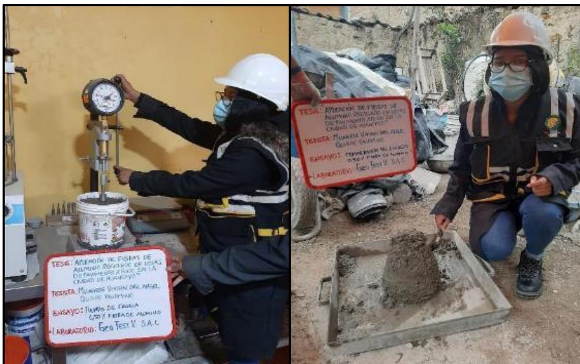
**Fotografía 78, Fotografía 79:** Medición de las propiedades en estado fresco del concreto del GE<sub>4</sub> tales como tiempo de fragua y temperatura, según NTP 339.082. y 339.184. respectivamente.
