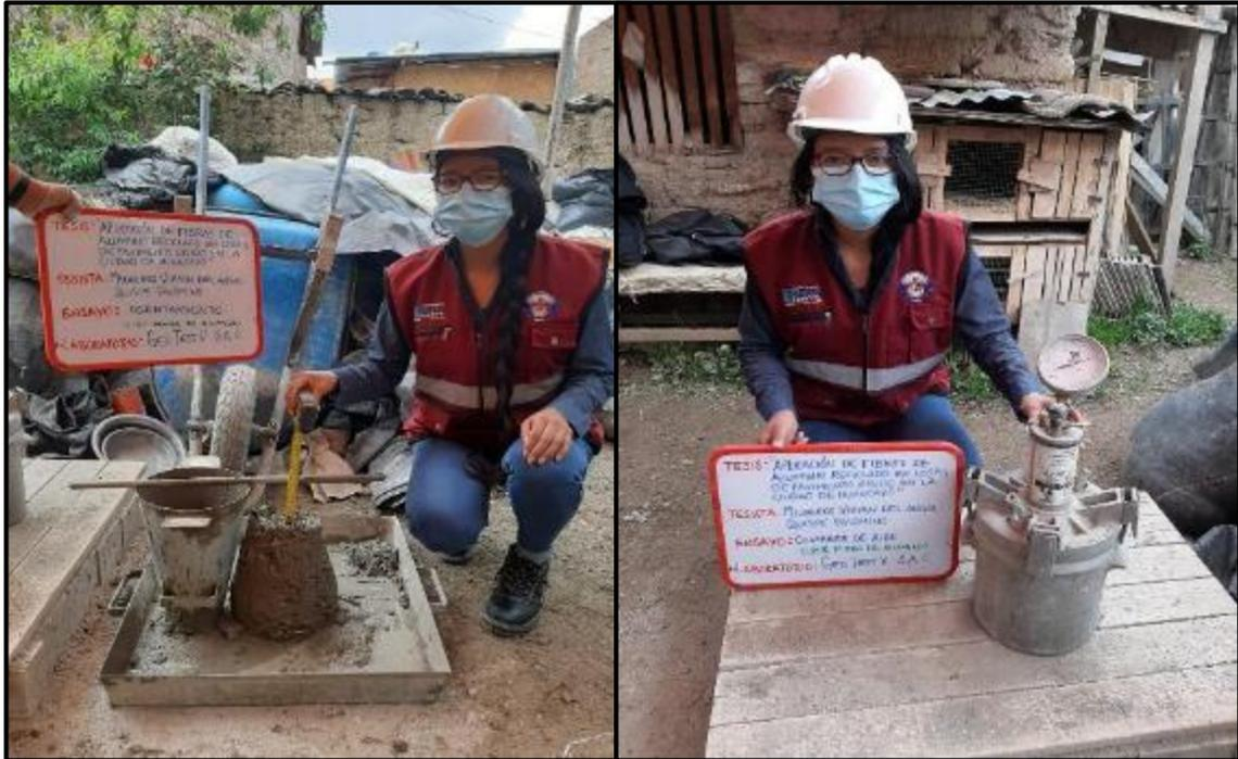
**Fotografía 40, Fotografía 41:** Medición de las propiedades en estado fresco del concreto del GE<sub>1</sub> tales como asentamiento y contenido de aire, según NTP 339.0.35. y 339.083 respectivamente.
