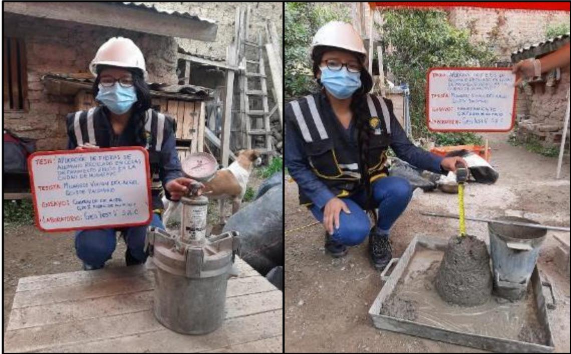
**Fotografía 52, Fotografía 53:** Medición de las propiedades en estado fresco del concreto del GE<sub>2</sub> tales como asentamiento y contenido de aire, según NTP 339.0.35. y 339.083 respectivamente.
