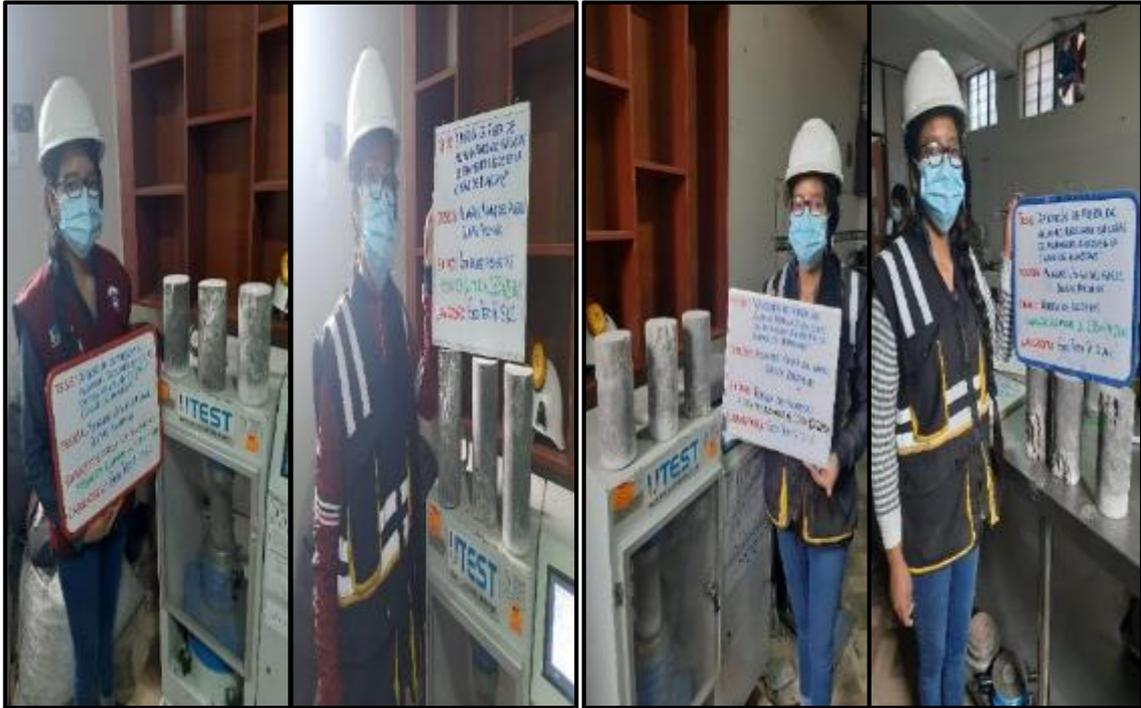
**Fotografía 68, Fotografía 69:** Medición de las propiedades en estado endurecido del concreto del GE<sub>3</sub> tales como resistencia a la compresión a los 7, 14, 21 y 28 días, según NTP 339.034.
