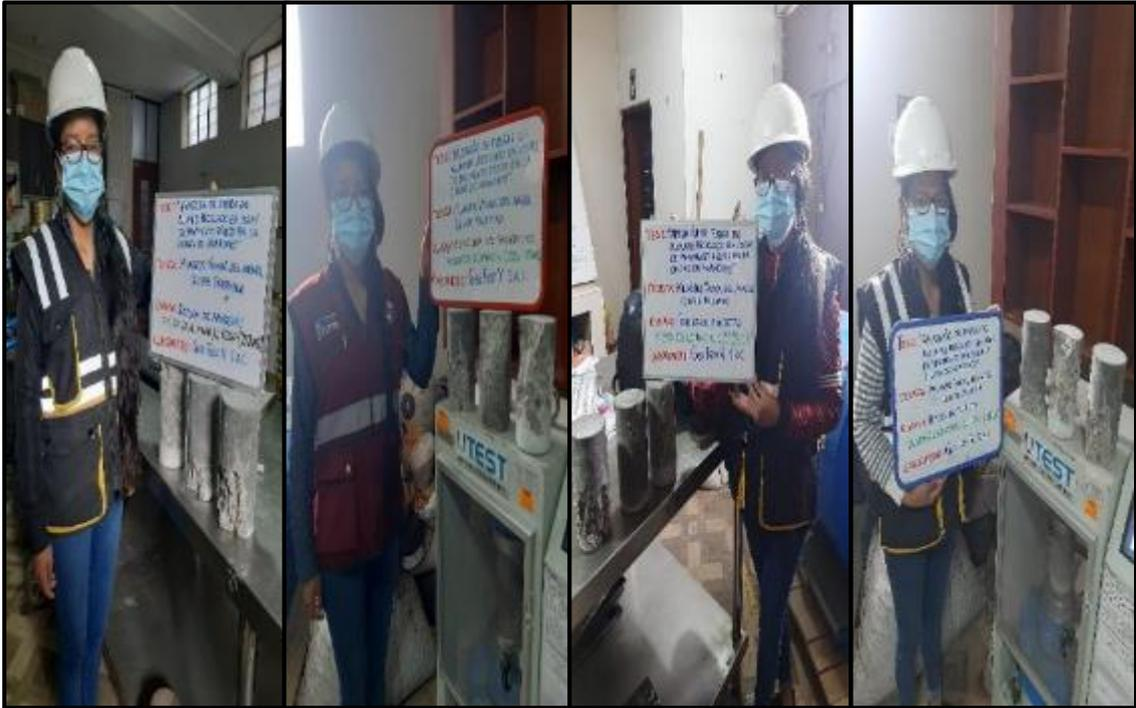
**Fotografía 56, Fotografía 57:** Medición de las propiedades en estado endurecido del concreto del GE<sub>2</sub> tales como resistencia a la compresión a los 7, 14, 21 y 28 días, según NTP 339.034.
