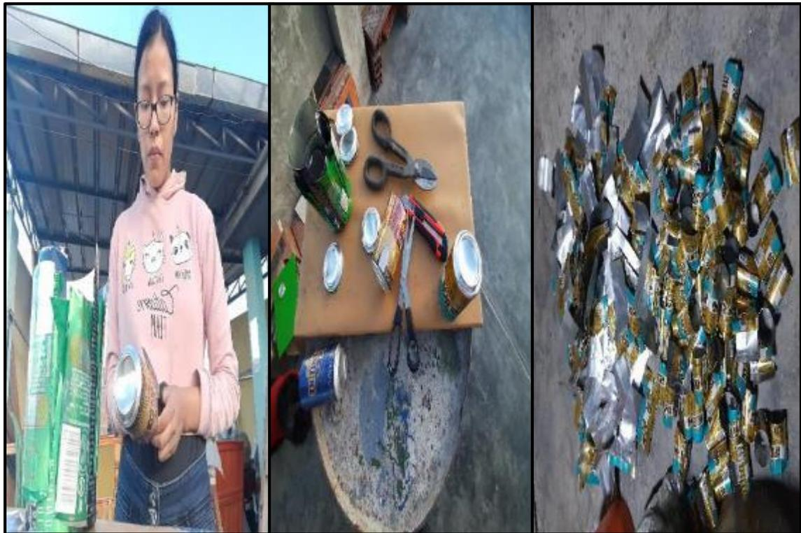
**Fotografía 8, Fotografía 9:** Proceso de extracción de la otra base de las latas de aluminio.
