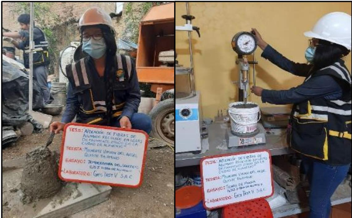
**Fotografía 54, Fotografía 55:** Medición de las propiedades en estado fresco del concreto del GE<sub>2</sub> tales como tiempo de fragua y temperatura, según NTP 339.082. y 339.184. respectivamente.
