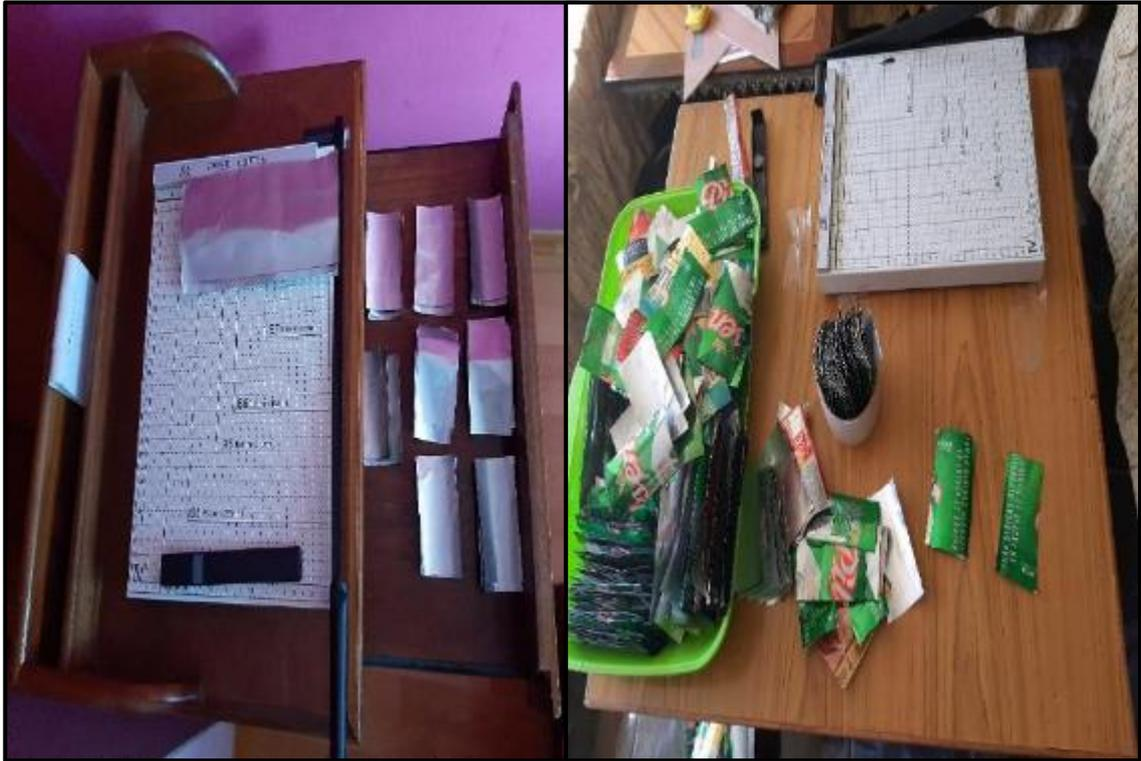
**Fotografía 10, Fotografía 11:** Obtención de láminas de las latas de aluminio de 50 mm de ancho.
