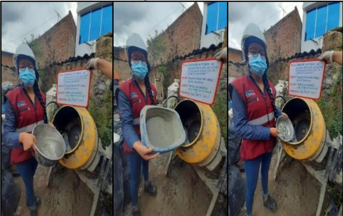
**Fotografía 38, Fotografía 39:** Incorporación de materiales tales como cemento, agua y fibra de aluminio reciclado para la elaboración del concreto del GE<sub>1</sub>. Según NTP 339.183.
