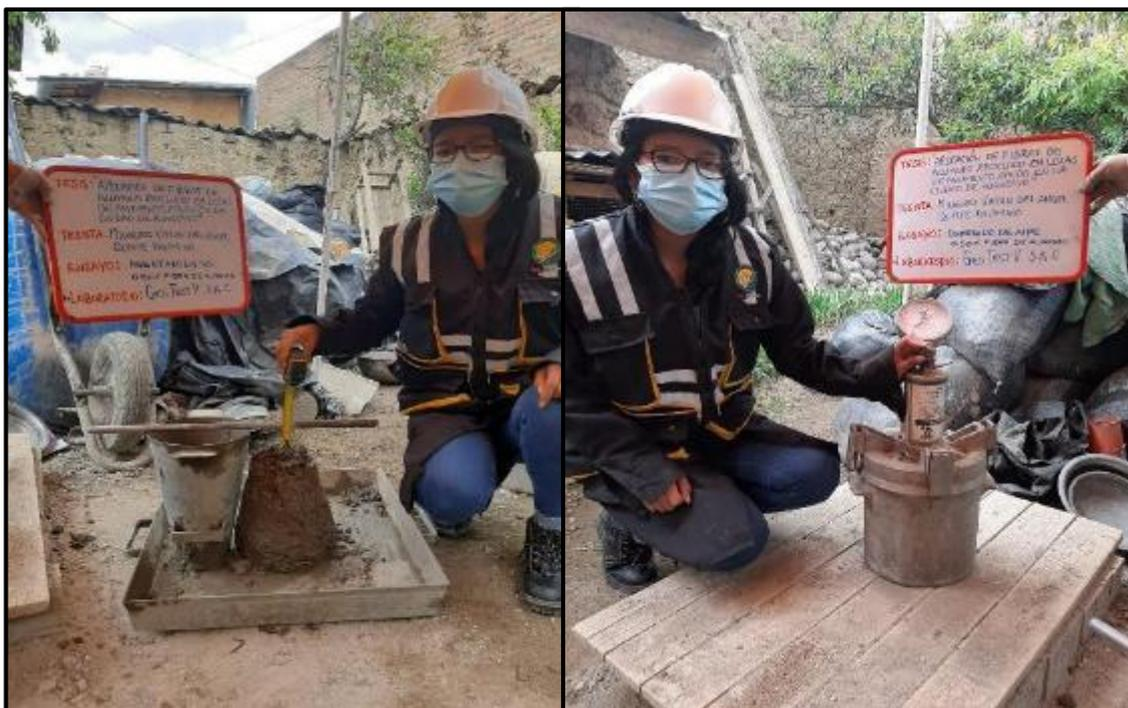
**Fotografía 76, Fotografía 77:** Medición de las propiedades en estado fresco del concreto del GE<sub>4</sub> tales como asentamiento y contenido de aire, según NTP 339.0.35. y 339.083 respectivamente.
