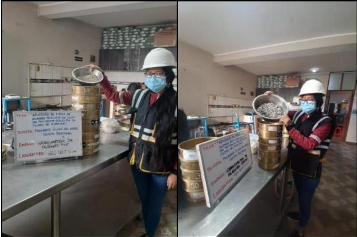
**Fotografía 14, Fotografía 15:** Ensayo de análisis granulométrico del agregado fino y grueso. Según NTP 400.012.
