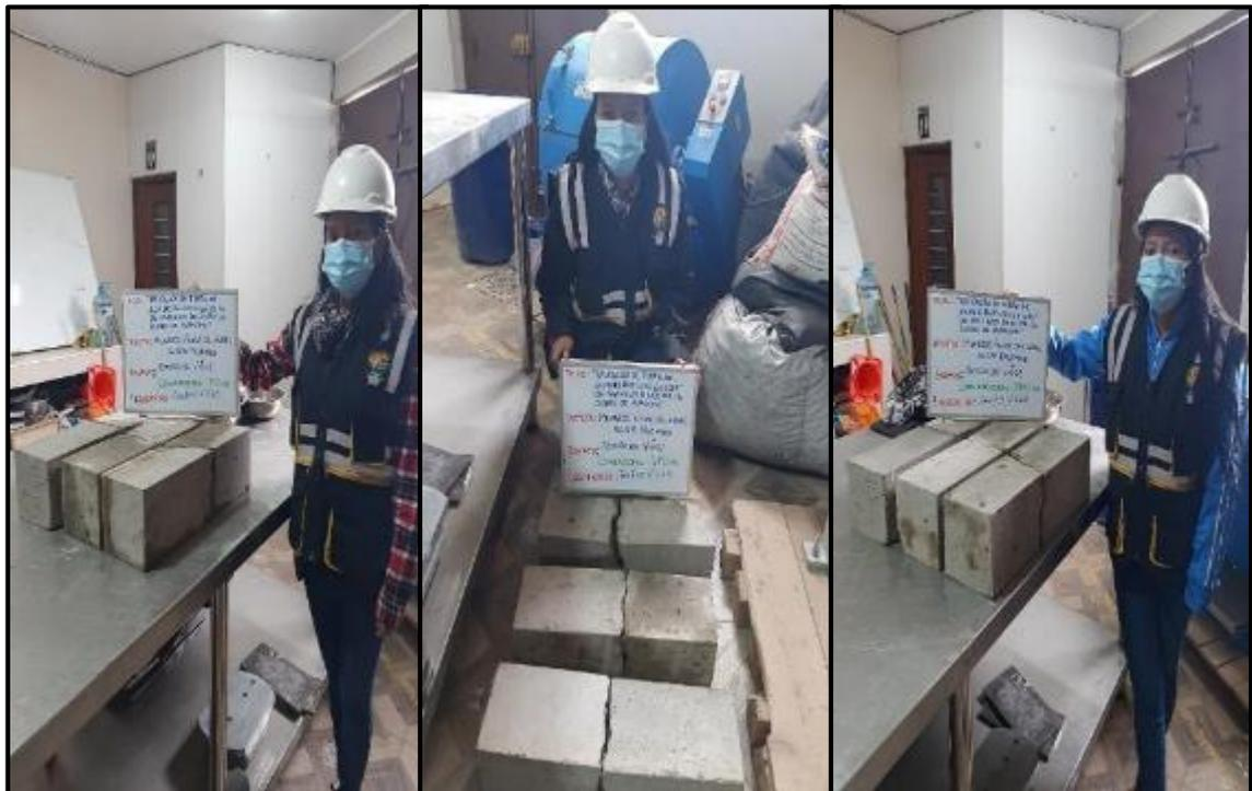
**Fotografía 34, Fotografía 35:** Medición de las propiedades en estado endurecido del concreto tales como resistencia a la flexión a los 7, 14, 21 y 28 días, según NTP 339.078.
