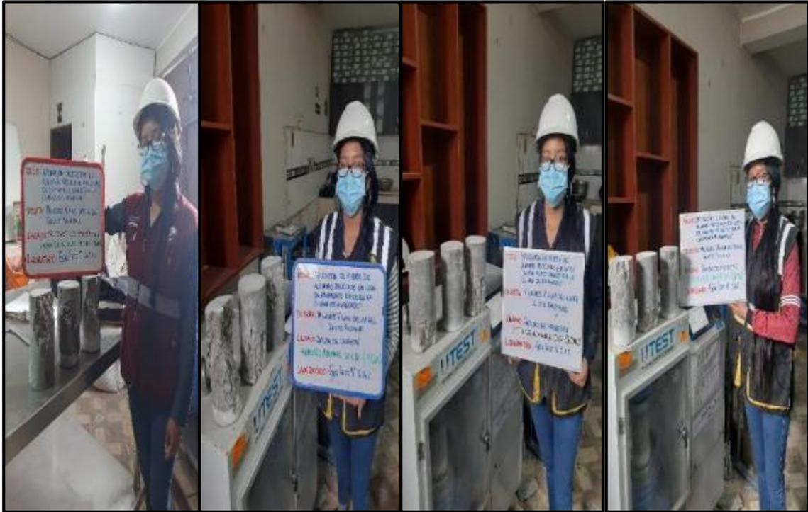
**Fotografía 44, Fotografía 45:** Medición de las propiedades en estado endurecido del concreto del GE<sub>1</sub> tales como resistencia a la compresión a los 7, 14, 21 y 28 días, según NTP 339.034.
