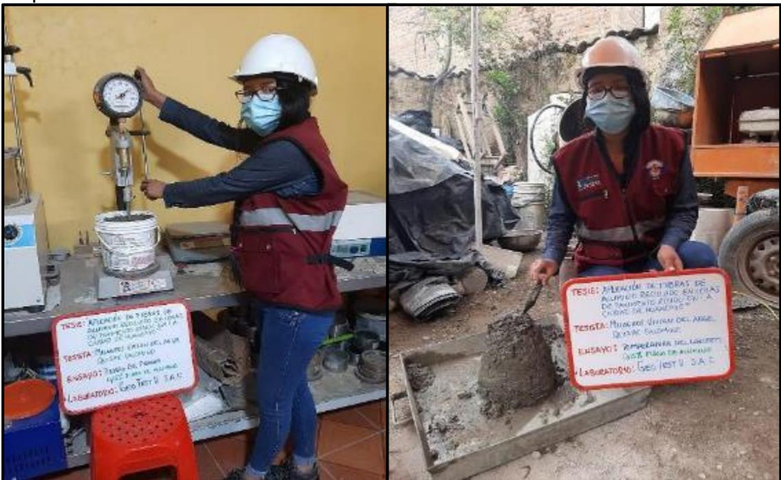
**Fotografía 42, Fotografía 43:** Medición de las propiedades en estado fresco del concreto del GE<sub>1</sub> tales como tiempo de fragua y temperatura, según NTP 339.082. y 339.184. respectivamente.
