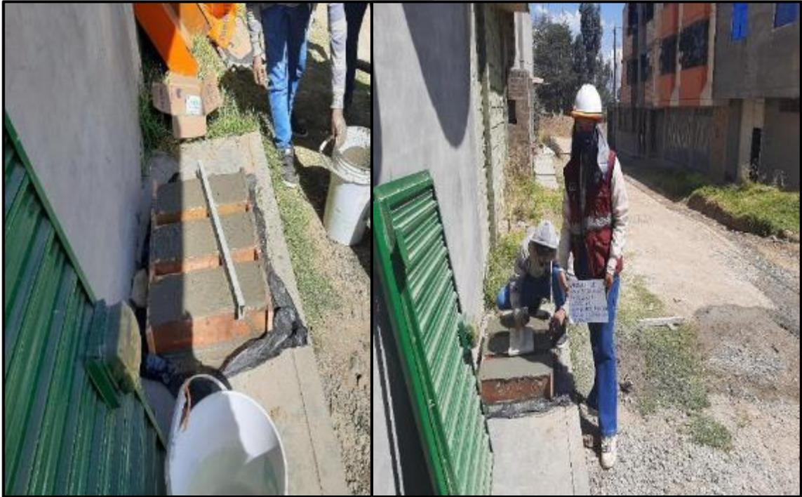
**Fotografía 88:** Extracción de vigas de concreto para corroborar su resistencia a flexión del tramo de prueba de losa de pavimento rígido con una mezcla de concreto correspondiente al GE<sub>1</sub>.
