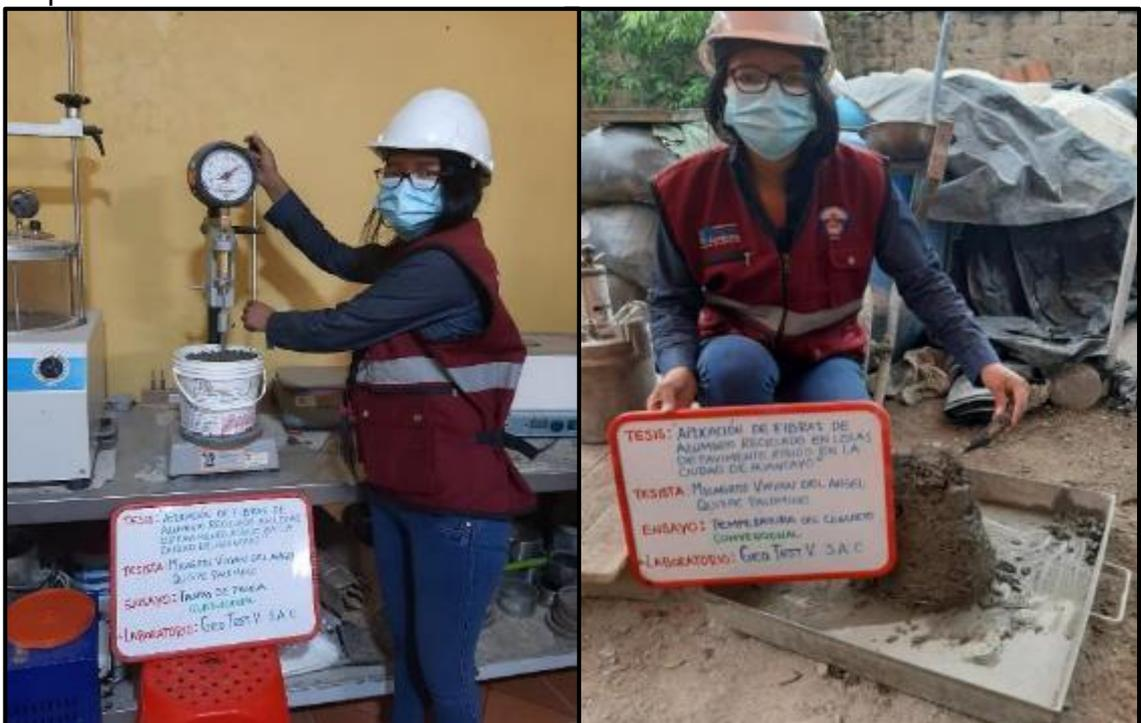
**Fotografía 30, Fotografía 31:** Medición de las propiedades en estado fresco del concreto tales como tiempo de fragua y temperatura, según NTP 339.082. y 339.184. respectivamente.
