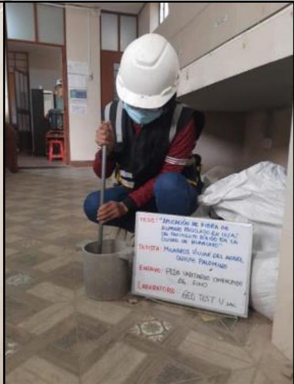
**Fotografía 18, Fotografía 19:** Ensayo de peso unitario y cantidad de vacíos del agregado fino. Según la NTP 400.017.
