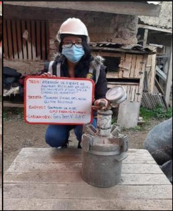
**Fotografía 64, Fotografía 65:** Medición de las propiedades en estado fresco del concreto del GE<sub>3</sub> tales como asentamiento y contenido de aire, según NTP 339.0.35. y 339.083 respectivamente.
