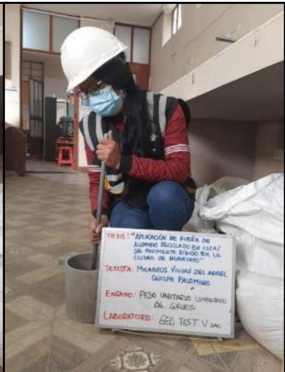
**Fotografía 20, Fotografía 21:** Ensayo de peso unitario y cantidad de vacíos del agregado grueso. Según la NTP 400.017
