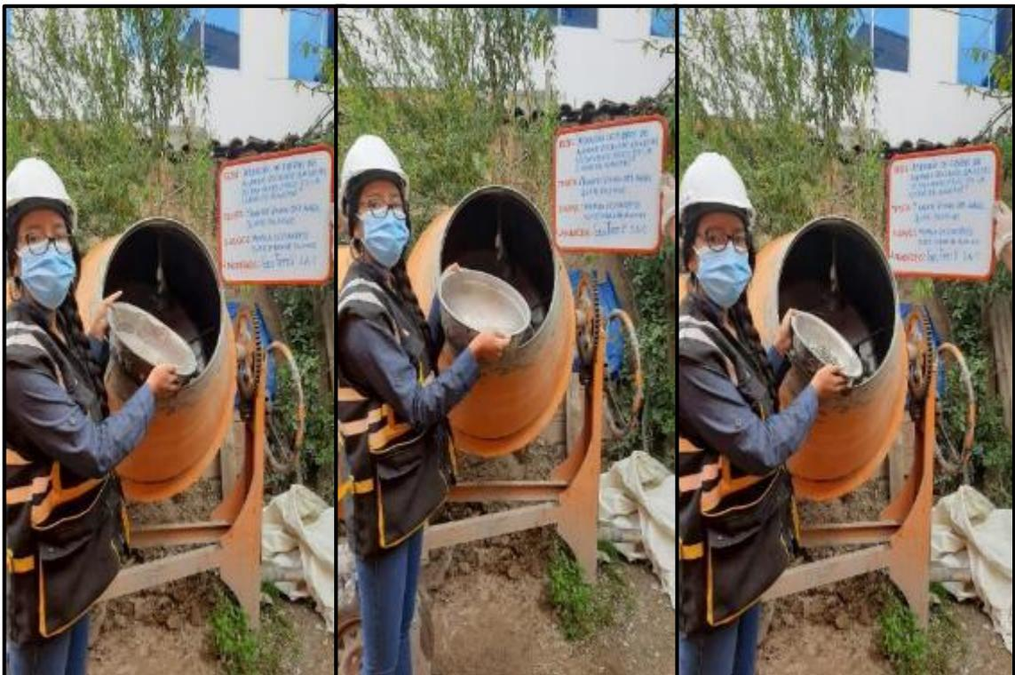
**Fotografía 50, Fotografía 51:** Incorporación de materiales tales como cemento, agua y fibra de aluminio reciclado para la elaboración del concreto del GE<sub>2</sub>. Según NTP 339.183.
