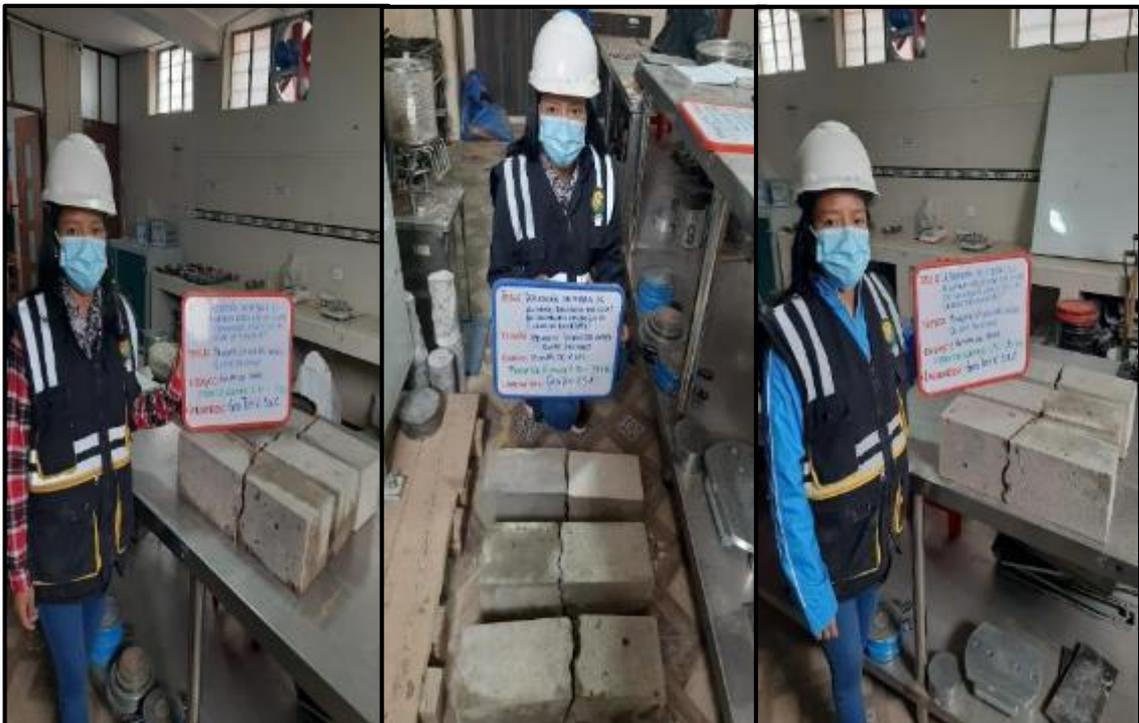
**Fotografía 46, Fotografía 47:** Medición de las propiedades en estado endurecido del concreto del GE<sub>1</sub> tales como resistencia a la flexión a los 7, 14, 21 y 28 días, según NTP 339.078.
