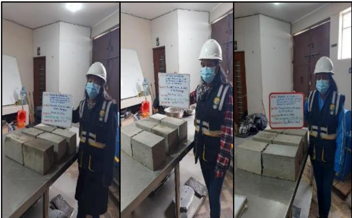
**Fotografía 70, Fotografía 71:** Medición de las propiedades en estado endurecido del concreto del GE<sub>3</sub> tales como resistencia a la flexión a los 7, 14, 21 y 28 días, según NTP 339.078.
