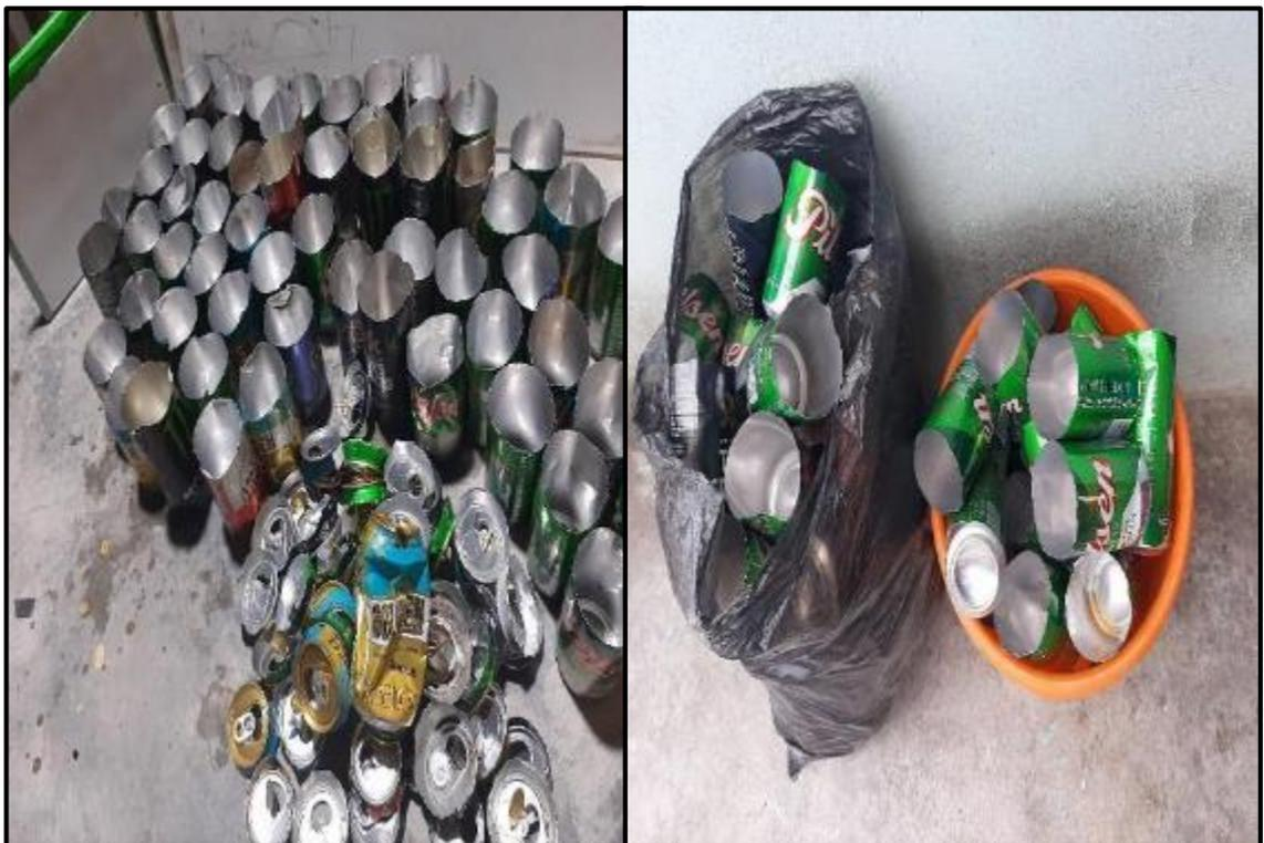
**Fotografía 4, Fotografía 5:** Extracción de una de las bases de las latas de aluminio.
