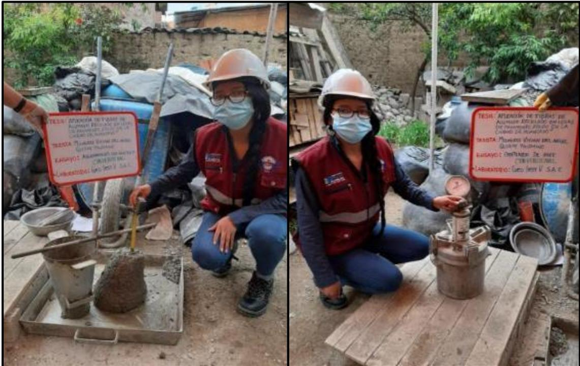
**Fotografía 28, Fotografía 29:** Medición de las propiedades en estado fresco del concreto tales como asentamiento y contenido de aire, según NTP 339.0.35. y 339.083 respectivamente.
