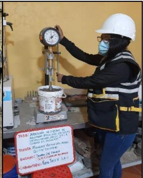
**Fotografía 66, Fotografía 67:** Medición de las propiedades en estado fresco del concreto del GE<sub>3</sub> tales como tiempo de fragua y temperatura, según NTP 339.082. y 339.184. respectivamente.
