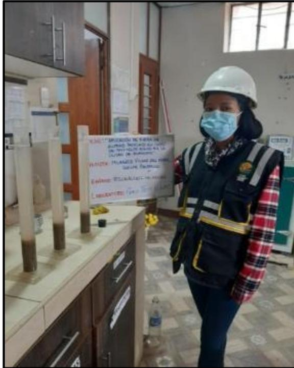
**Fotografía 22:** Ensayo de equivalente de arena o proporción relativa del contenido de polvo fino nocivo, en los suelos o agregados finos. Según NTP 339.146.
