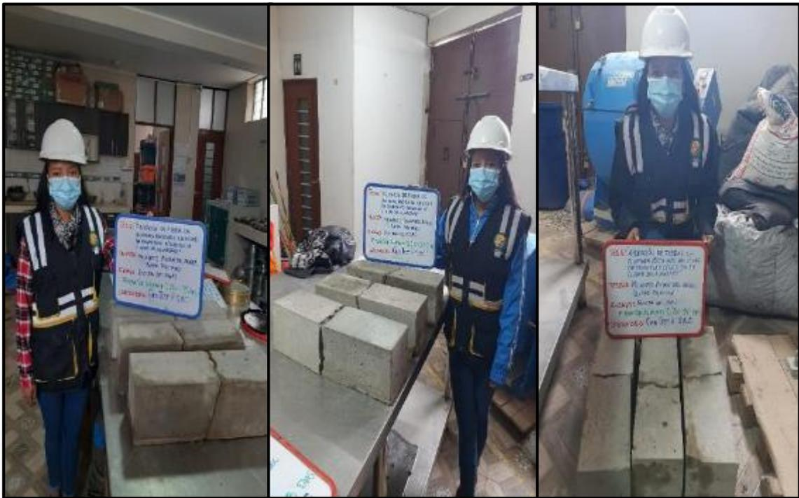
**Fotografía 58, Fotografía 59:** Medición de las propiedades en estado endurecido del concreto del GE<sub>2</sub> tales como resistencia a la flexión a los 7, 14, 21 y 28 días, según NTP 339.078.
