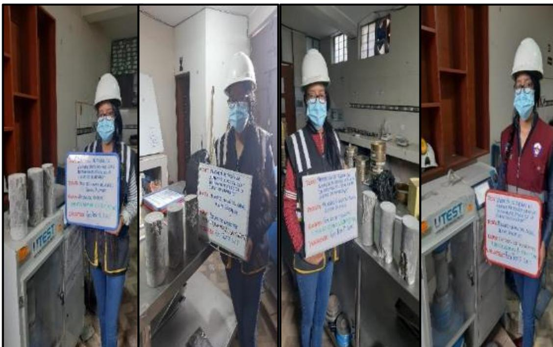
**Fotografía 80, Fotografía 81:** Medición de las propiedades en estado endurecido del concreto del GE<sub>4</sub> tales como resistencia a la compresión a los 7, 14, 21 y 28 días, según NTP 339.034.
