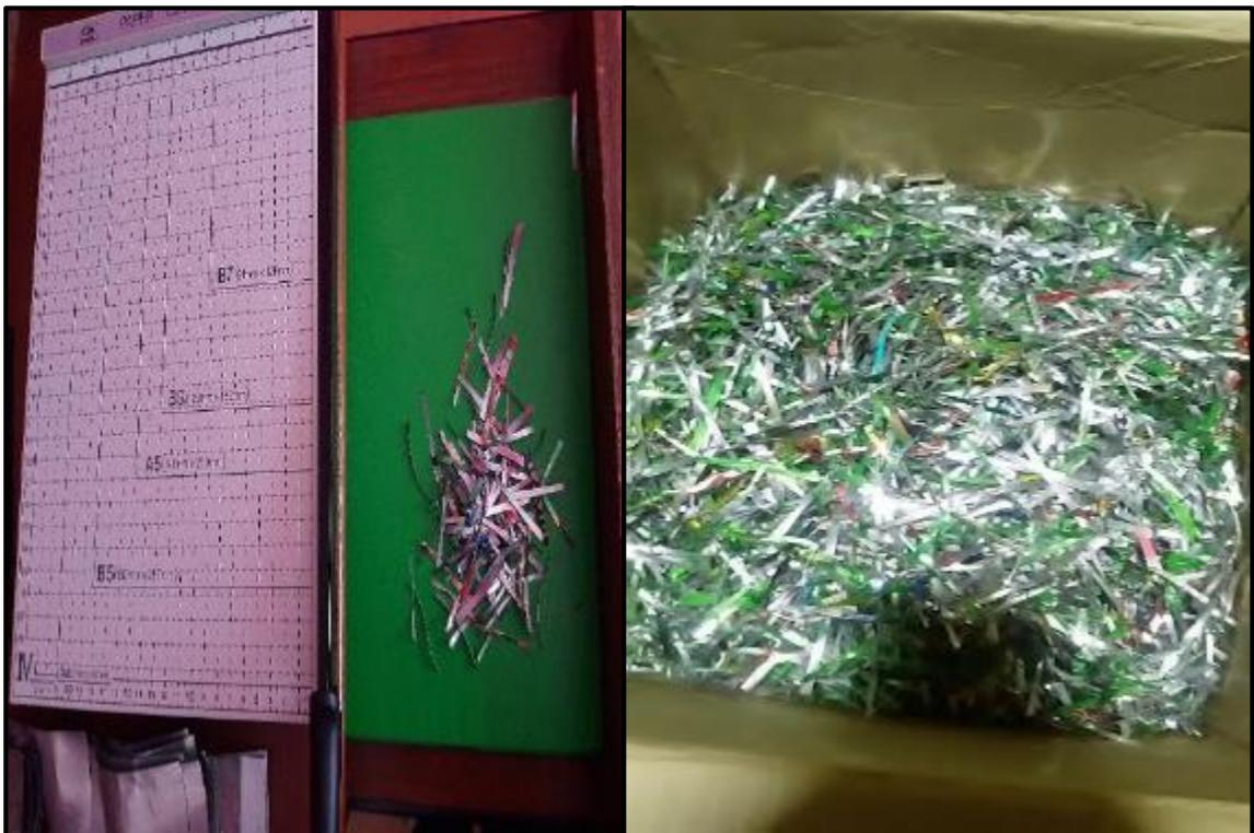
**Fotografía 12, Fotografía 13:** Obtención de láminas de las fibras de aluminio reciclado de 50 mm de largo por 2mm de ancho.
