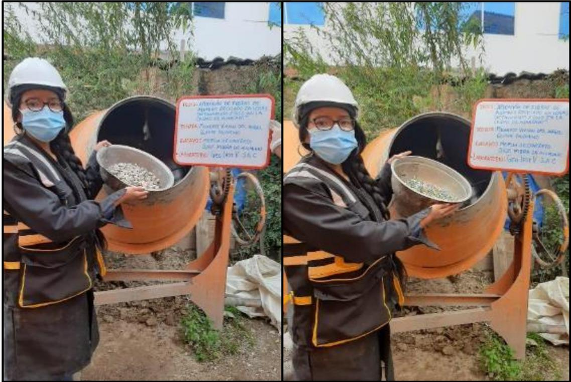
**Fotografía 72, Fotografía 73:** Vista de los agregados incorporados a la mezcla para la elaboración del concreto del GE4. Según NTP 339.183.
