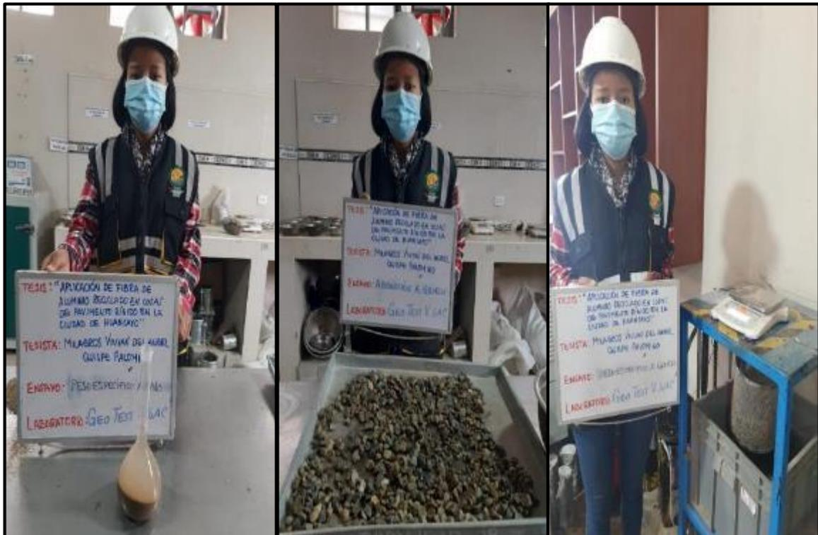
**Fotografía 16, Fotografía 17:** Ensayo normalizado peso específico y absorción del agregado fino y grueso. Según NTP 400.022 y NTP 400.021 respectivamente.
