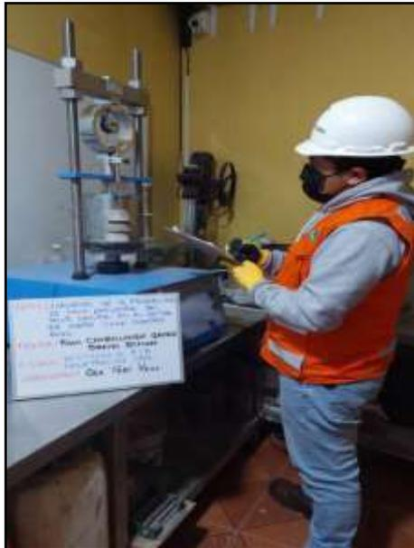
*Fotografía 17:* Ensayo para la determinación de un índice de resistencia del suelo, Lectura de penetración en el dial, 0.025 plg a 0.500 plg convencional. Según la Norma 339.175:2002.
