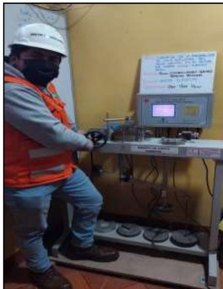
*Fotografía 20:* Es adecuado para determinar las propiedades de las resisten cuas en materiales drenados y consolidados para las trayectorias de drenaje a través de las muestras con cortas; según referencia NTP 339.171:2002.
