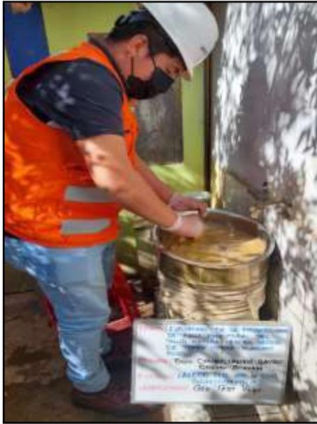
*Fotografía 3:* Ensayo del material más fino que pasa por el tamiz N°200. Según NTP 400.018.
