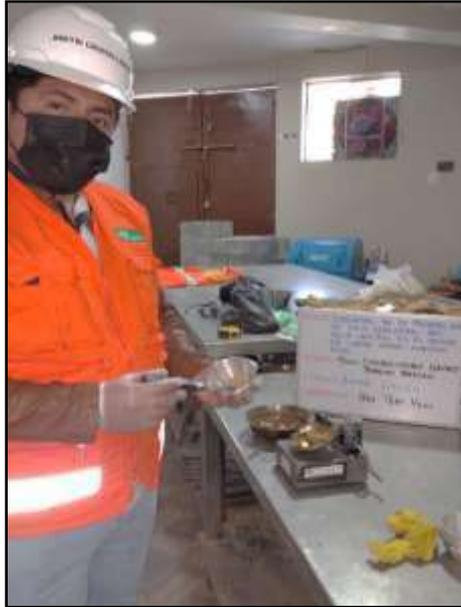
*Fotografía 5:* Registrar el número de golpes, hasta cerrar la ranura, tomando una tajada suelo que aproximadamente y de ancho de la espátula para extenderla, incluyendo la ranura que se deslizo en conjunto, Según la NTP 339.129.
