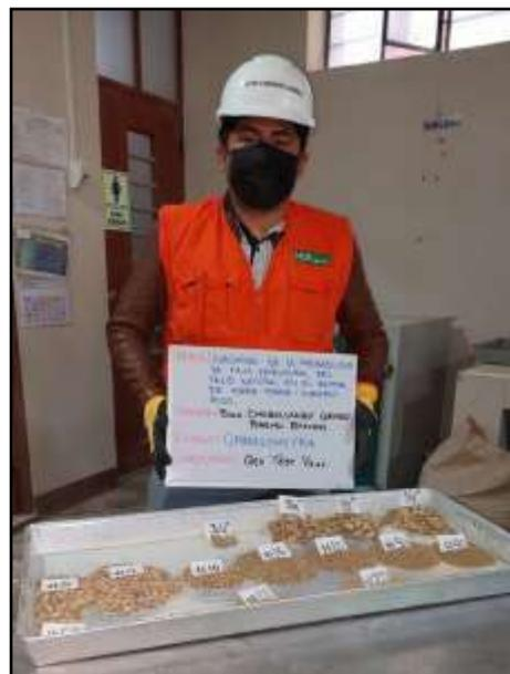
*Fotografía 2:* Ensayo de análisis granulométrico, separación de material por tamaño de partículas método de tamizado Según NTP 339.128
