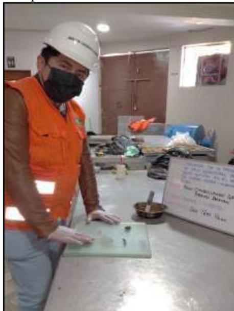
*Fotografía 6:* Las pruebas de contenido de humedad sucesivamente más alto, se registra el límite determinarse y se reportara al suelo como no platico o plástico con pequeños gusanos. Según la NTP 339.129.
