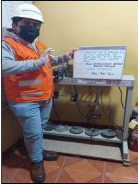
*Fotografía 21:* Los resultados de ensayo son aplicables para estimar la Resistencia al corte en una situación de campo donde tiene lugar a una complete consolidación de esfuerzos; según referencia NTP 339.171:2002.
