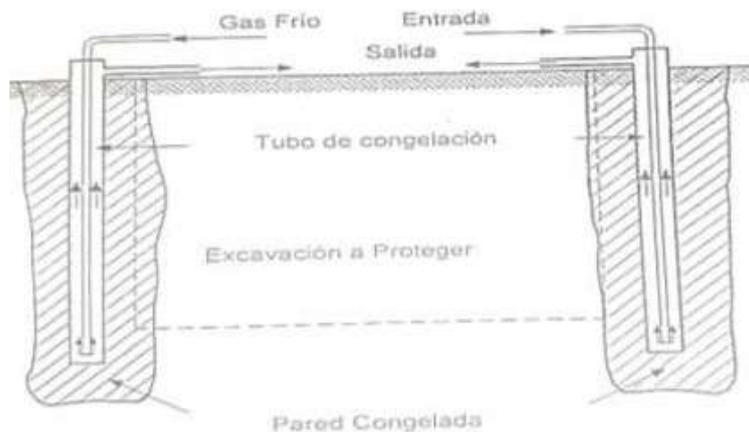
Figura 41. Diagrama de procedimientos de congelación del suelo.
