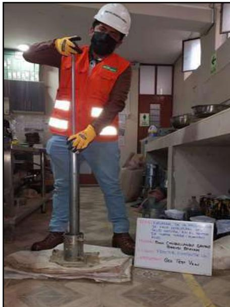
*Fotografía 12:* Apisonamiento del material con adiciones ya mostrados con el molde en 5 capas, en un molde con 56 golpes Según la NTP 339.141.
