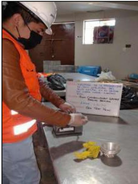
*Fotografía 4:* Ensayo de Limite Líquido con el que se obtiene el contenido de humedad, de clasificación en ingeniería de las fracciones de grano fino de suelos; Según la NTP 339.129.
