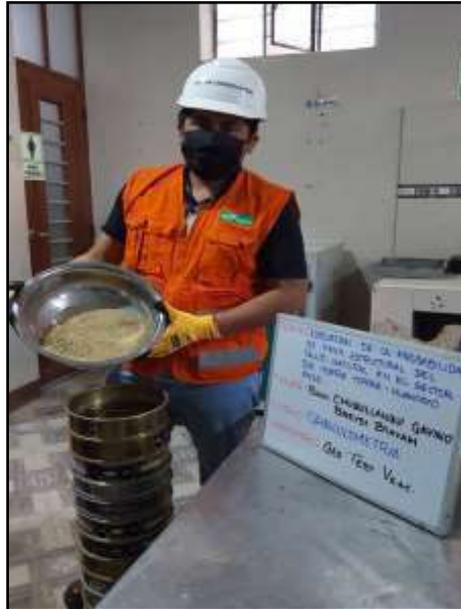
*Fotografía 1:* Ensayo de análisis granulométrico, separación de material por tamaño de partículas método de tamizado Según NTP 339.128
