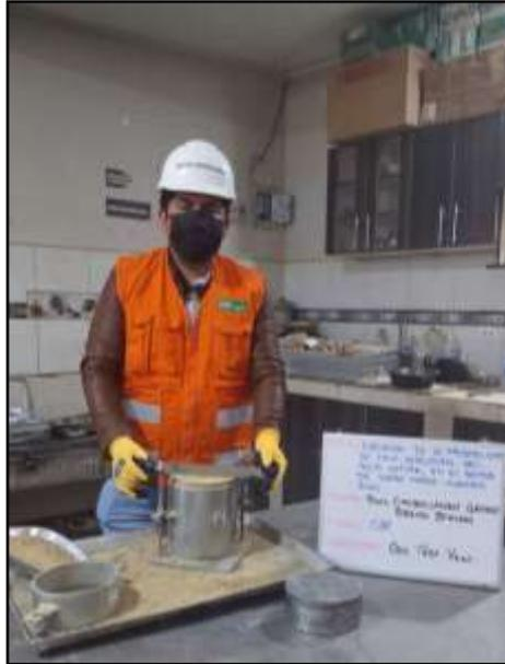
*Fotografía 15:* Enrasado del material dentro del molde en 5 capas, en un molde con 56 golpes, en el segundo molde por 25 golpes y en el tercer molde 12 golpes con condiciones de agua ya expuesto. Según la NTP 339.175:2002.
