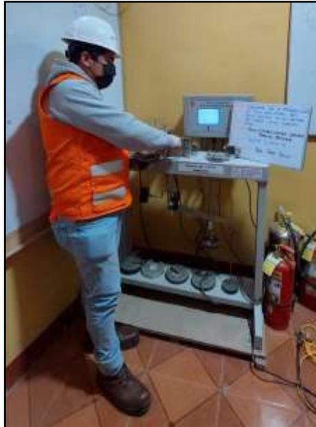
*Fotografía 19:* El objetivo de este ensayo es determinar la Resistencia al corte de la muestra del suelo consolidada y drenada por este método de corte directo; Según la NTP 339.171:2002.
