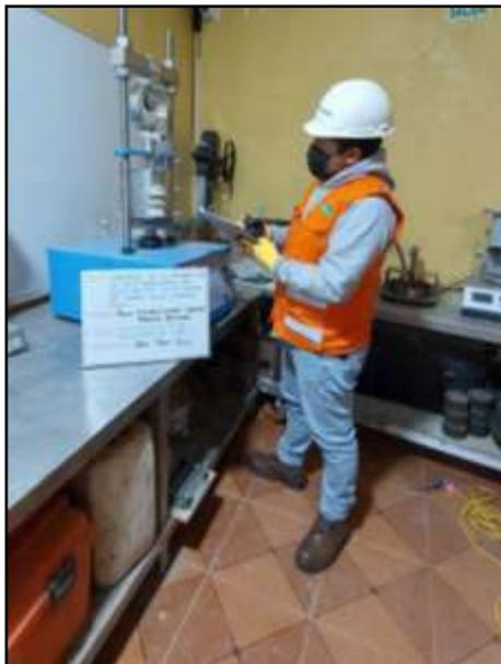
*Fotografía 18:* Ensayo para la determinación de un índice de resistencia del suelo, registro de penetración en el dial, 0.025 plg a 0.500 plg. Según la Norma 339.175:2002.
