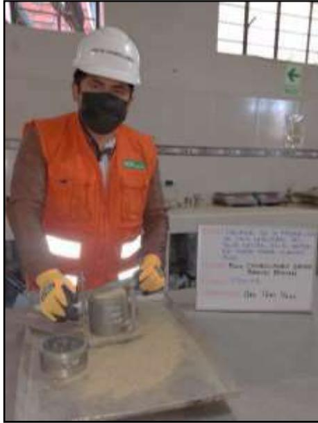
*Fotografía 13:* Remover el material sobrante del molde, para obtener un espécimen del contenido de agua o una porción representativa; Según la NTP 339.141.
