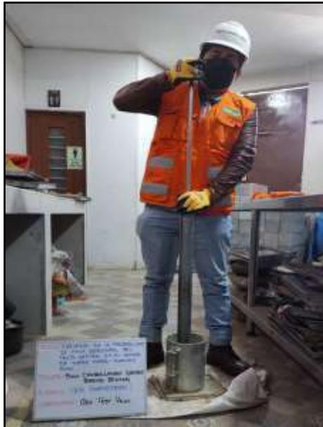
*Fotografía 14:* Apisonamiento del material dentro del molde en 5 capas, en un molde con 56 golpes, en el segundo molde por 25 golpes y en el tercer molde 12 golpes. Según la NTP 339.175:2002.
