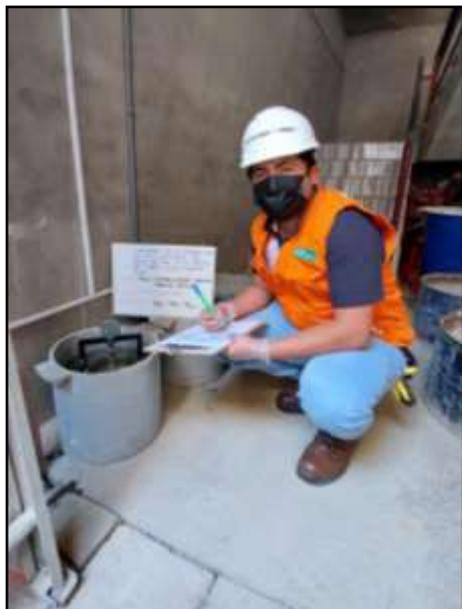
*Fotografía 16:* Sumergido de los moldes por 96 horas siendo medido la expansión cada 24 horas. Según la NTP 339.175:2002.
