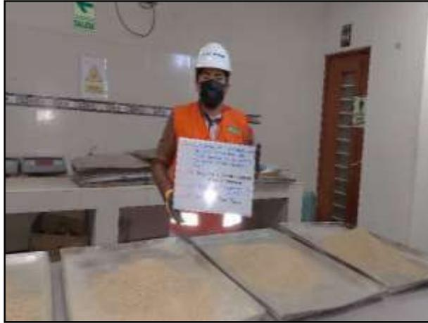
*Fotografía 11:* La muestra serán de 10%, 12%, 14% y 16% de agua sobre la muestra para poder realizar el ensayo; Según la NTP 339.141.
