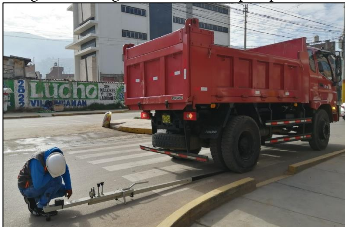
Fotografía 08. Colocación de la viga Benkelman en el punto a evaluar, Prog. 0+000 (ida).
