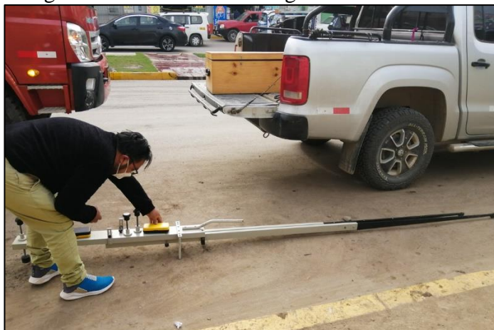
Fotografía 06. Calibración de la viga Benkelman.
