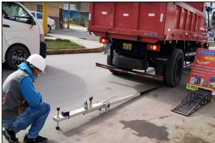
Fotografía 11. Colocación de la viga Benkelman en el punto a evaluar, Prog. 0+700 (ida).
