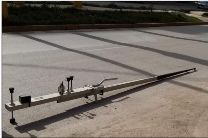
Fotografía 07. Viga Benkelman listo para proceder a la toma de deflexiones.
