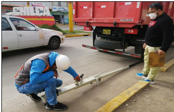
Fotografía 09. Colocación de la viga Benkelman en el punto a evaluar, Prog. 0+300 (ida).
