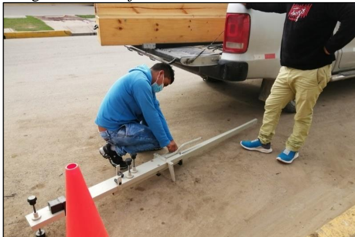
Fotografía 05. Armado de la viga Benkelman.
