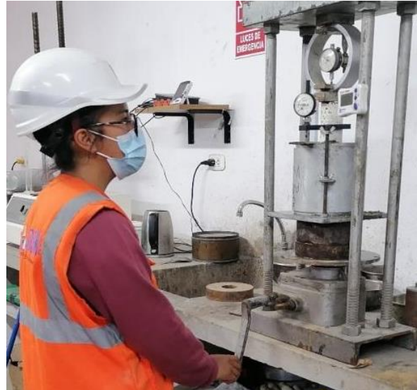
Figura 6.14 Penetracion de CBR
