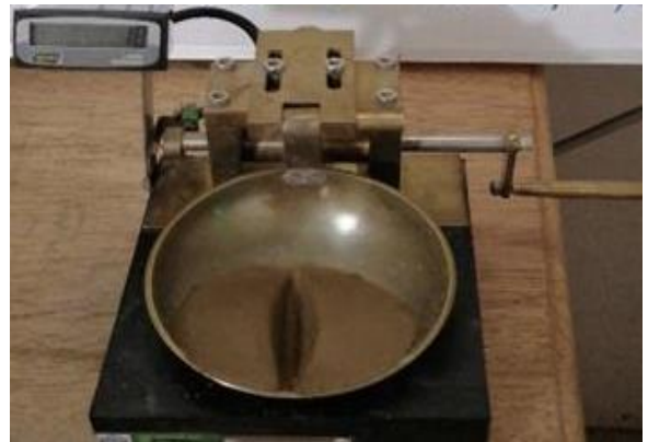
Figura 6.16 Limite Liquido de la calicata 3 a suelo natural
