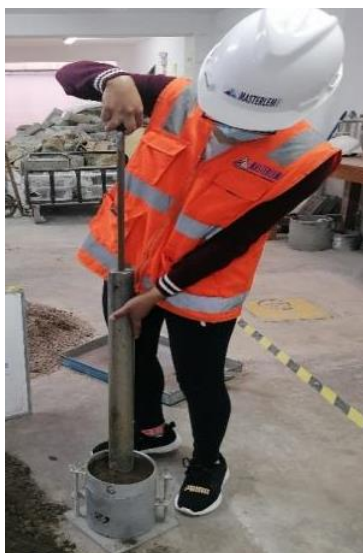
Figura 6. 11 Moldeo de proctor modificado
