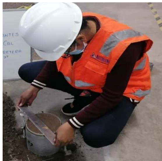
Figura 6. 12 Enrazado de proctor
