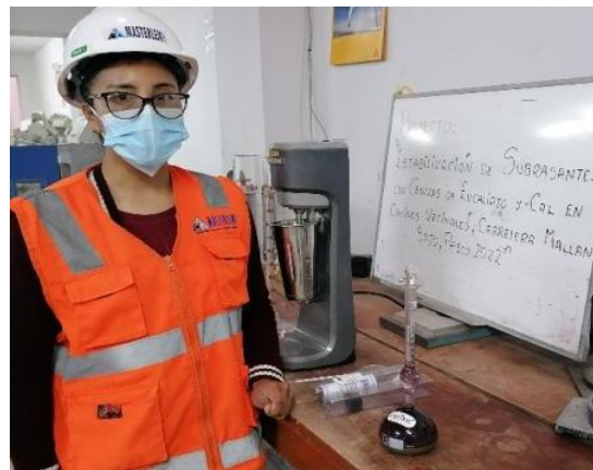
Figura 6. 4 Peso específico de la ceniza de eucalipto
