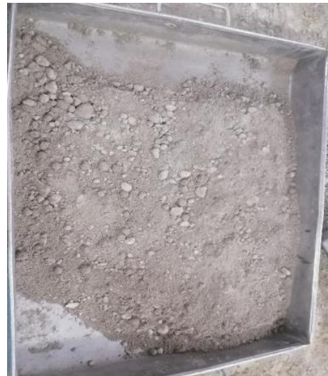
Figura 6. 10 Muestra de suelo natural, cenizas y cal para proctor
