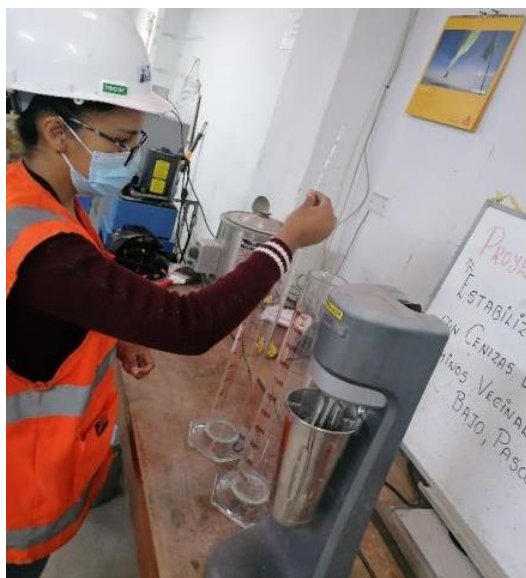
Figura 6. 5 Granulometria de la ceniza de eucalipto por sedimentacion
