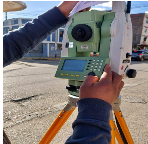
FOTO N° 7: SE OBSERVA EL EQUIPO TOPOGRAFICO QUE SE UTILIZO PARA EL LEVANTAMIENTO TOPOGRAFICO DE LA AV. SAN CARLOS.
