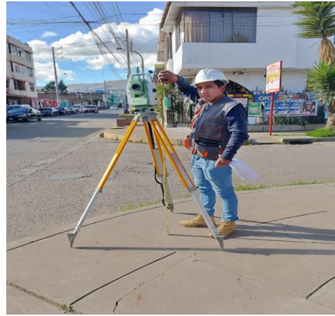
FOTO N° 2: SE OBSERVA EL ESTACIONAMIENTO DE LA ESTACION TOTAL EN EL PUNTO N° 3, PARA EMPEZAR A REALIZAR EL LEVANTAMIENTO RADIAL
