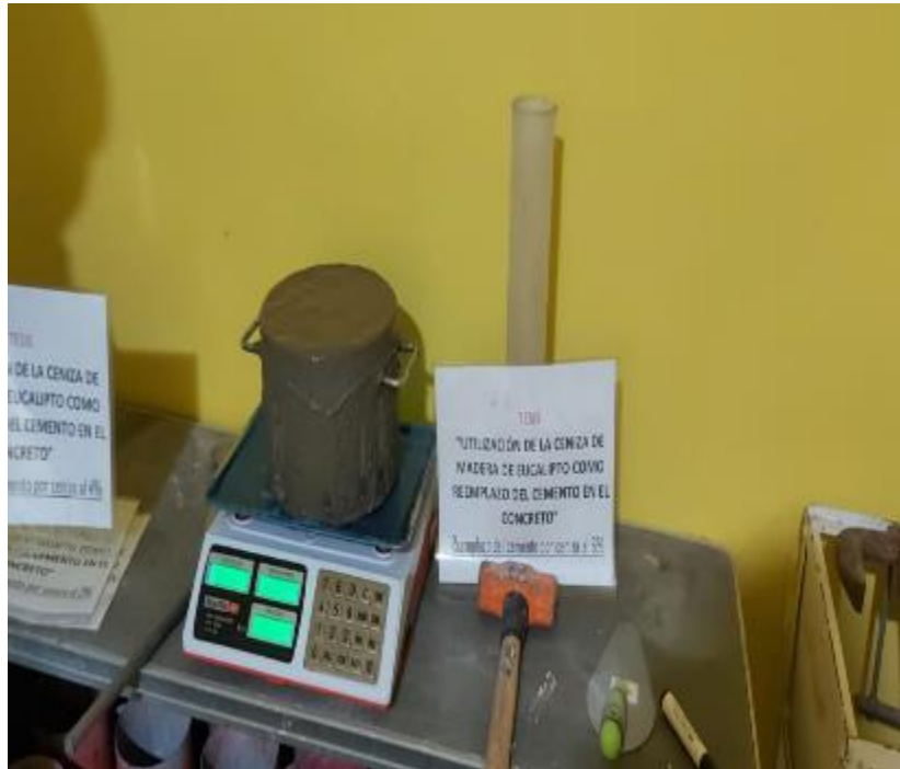
Fotografía 15. Preparación de especímenes de concreto para la medición del peso unitario.
