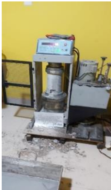
Fotografía 23. Rotura de probeta de concreto con ceniza de madera de eucalipto en reemplazo del cemento a los 21 días.
