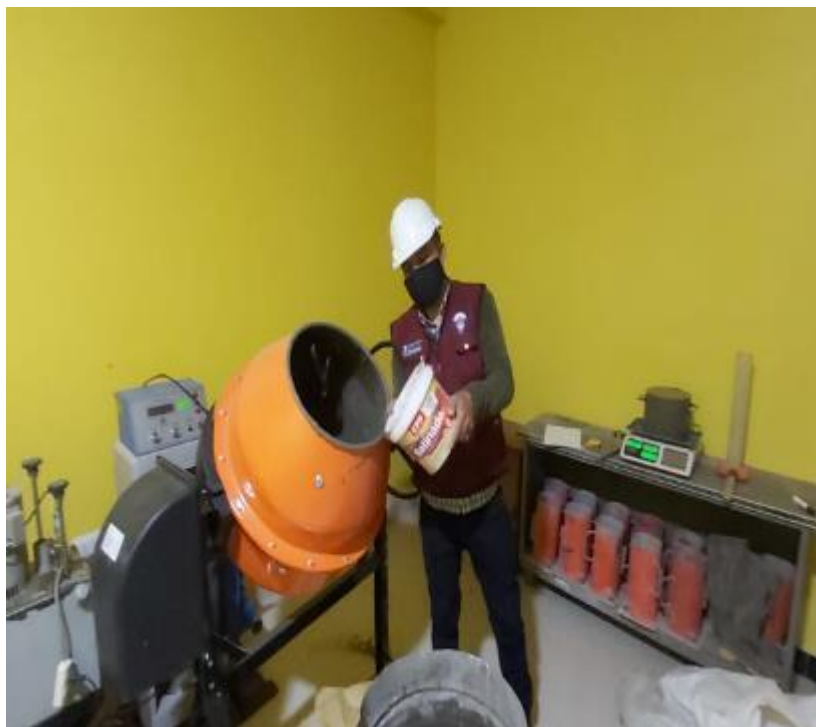
Fotografía 8. Preparación de espécimen para la medición asentamiento.
