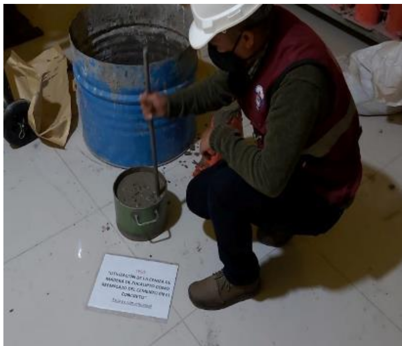
Fotografía 12. Preparación de especímenes de concreto para la medición del peso unitario.
