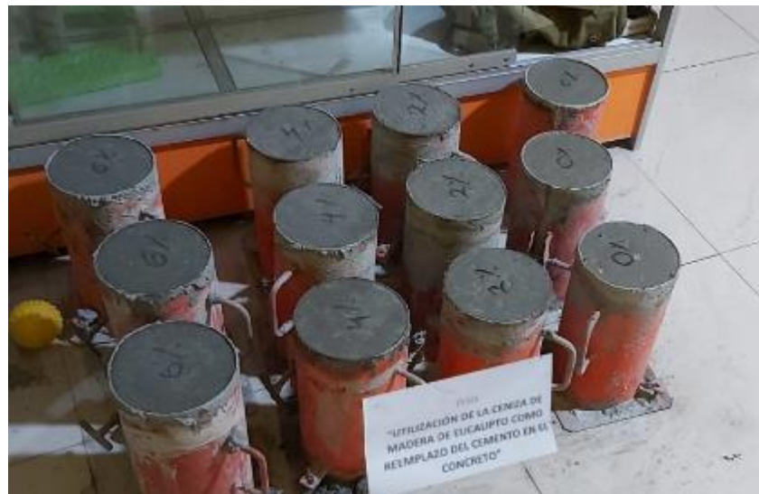
Fotografía 20. Vista de las probetas de concreto convencional y con adiciones de ceniza de eucalipto en reemplazo del cemento al 2%, 4% y 6%.
