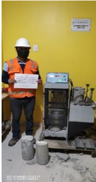
Fotografía 25. Rotura de probeta de concreto con ceniza de madera de eucalipto en reemplazo del cemento.
