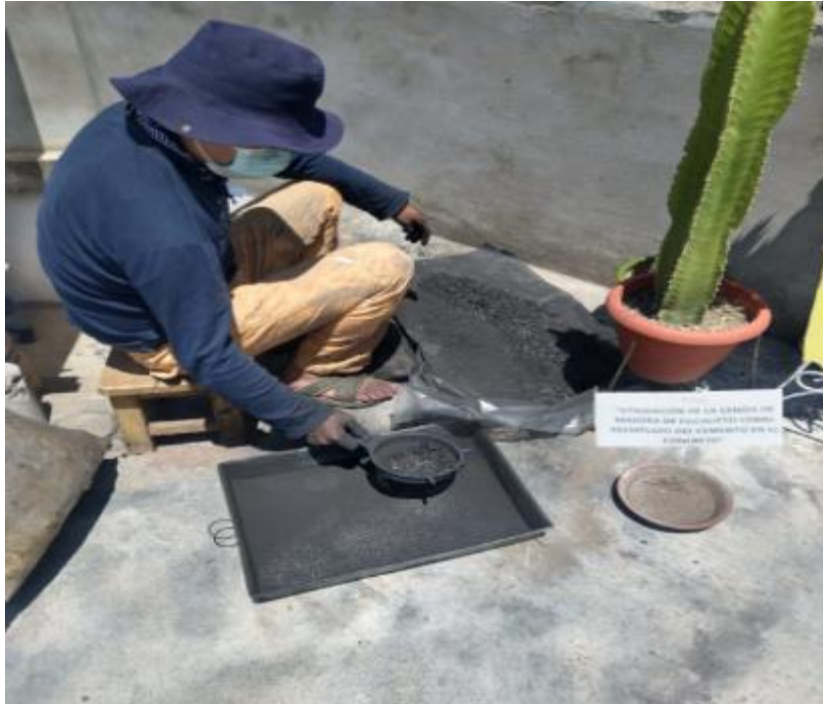
Fotografía 1. Molienda de la ceniza de madera de eucalipto.
