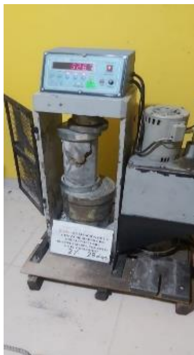
Fotografía 24. Rotura de probeta de concreto con ceniza de madera de eucalipto en reemplazo del cemento a los 28 días.
