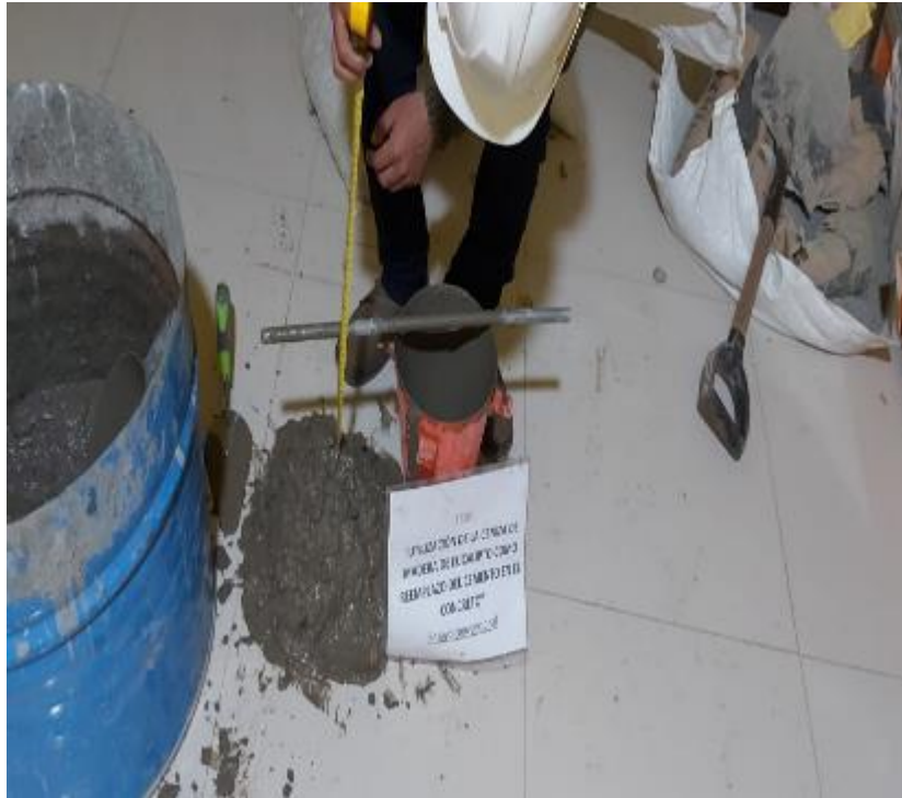
Fotografía 9. Preparación de espécimen para la medición del asentamiento.
