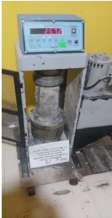
Fotografía 21. Rotura de probeta de concreto con ceniza de madera de eucalipto en reemplazo del cemento a los 7 días.
