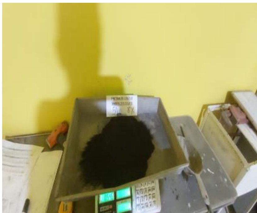
Fotografía 3. Cantidad de ceniza de madera de eucalipto al 4%
