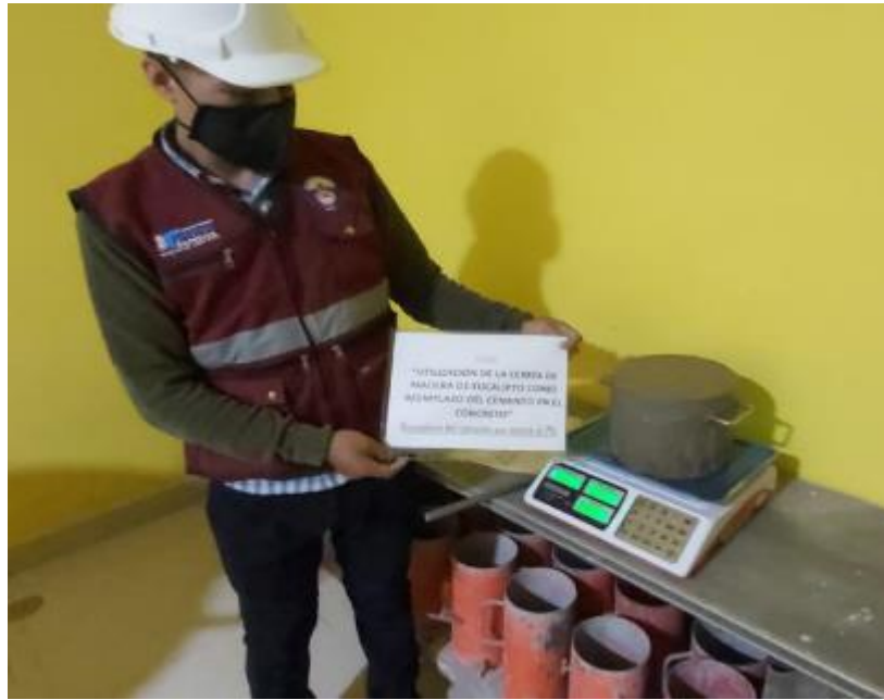
Fotografía 13. Preparación de especímenes de concreto para la medición del peso unitario.
