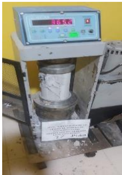
Fotografía 22. Rotura de probeta de concreto con ceniza de madera de eucalipto en reemplazo del cemento a los 14 días.
