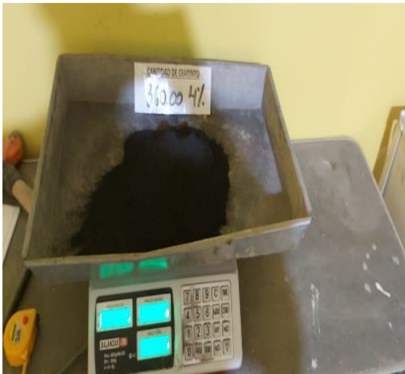
Fotografía 2. Cantidad de ceniza de madera de eucalipto al 2%
