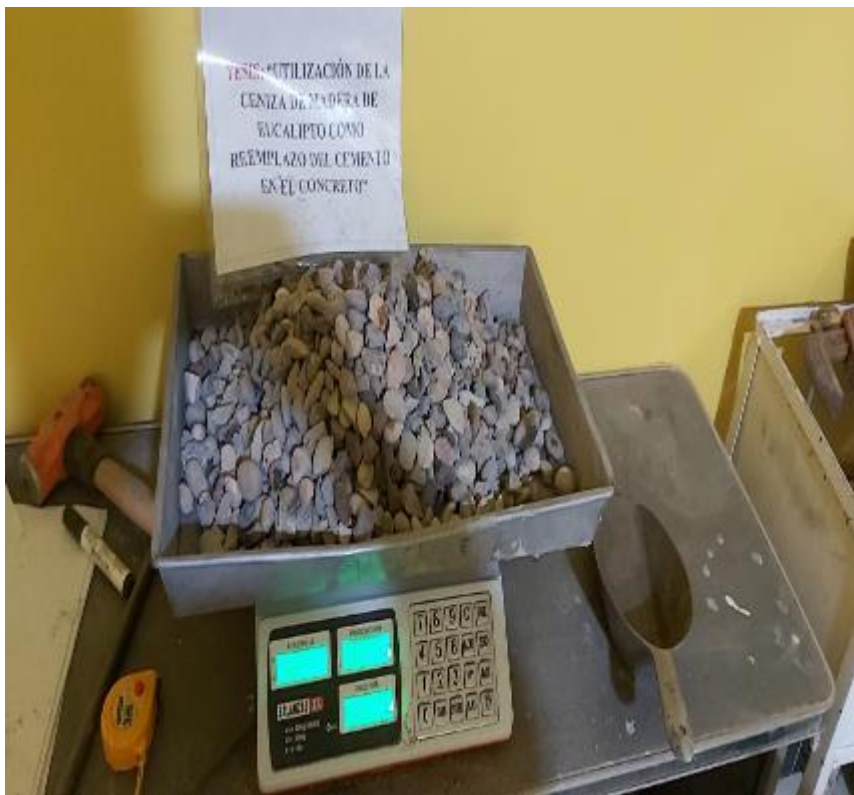
Fotografía 6. Pesado de una muestra del agregado grueso.
