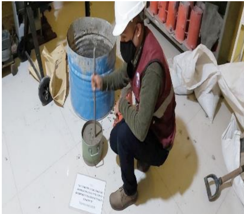
Fotografía 11. Preparación de especímenes de concreto para la medición del peso unitario.
