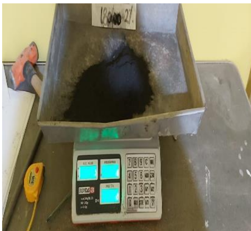
Fotografía 4. Cantidad de ceniza de madera de eucalipto al 6%
