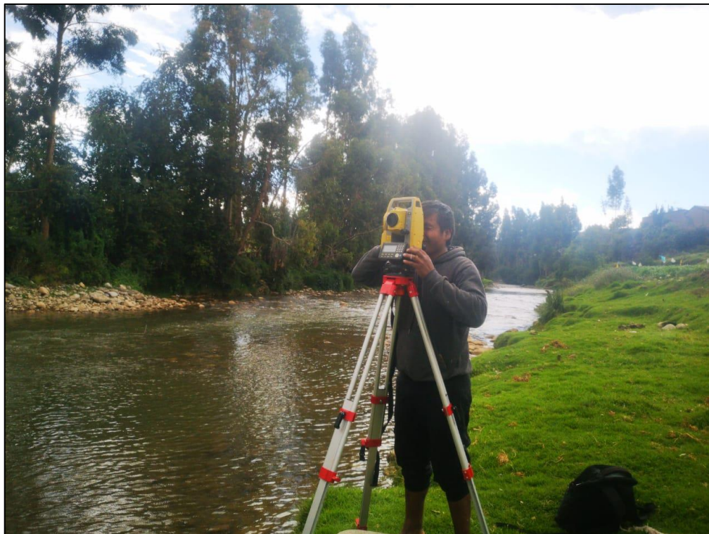
Fotografía 1: Levantamiento topográfico del tramo de 500 m del río Cunas en el Barrio San Miguel de Pincha, Chupaca, Junín.
