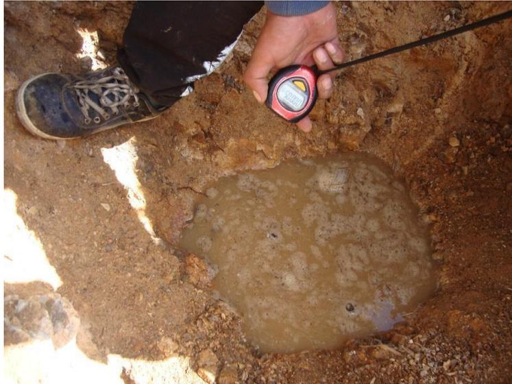
Figura 6. Test de percolación realizada
